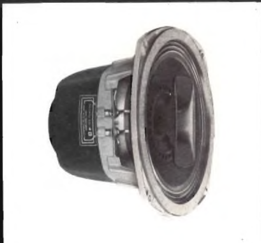
Altoparlante triassiale (modello University 308). Si vedono molto bene il tweeter a tromba ed il cono per le medie frequenze, unito al cono principale per le basse frequenze attraverso un anello flessibile ricavato nella membrana.
