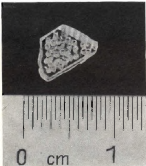
Fig. 3 - Placchetta di diamante di 1,6 mm di spessore tagliata parallelamente al piano (III) dalla quale sono stati ricavati i cilindretti di 0,3 mm di diametro che serviranno alla fabbricazione delle puntine.
