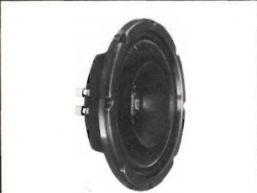
Altoparlante bicono o biassiale (modello University M-8 D). Si notano chiaramente il cono principale per le basse e medie frequenze e quello più piccolo per le alte frequenze.
