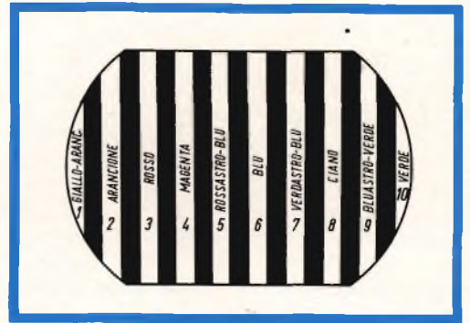
Fig. 7 - Rappresentazione in bianco e nero delle barre del colore sullo schermo del cinescopio tricolore.
