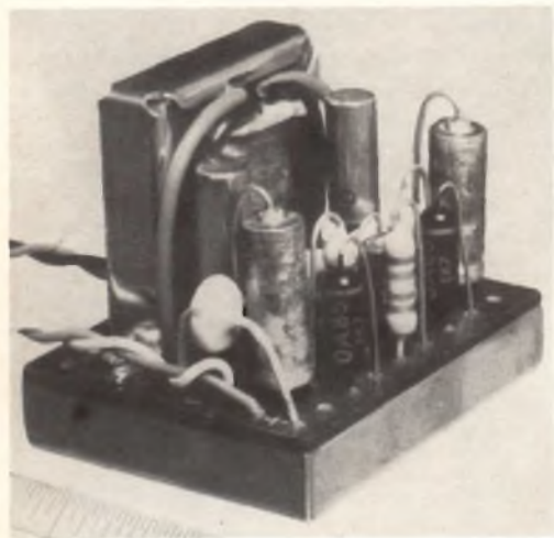
Fig. 2 - Realizzazione pratica del convertitore CC/CC da 900 mW
