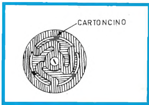
Fig. 2 - Disegno schematico di un centratore per bobina.
