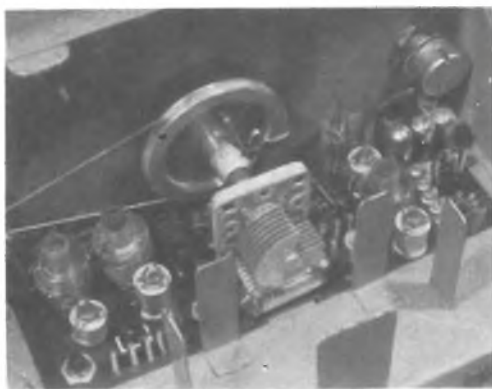
Fig. 5 - A destra si trova la sezione B.F. al centro il condensatore variabile a sinistra la sezione R.F.
