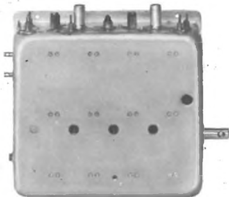
Fig. 8 - Vista frontale del selettore di canali UHF tipo A3.72952/PM.
