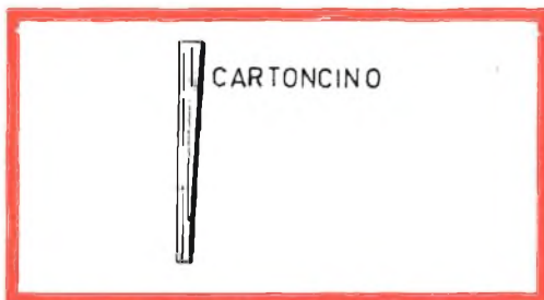
Fig. 5 - Cartoncino usato per muovere la bobina dell'altoparlante.
