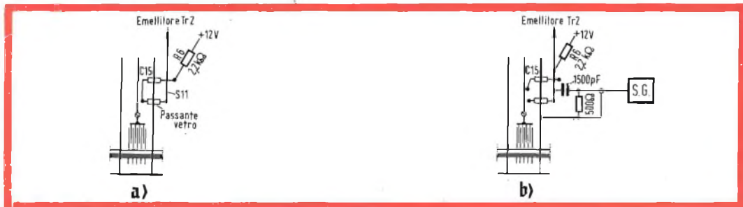
Fig. 6 - Modifiche da eseguire sul selettore per effettuare il rilievo della curva del filtro di banda RF:
