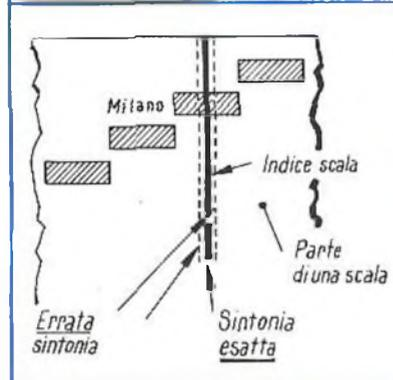
Vedremo che portando l'indice della scala in corrispondenza del contrassegno che individua Milano I, possiamo spostarlo di un poco a destra e a sinistra di questo punto (corrispondente alla frequenza di 899 kHz) senza per questo cessare di udire l'emittente.
