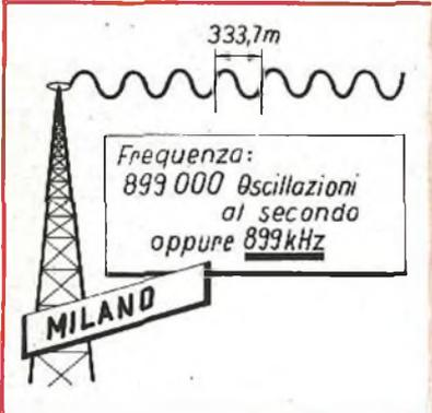
Un'onda elettromagnetica « portante » ha una frequenza ben determinata per esempio Milano I ha una frequenza di 899 kHz corrispondente ad una lunghezza d'onda di 333,7 m.
