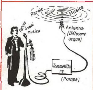
L'onda « portante » trasporta e irradia nell'etere il suono o la voce; le oscillazioni meccaniche del suono che possono propagarsi solo in un mezzo materiale vengono trasformate in oscillazioni elettromagnetiche capaci di raggiungere qualsiasi punto della terra e dello spazio.
