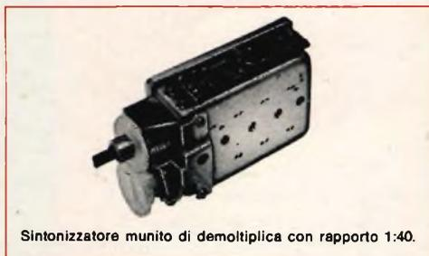
Sintonizzatore munito di demoltiplica con rapporto 1:40.
