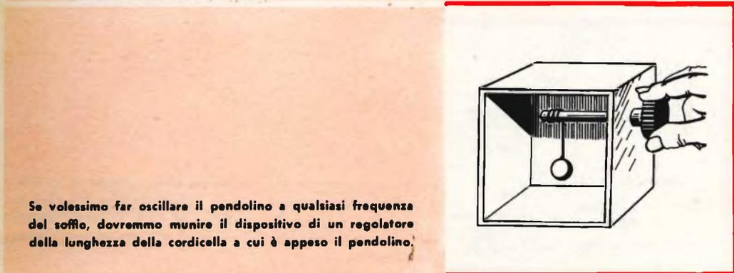
Se volessimo far oscillare il pendolino a qualsiasi frequenza del soffio, dovremmo munire il dispositivo di un regolatore della lunghezza della cordicella a cui è appeso il pendolino.
