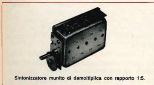
Sintonizzatore munito di demoltiplica con rapporto 1:5.
