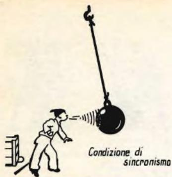
Se la frequenza degli urti è uguale alla frequenza di oscillazione del sistema, si potrebbe mettere in oscillazione il pendolo, anche mediante dei semplici soffi di aria, ma dati ad intervalli appropriati.
