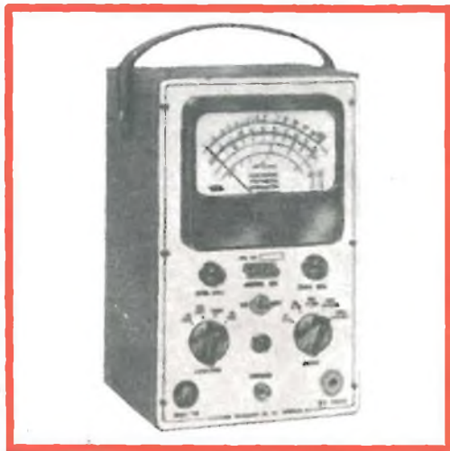
Fig. 2 - Voltmetro elettronico EICO modello 221.
