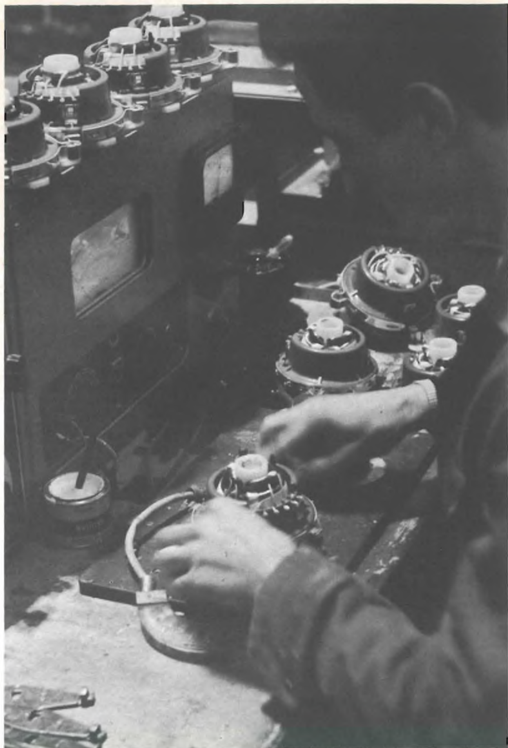
Banco di collaudo di unità di deflessione per televisione.
