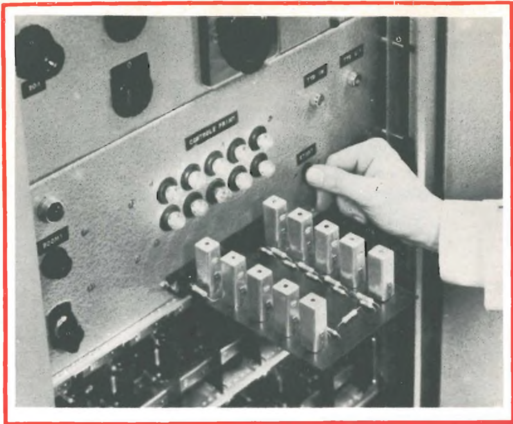
Banco di collaudo di piastre con fotorelé.
