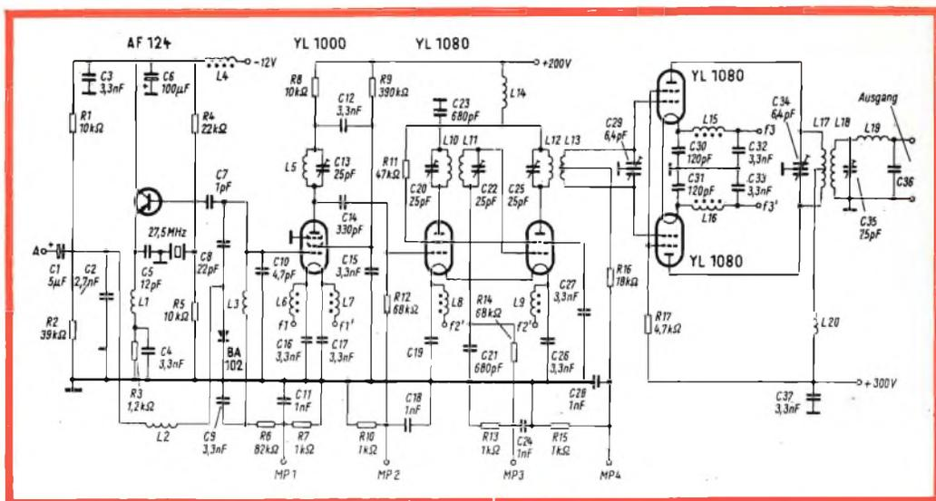
Fig. 2 - Schema elettrico del trasmettitore ad onde ultracorte modulato di fase con potenza RF d'uscita di 12 W.
