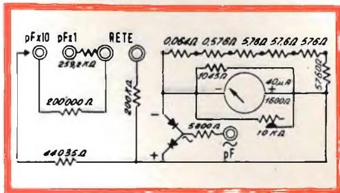
Fig. 9 - Circuito semplificato ohmetro in c.a.
