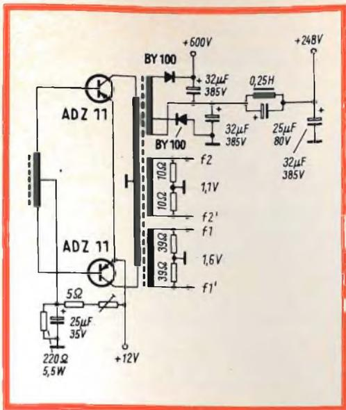
Fig. 3 - Schema elettrico del « D.C. converter »; sono previsti gli avvolgimenti per l'accensione dei filamenti delle valvole « quick heating ».
