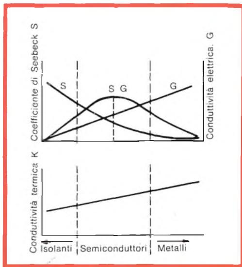
Fig. 1 - Capacità termoelettrica di materiali differenti.
