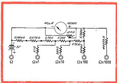
Fig. 6 - Circuito semplificato ohmetro in c.c.
