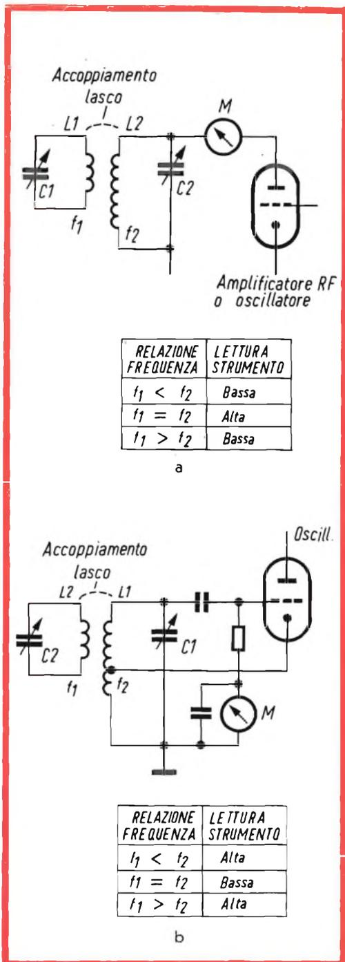
Fig. 2 - Principio fondamentale del grid-dip. Lo strumento  $M$  della fig. (b) darà sempre una certa indicazione finché le frequenze dei due circuiti accoppiati non coinciderà. Solo in questo caso avremo una brusca diminuzione (dip).
