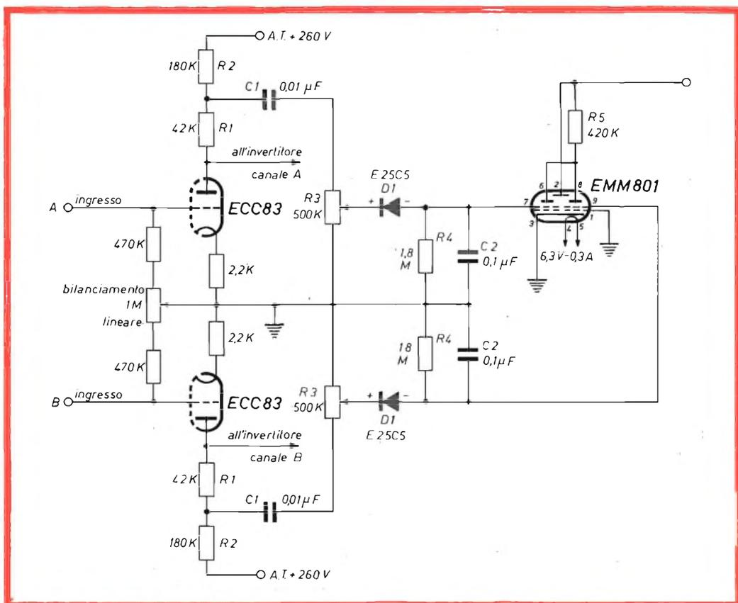
Fig. 1 - Schema elettrico dell'indicatore di bilanciamento.
