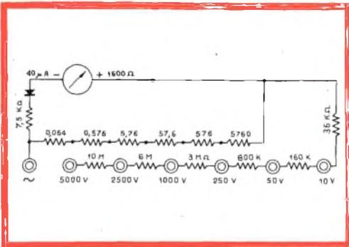
Fig. 2 - Circuito semplificato Voltmetro ni c.a.
