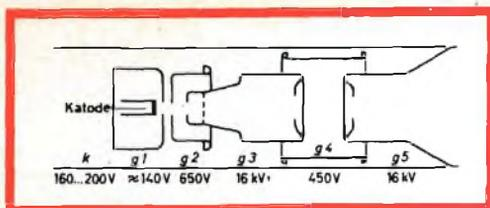
Fig. 45 - Sistema elettrodotico di un cinescopio.
