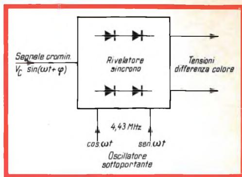
Fig. 6 - Schema semplificato del rivelatore sincrono.
