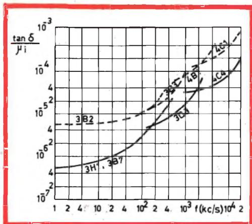
Fig. 2 - Diminuzione del coefficiente di perdita relativa  $\tan \delta / \mu_i$  per i tipi di ferroxcube 3H1 (3B7), 3D3, 4C4, in funzione della frequenza. Per confronto sono riportate le curve dei vecchi tipi di ferroxcube 3B2, 3B3, 4B1 e 4C1.
