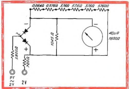
Fig. 3 - Circuito semplificato Voltmetro 2 V in c.a.
