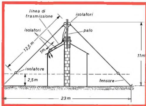
Fig. 1 - Esempio di antenna a V rovesciato.
