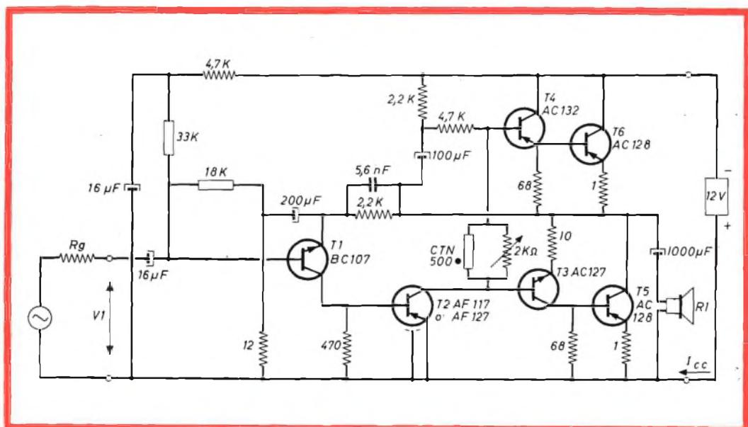
Fig. 7 - Schema elettrico dell'amplificatore BF da  $1,8 \div 2$  W alimentato con 12 V. Le resistenze segnate con il rettangolo hanno una tolleranza del 5 % mentre le altre del 10 %, la resistenza NTC è da 500  $\Omega$ , tipo B8 320 01P/500E.
