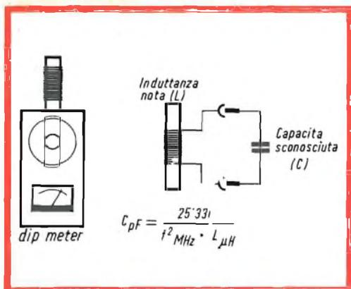
Fig. 4 - Misura di una capacità mediante grid-dip.
