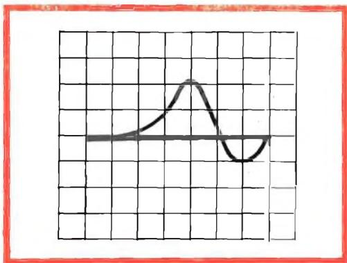
Fig. 4 - Curva indicante una cattiva regolazione del rivelatore a rapporto.
