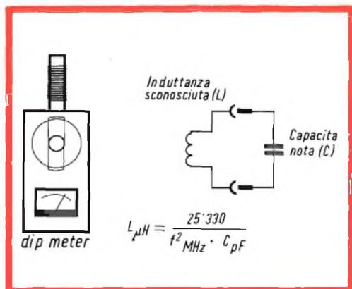
Fig. 5 - Misura di un'induttanza mediante grid-dip.
