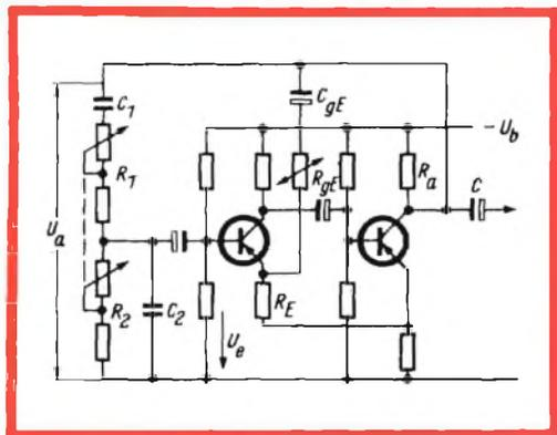
Fig. 7 - Schema di principio del generatore RC.
