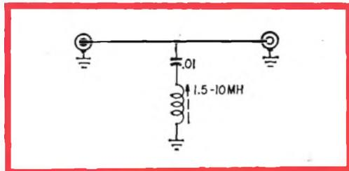
Fig. 1 - Circuito di filtro per registrazioni stereofoniche. Se l'unità ha una impedenza molto bassa, una resistenza di poche migliaia di ohm fra i jack di uscita e l'ingresso del filtro può causare una riezione di frequenza.
