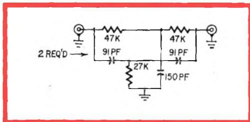
Fig. 2a - Circuito di filtro parallelo a « T » (19 kHz) per registrazioni monofoniche; tutti i componenti hanno una tolleranza del 5%.
