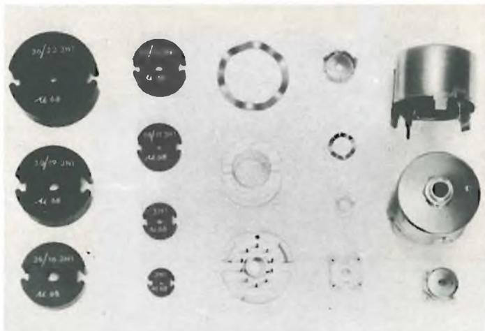
bilità effettiva  $\mu_e$  si otteneva con una diminuzione corrispondente del nucleo centrale (regolazione magnetica). Una striscia di materiale sintetico inserito nel traferro e rivestito di ferroxcube di spessore aumentante permette di completare la regolazione dell'induttanza.
