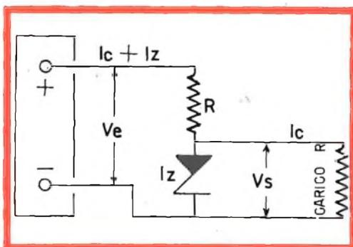
Fig. 2 - Circuito stabilizzatore con diodo Zener.
