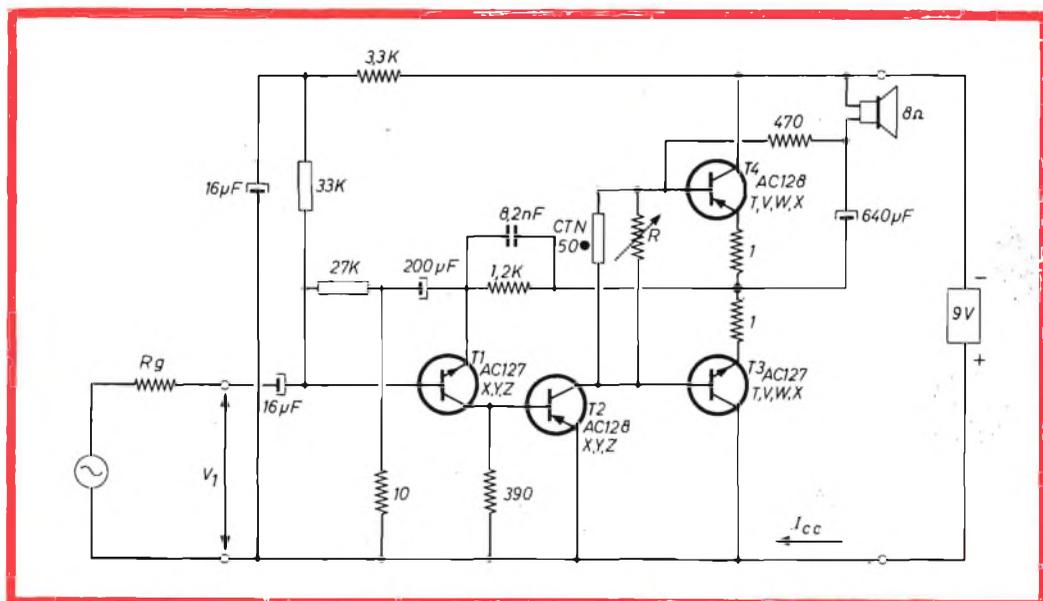
Fig. 5 - Schema elettrico dell'amplificatore BF da 0,75 W alimentato con 9 V. Le resistenze segnate con il rettangolo hanno una tolleranza del 5% mentre le altre del 10%; la resistenza NTC è da 50  $\Omega$ .
