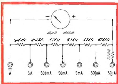
Fig. 4 - Circuito semplificato milliamperometro in c.c.
