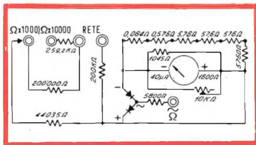
Fig. 10 - Circuito semplificato capacimetro in c.a.
