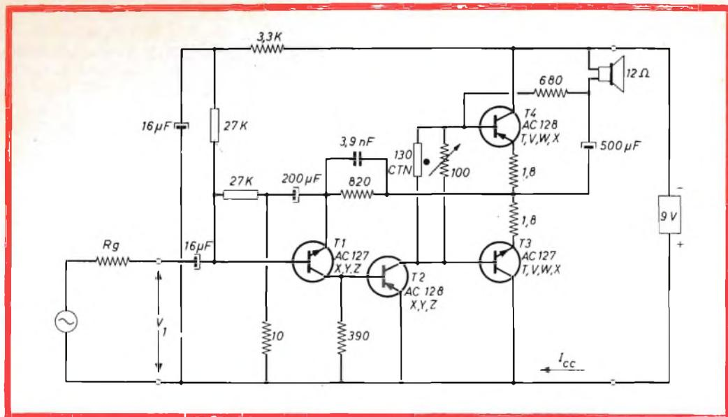
Fig. 4 - Schema elettrico dell'amplificatore BF da 0,5 W alimentato con 9 V. Le resistenze disegnate con il rettangolo hanno una tolleranza del 5% mentre le altre del 10%; la resistenza NTC è da 130  $\Omega$  tipo B8 320 01P/130E.
