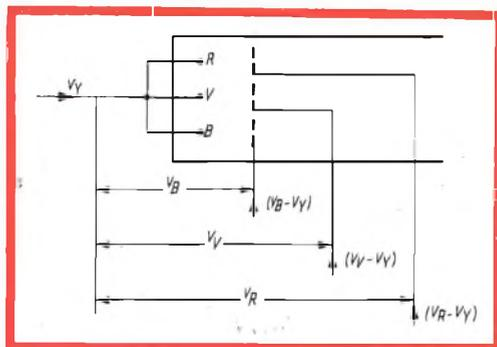
Fig. 8 - Come avviene il pilotaggio del cinescopio tricromatico.
