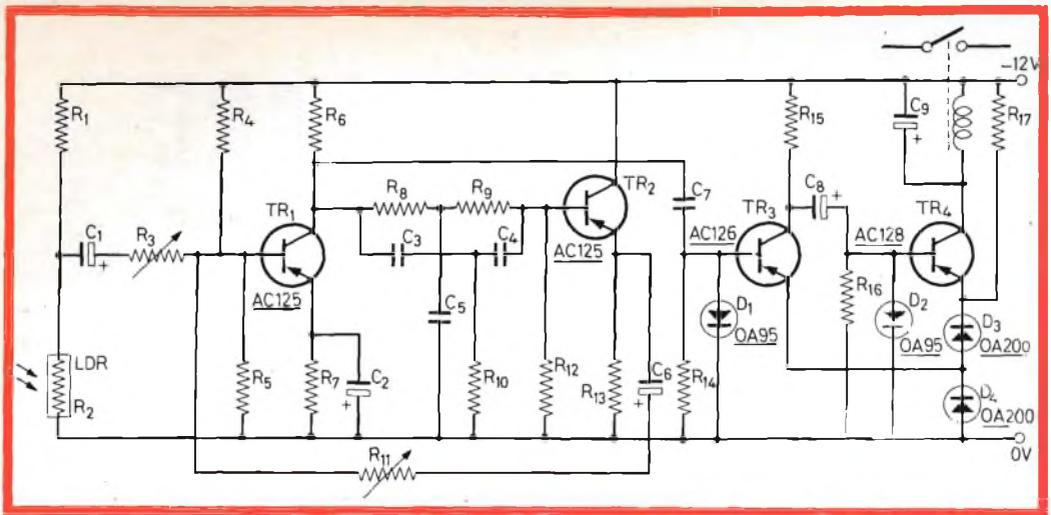
Fig. 2 - Dettagli del circuito dell'amplificatore-interruttore del fascio luminoso. Il trimmer  $R_3$  serve per la regolazione della sensibilità, mentre il trimmer  $R_{11}$  per la regolazione della larghezza di banda
