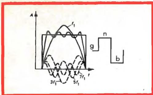
Fig. 38 - Composizione di un impulso di tensione rettangolare; si notino l'onda fondamentale e le armoniche di ordine dispari.  $n$  = nero,  $g$  = grigio,  $b$  = bianco.
