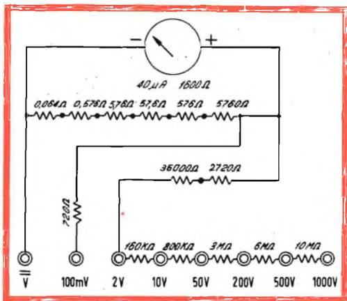
Fig. 1 - Circuito semplificato Voltmetro in c.c.
