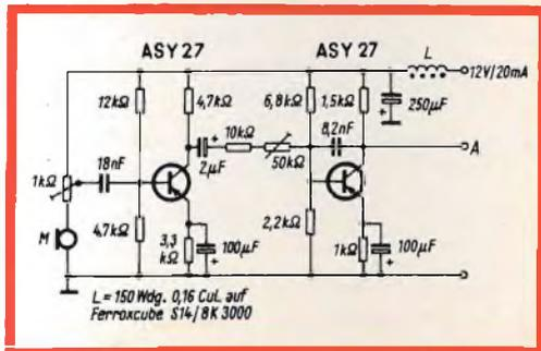
Fig. 1 - Schema del modulatore a transistor.
