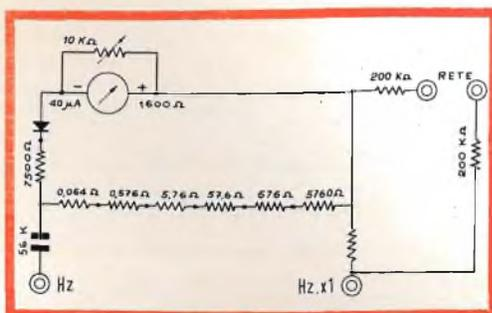
Fig. 12 - Circuito semplificato frequenzimetro.
