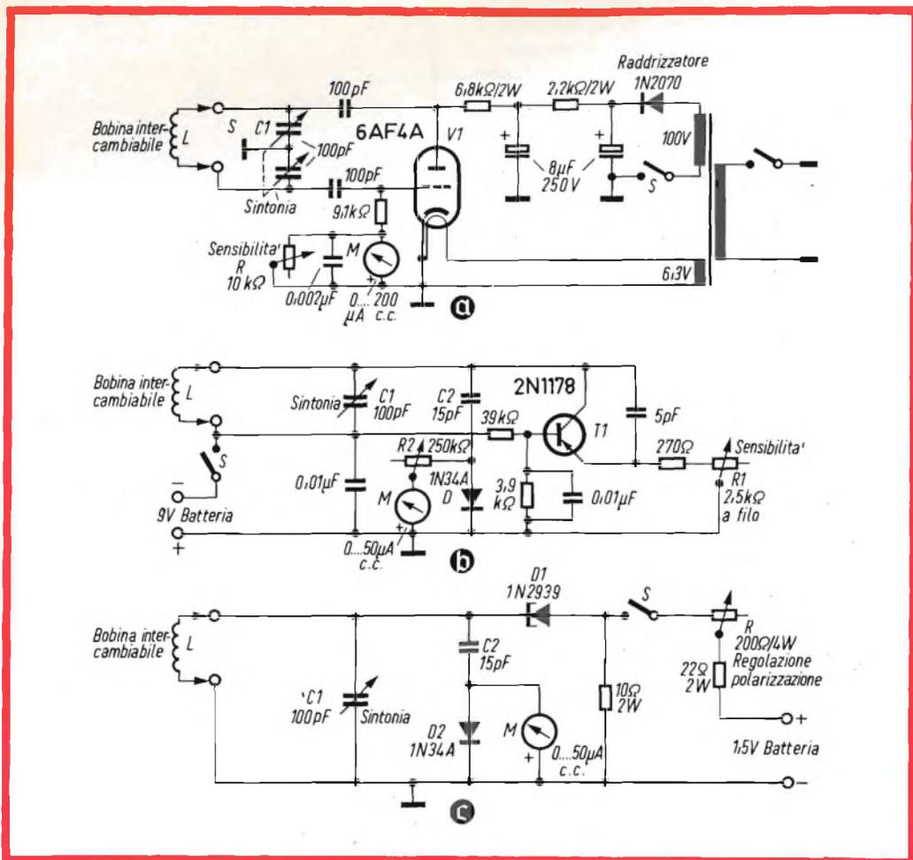
Fig. 3 - Tre circuiti fondamentali di grid-dip.
