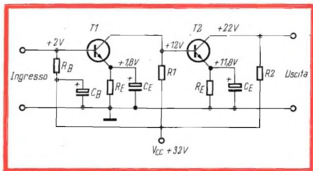
Fig. 19 Amplificatore con stadi accoppiati direttamente (in c.c.).
