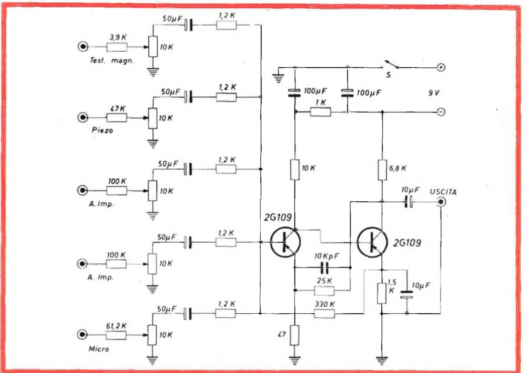
Fig. 1 - Schema elettrico del mixer a transistor.
