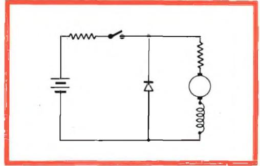
Schema di principio del comando di velocità mediante interruttore in serie al motore.
