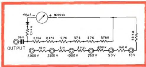
Fig. 13 - Circuito semplificato misuratore d'uscita.
