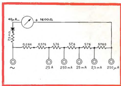
Fig. 5 - Circuito semplificato Amperometro in c.a.
