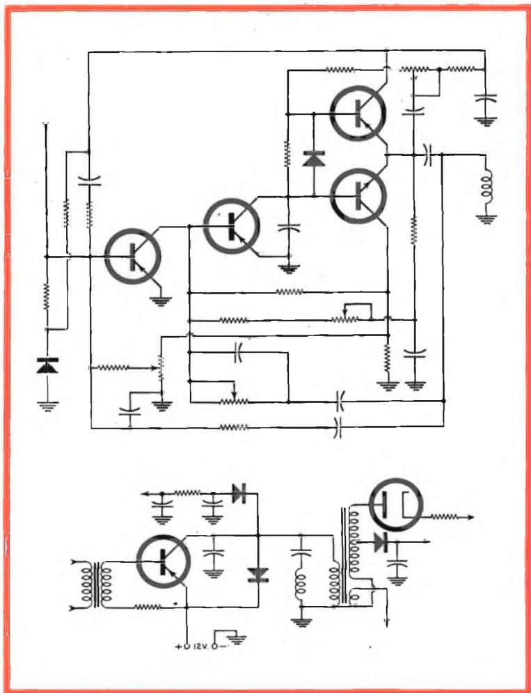
Esempio di circuito di uscita verticale di un ricevitore TV portatile a transistori.
