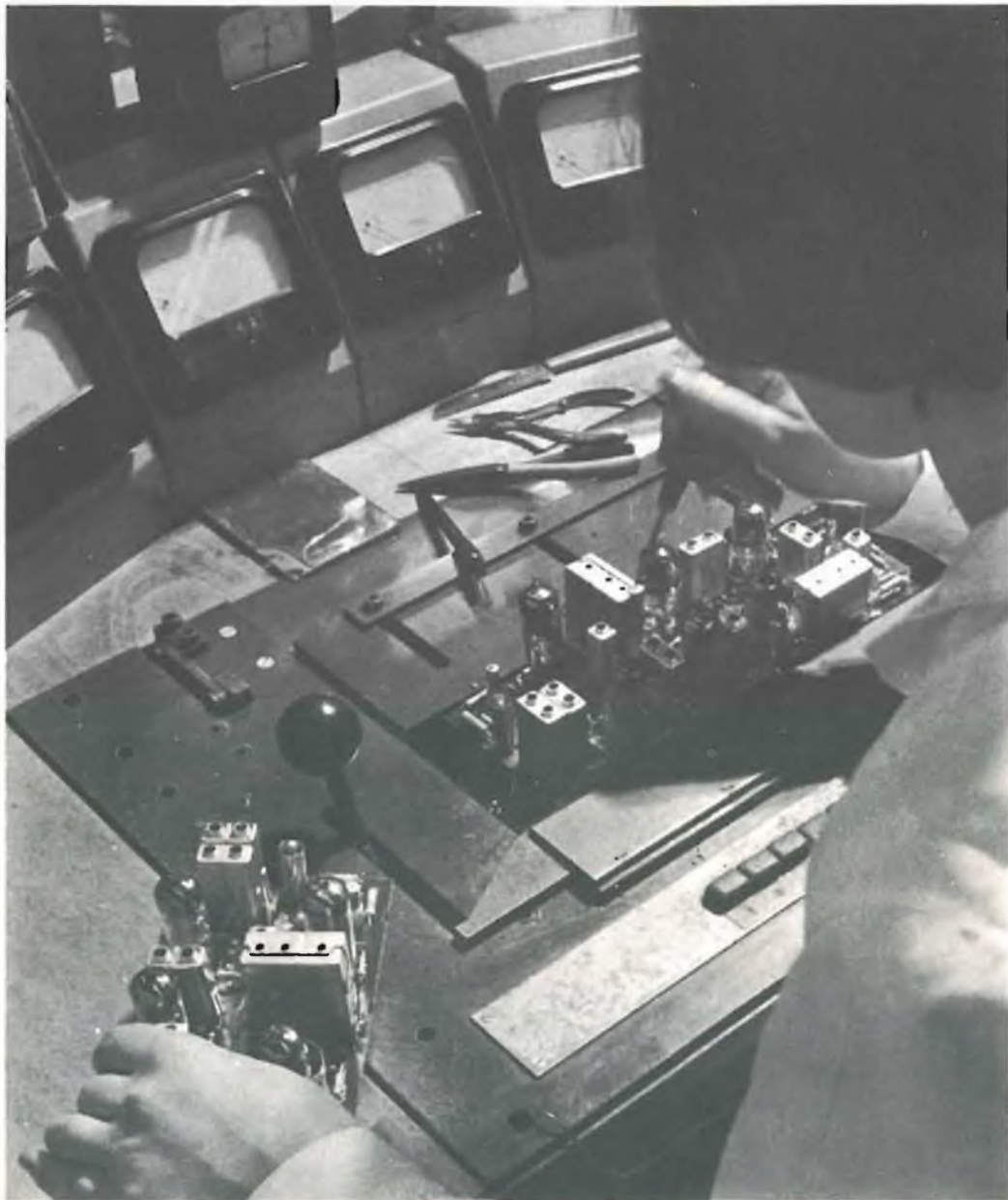
Banco di controllo per la taratura di un ricevitore AM/FM (fabbrica apparecchi Philips - Monza).
