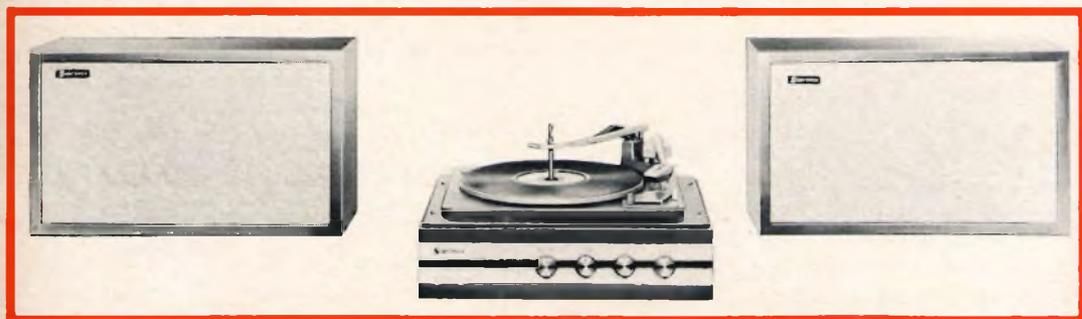
Questo complesso stereofonico è dotato di un cambiadischi automatico Garrard modello 2000 a 4 velocità con cartuccia piezoelettrica e possibilità di suonare fino ad 8 dischi mescolati. Di un amplificatore di alta qualità, a bassissimo rumore di fondo con potenza musicale di uscita di 7 watt per canale e con una gamma di risposta compresa tra i 40 e i 13.000 Hz.
