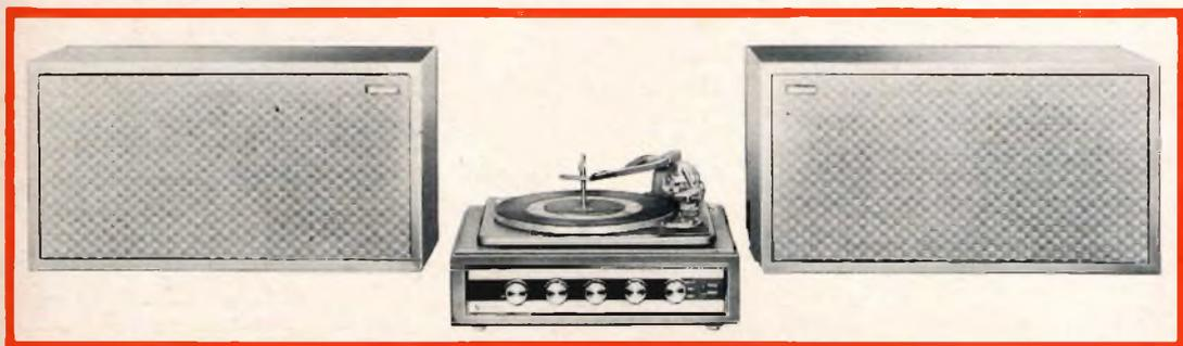
Impianto stereo ad alta fedeltà costituito da un cambiadischi semiprofessionale Garrard mod. AT 60 a 4 velocità, con cartuccia piezoelettrica, da un amplificatore stereo da 8 + 8 W, con alimentazione universale, e con una risposta di frequenza lineare da 40 a 15.000 Hz, e da due diffusori mod. U 5.
