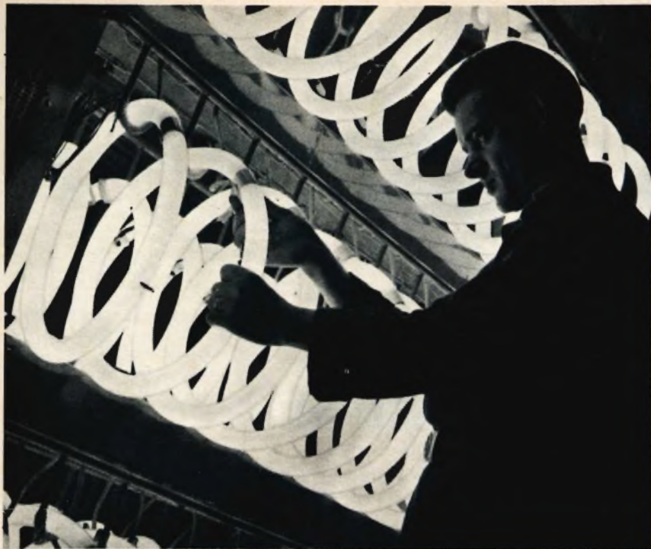
Prova e controllo finale delle lampade « TL ».
