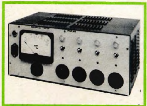
Termoregolatore proporzionale a diodi controllati.
