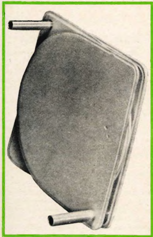
Fig. 2 - Elettrodo di una pila a idrogeno-ossigeno. (Documentazione C.G.E.)
