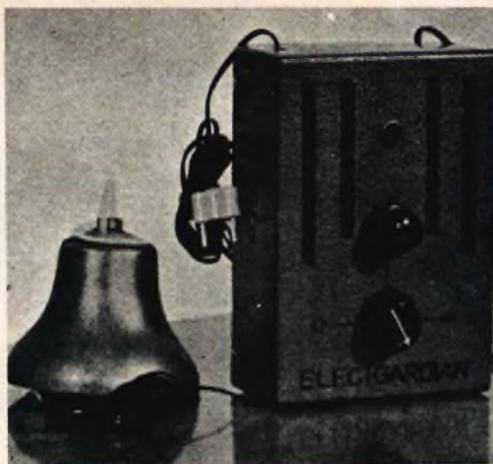
Fig. 2 - Avvisatore elettronico a montaggio ultimato. A sinistra suoneria d'allarme.
