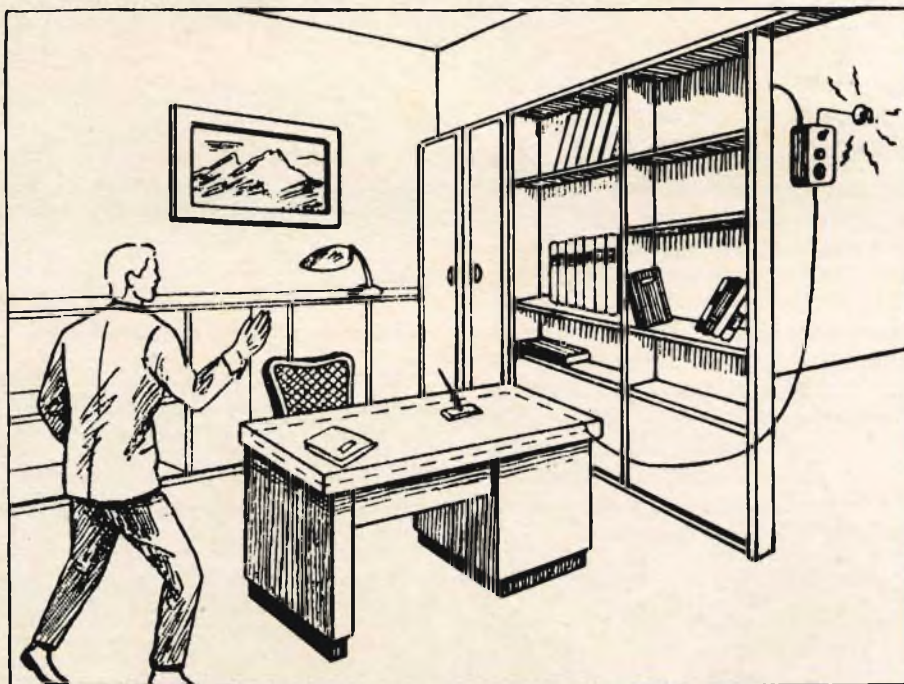
Fig. 3 - Come sistemare l'avvisatore elettronico.
