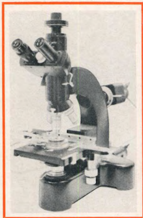
Fig. 22 - Microscopio con piastrina equipaggiata con una batteria Peltier.
