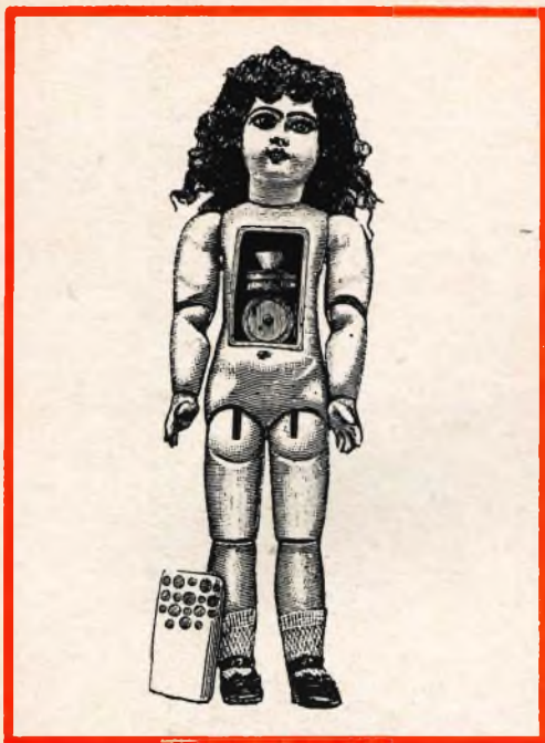
Bambola parlante munita internamente di grammfono; essa era in grado di parlare e di cantare in diverse lingue, grazie alla intercambiabilità dei cilindri.
