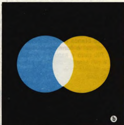
Fig. 11 - Un esempio che dimostra la differenza fondamentale tra la tecnica di formazione dei colori usata dalla stampa e dalla fotografia a colori e quella usata in televisione (a). La mescolazione di un pigmento blu con un pigmento giallo dà il verde. Gli stessi colori forniti da sorgenti luminose daranno invece il bianco (b).
