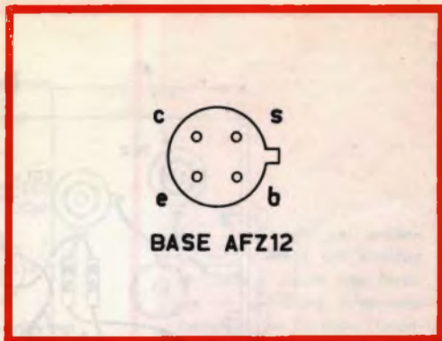
Fig. 6 - Collegamenti alla base del transistor Mullard tipo AFZ12. I simboli rappresentano gli elettrodi come segue: c = collettore, b = base, e = emettitore, s = non collegare. I collegamenti vanno riferiti alla chiave visibile a destra, avente il compito di individuarli.
