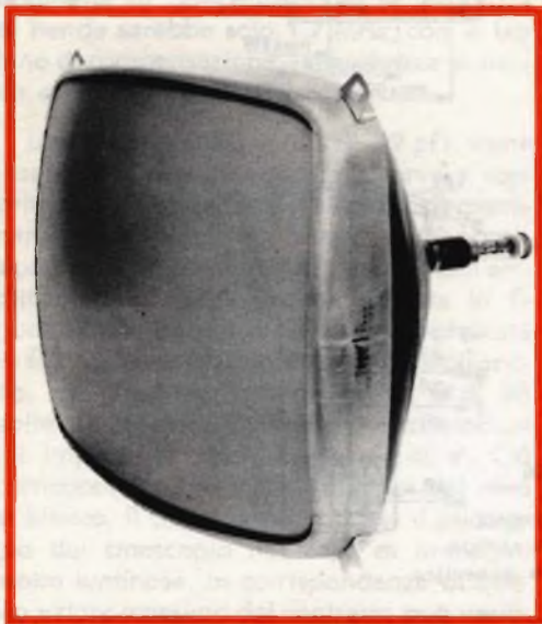
Fig. 18 - Come si presenta il cinescopio tricromatico a maschera forata tipo A63-11X Philips.
