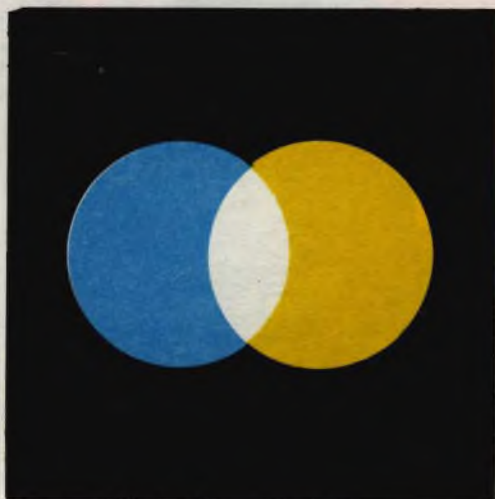
Fig. 6 - Concentrando su un unico punto una luce blu ( \lambda = 450...482 nm) ed una luce gialla ( \lambda = 575...580 nm), esiste un dato valore delle intensità luminose di queste sorgenti per cui questo stesso punto appare all'occhio di colore bianco. Esistono infinite combinazioni di intensità luminosa di queste due sorgenti capaci di dare all'occhio la sensazione del bianco. Queste coppie di colori vengono chiamate colori complementari .
