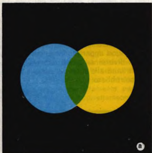
Fig. 11 - Un esempio che dimostra la differenza fondamentale tra la tecnica di formazione dei colori usata dalla stampa e dalla fotografia a colori e quella usata in televisione (a). La mescolazione di un pigmento blu con un pigmento giallo dà il verde. Gli stessi colori forniti da sorgenti luminose daranno invece il bianco (b).
