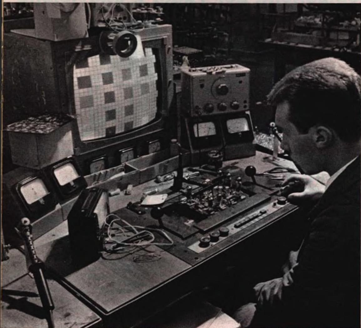
Controllo visivo sullo schermo del cinescopio di un pannello a circuito stampato nel quale si trovano alcuni circuiti di un televisore.
