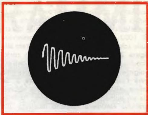
Fig. 2 - Esempio di oscillogramma ottenuto con una bobina assolutamente priva di corto-circuiti.
