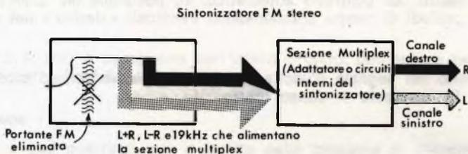
Successivamente la componente a 38 kHz viene soppressa e rimangono le sue bande laterali modulate che vengono impresse, insieme ad un segnale pilota a 19 kHz, sulla portante principale e quindi trasmesse.
