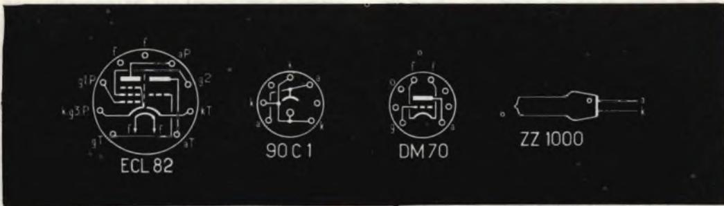
Fig. 1a - Zoccolatura delle valvole impiegate nel posometro.
