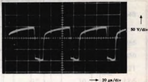
Fig. 37 - Forma d'onda della tensione di pilotaggio alla griglia controllo della PL 500 ( V_{1a} ).
