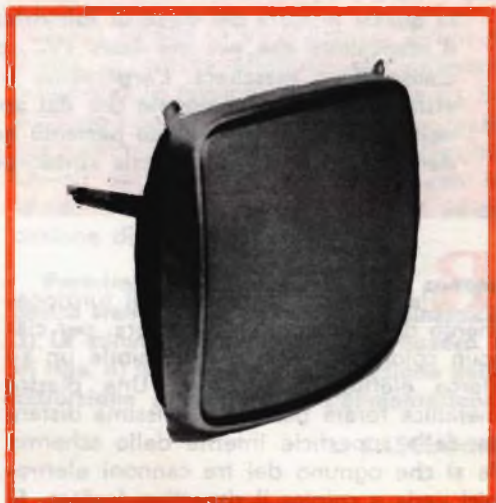
Fig. 3 - Cinescopio completo con nastro metallico anti-implosione.
