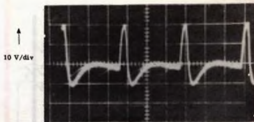
Fig. 30 - Oscillogramma dell'impulso di sincronismo di riga rilevato sull'anodo dell'invertitore di fase V_8 .
