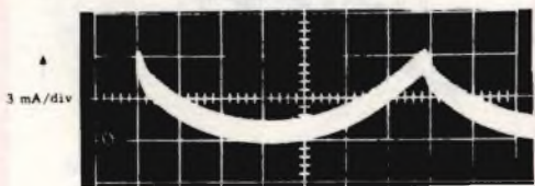
Fig. 66 - Forma d'onda della corrente a frequenza di quadro che attraversa la bobina di convergenza del cannone del verde.
