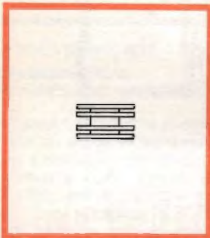
Fig. 2 - Dissipatore di calore per il 2N2297.
