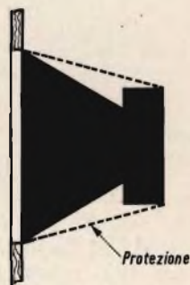
Fig. 3 - La garza di protezione, permette di proteggere il cono dell'altoparlante da eventuali depositi provocati dalla lana di vetro che ricopre le pareti della cassetta.
