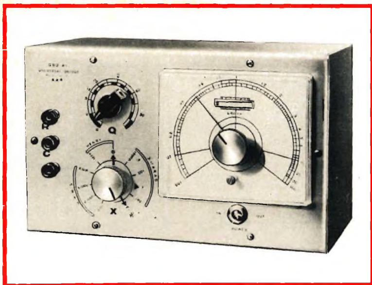
Fig. 4 - Disposizione dei comandi nel ponte R.C.L.
