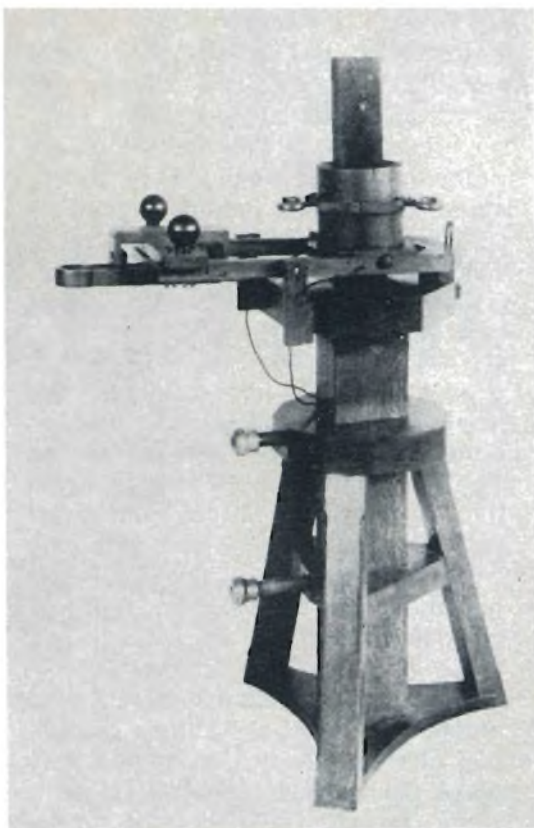
Fig. 8 - Appareto trasmettente (copia della versione del 1836). Esso è un induttore costituito da una grande bobina di filo che poteva spostarsi grazie a una leva lungo due magneti diritti verticali. L'operatore doveva tenere i due bottoni e spostare la sua estremità della leva verso il basso o verso l'alto.
