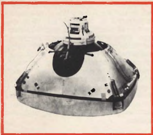
Fig. 7 - Come si presenta un cinescopio schermato. (La fotografia riporta un cinescopio di scarto mancante di collo al posto del quale è stata posta l'unità di deflessione. Per il nostro scopo ciò non ha alcun interesse).
