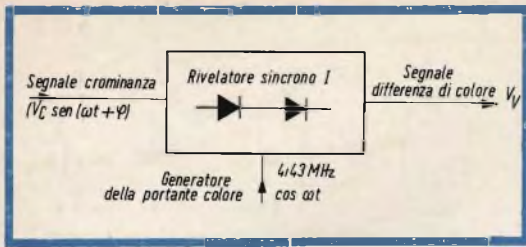
Fig. 119 - Sono gli schemi a blocchi dei due demodulatori sincroni. A tutti e due perviene il segnale di crominanza amplificato. A tutti e due viene iniettata l'oscillazione della portante del colore rigenerata (4,43 MHz). Le due portanti risultano però sfasate tra loro di 90°. Questa sfasatura è stata indicata mediante le funzioni trigonometriche di seno e coseno tra le quali, com'è noto, esiste una differenza di fase di 90°.
