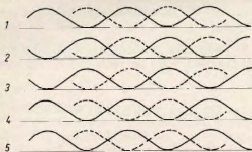
Fig. 110 - Interferenza prodotta sullo schermo di un cinescopio in bianco e nero dalla portante del colore nel caso in cui la frequenza di quest'ultima sia uguale ad un multiplo dispari di metà della frequenza di riga. I massimi di luminosità che la portante del colore produce su una riga (supponiamo la riga 3) vengono a trovarsi, in senso verticale, immediatamente al di sotto dei minimi della riga precedente (in questo caso, tenendo conto dell'interlaccio, questa riga sarebbe la 1). La cancellazione ottica di questa interferenza viene completata ulteriormente per il fatto che ogni massimo di luminosità viene rimpiazzato da un minimo di luminosità prodotto in corrispondenza dello stesso punto durante la scansione del quadro successivo (nella figura, indicato con un tratteggio).
