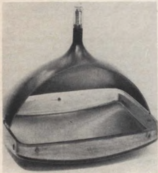
Fig. 2 - Spaccato di un cinescopio a maschera forata. Si vedono molto distintamente i perni di ferro-cromo fissati sulle pareti dello schermo. Questi perni servono per il fissaggio della maschera.
