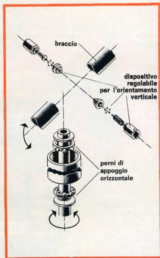
Fig. 4 - Disposizione dei cuscinetti di precisione regolabili del braccio.
