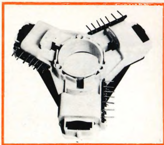
Fig. 3 - Unità di convergenza AT 1023/02 (Philips). Viene posta dopo l'unità di deflessione. Per la disposizione degli avvolgimenti per la convergenza dinamica a frequenza di riga e di quadro vedi fig. 6
