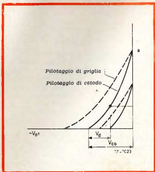
Fig. 11 - Variazione della pendenza nelle curve caratteristiche nel caso di pilotaggio di catodo e nel caso di pilotaggio di griglia.
