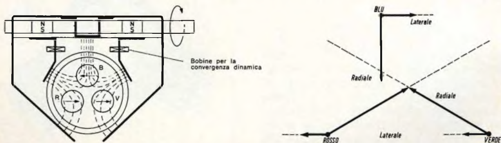
Fig. 7 - Illustrazione schematica del funzionamento dell'unità di convergenza laterale del blu. In alto abbiamo un nucleo in ferroxdure a forma di bastoncino che può essere ruotato in senso radiale. In questa maniera si regola l'influenza del campo magnetico sul raggio del blu. Questo raggio viene spostato lateralmente in maniera da andare ad incontrare i due raggi del rosso e del verde già coincidenti.
