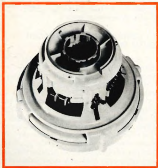
Fig. 2 - Unità di deflessione AT 1022/03 (Philips). L'insieme delle bobine di deflessione può essere spostato avanti e indietro per consentire la perfetta messa a punto della purezza dei colori.
