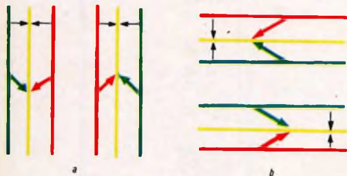
Fig. 18 - Messa a punto « matricizzata » della convergenza del rosso e del verde mediante immagine a reticolo.
