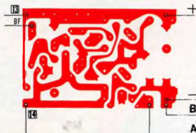
Fig. 4 - Collegamenti dell'amplificatore PMB/A.
