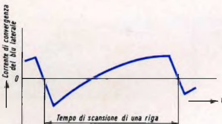
Fig. 15 - Errori di convergenza lungo gli assi verticale e orizzontale al centro dello schermo e correnti necessarie per la loro correzione.
