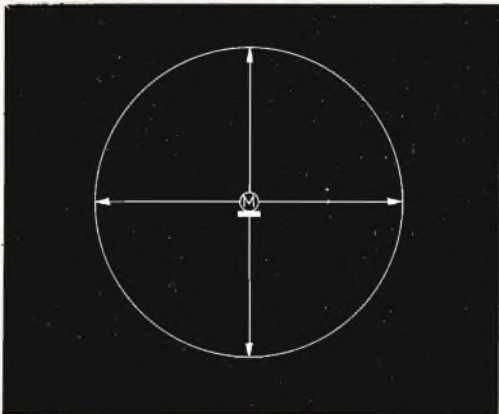
Fig. 1 - Grafico illustrante la sensibilità panoramica di un microfono normale (M). Indipendentemente dalle variazioni di intensità dei suoni originali, e dalla distanza tra la sorgente ed il microfono, la sensibilità rimane costante per qualsiasi posizione che la sorgente stessa assume entro la circonferenza.
