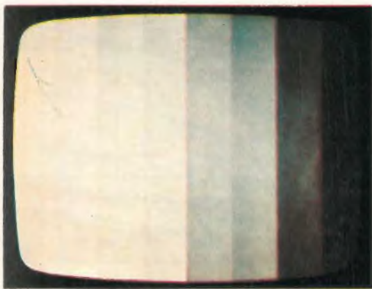
Fig. 40 - Scala dei grigi con eccessiva componente rossa. Gli « spostamenti » di colore nelle zone luminose della immagine sono più difficili da notare di quelli che si verificano nelle zone oscure dell'immagine.
