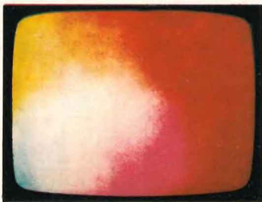
Fig. 26 - Come appare il raster quando ancora non è stata regolata la purezza del colore. In questo caso è stato fatto pervenire sullo schermo solo il raggio del rosso.
