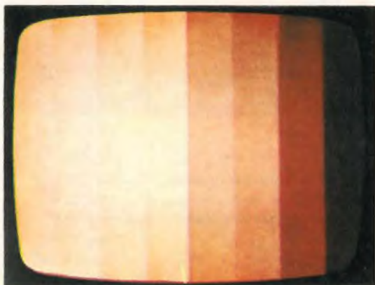
Fig. 40 - Scala dei grigi con eccessiva componente rossa. Gli « spostamenti » di colore nelle zone luminose della immagine sono più difficili da notare di quelli che si verificano nelle zone oscure dell'immagine.
