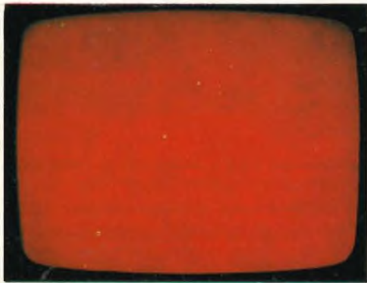
Fig. 27 - Come appare il raster del rosso dopo che è stata messa a punto la purezza del colore.
