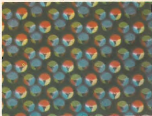
Fig. 29 - Visione ingrandita dei puntini di fosforo dello schermo nel caso di purezza di colori mal regolata.
