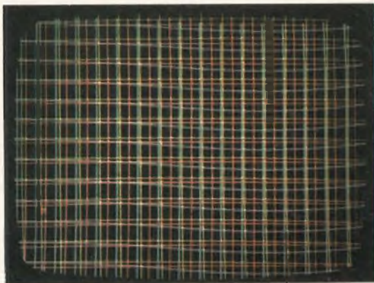
Fig. 21 - Come appare il segnale a reticolo sullo schermo del cinescopio prima della messa a punto della convergenza. La mancanza di convergenza produce anche una certa impurezza di colore.
