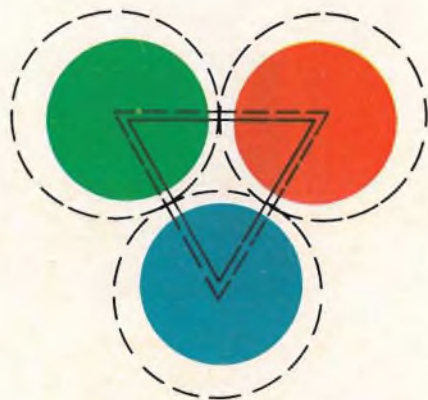
Fig. 30a - Messa a punto della purezza del colore. Al centro dell'immagine deve verificarsi la sovrapposizione dei centri di gravità dei due triangoli formati rispettivamente da una triade e dalle aree eccitate dei fosfori della triade medesima.
