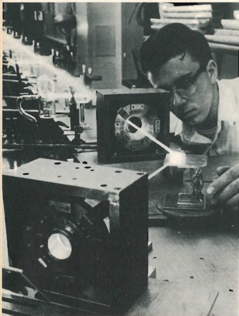
Un particolare del sistema ottico posto all'uscita di un laser a gas della Bell Telephone, uno dei più lunghi mai costruiti: oltre 10 metri.
