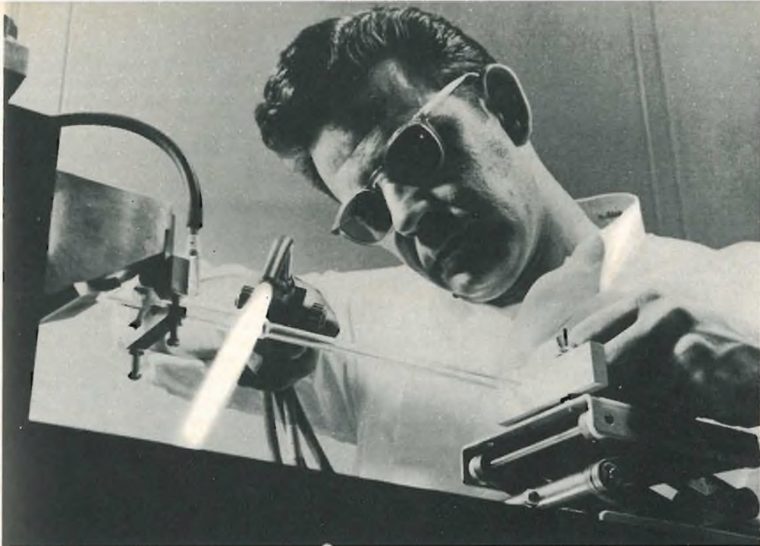
Nella fotografia qui sopra viene mostrata una fase di saldatura delle parti in vetro di un laser a gas.
