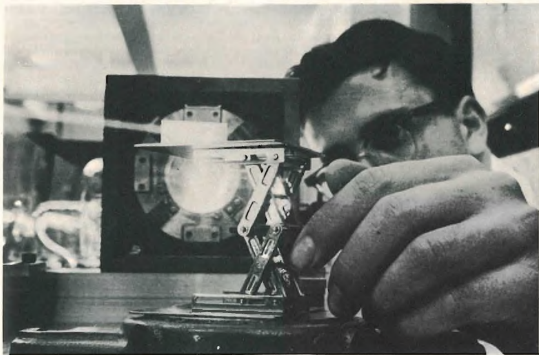
Una macchina fotografica riprende direttamente il fascio laser, e vede ciò che l'occhio non può vedere. Infatti l'occhio umano focalizza la luce parallela del fascio laser e ne concentra tutta la potenza su un piccolo punto della retina, con il pericolo di provocare gravi danni.
