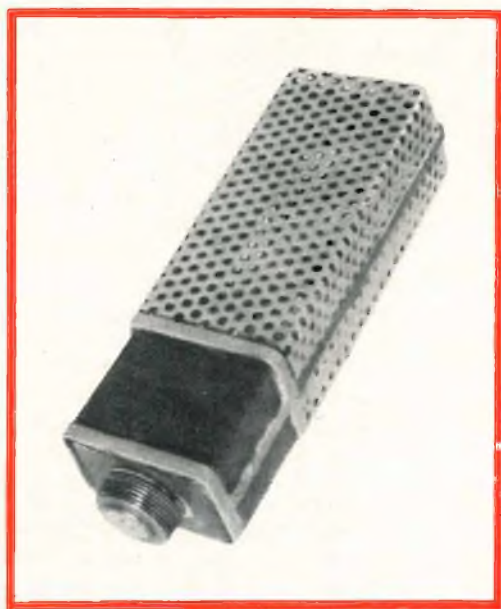
Fig. 20 - Aspetto esterno del microfono, così come è stato realizzato. È facile notare la disposizione del raccordo. L'involucro esterno può essere verniciato o cromato, a seconda delle preferenze del costruttore.
