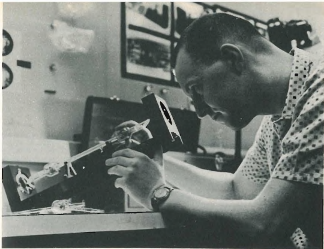
Un tecnico dei Bell Telephone Laboratories controlla l'allineamento di un piccolo modello di laser a gas.
