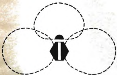
Fig. 6 - Sistema di microfoni stereofonici formato da un microfono con caratteristica a otto e microfono con sensibilità unidirezionale da impiegare nelle registrazioni professionali.
