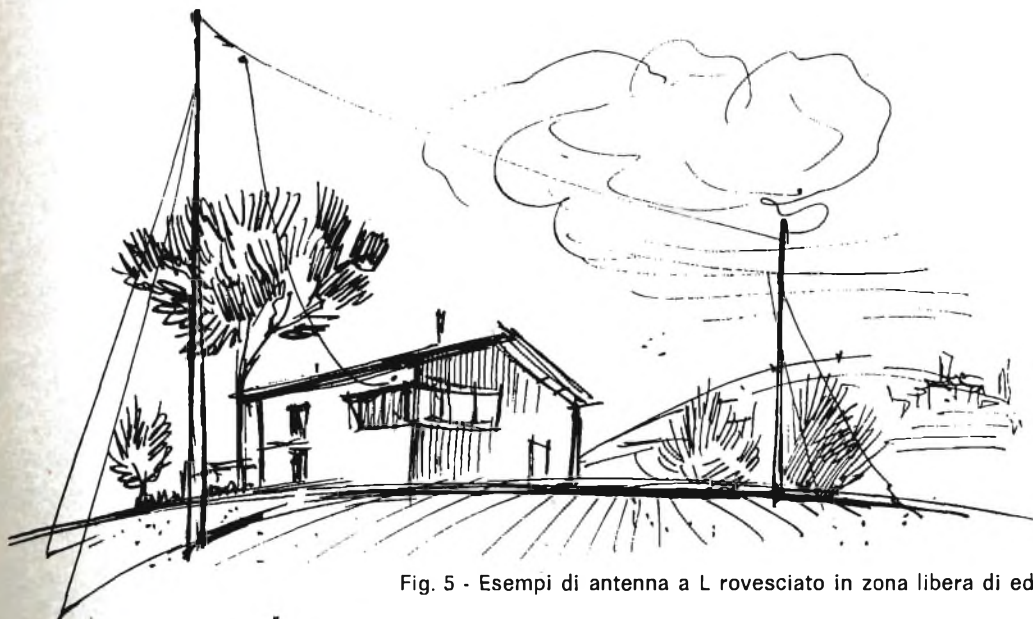
Fig. 4 - Installazione di antenna a L rovesciato.
