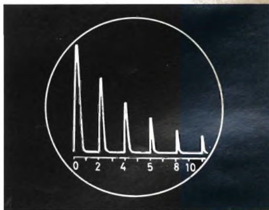
Fig. 6 - Esempio tipico di visualizzazione del segnale su tubo catodico; la scala graduata permette di valutare gli spessori.
