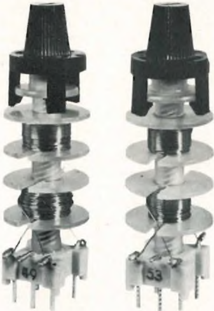
Fig. 14 - Bobine per la convergenza dinamica laterale e radiale del blu AT 4040/49 e AT 4040/53.
