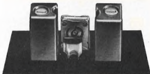
Fig. 16 - Fotografia di un filtro passa-banda ibrido di terzo ordine (circa 2 volte la grandezza reale).
