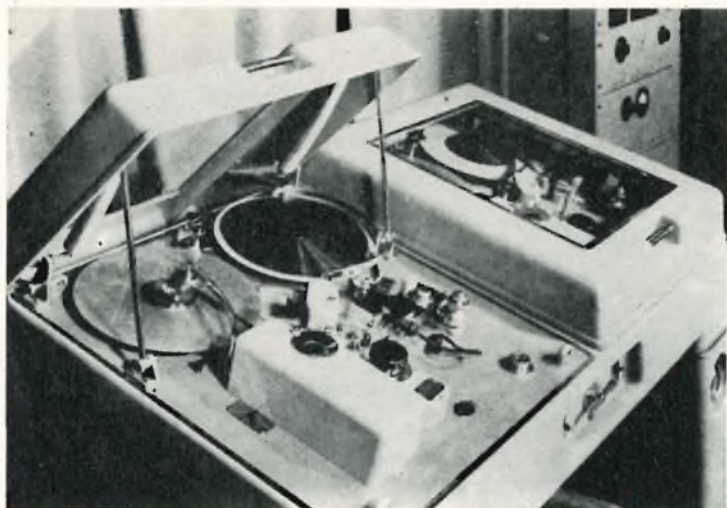
Fig. 4 - Apparecchiatura per la registrazione elettromeccanica del suono.
