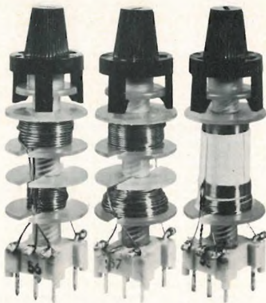
Fig. 12a-b-c - Bobine per la convergenza dinamica orizzontale AT 4040/56, AT 4040/57 e AT 4040/63.
