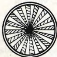
Pale di un dinodo rotanti come le pale di un ventilatore
