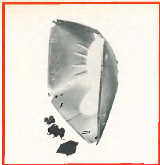
Fig. 38 - Schermo magnetico per cinescopio A56-11X.
