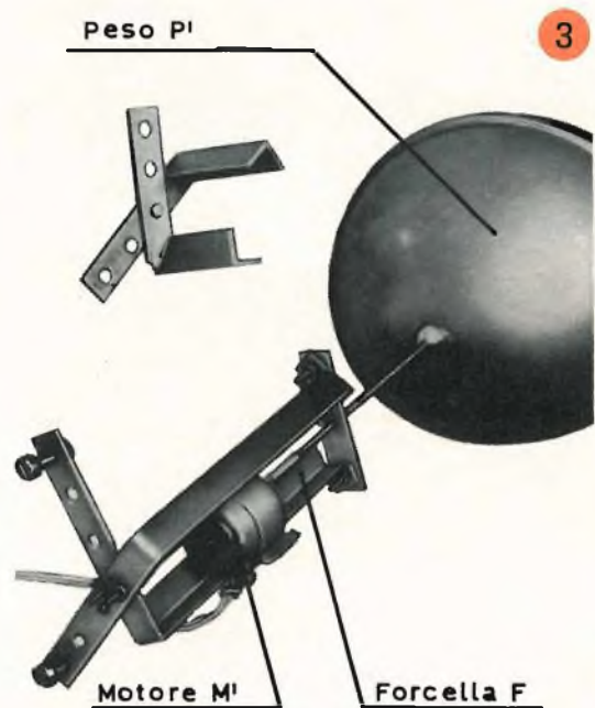
La fotografia riproduce un particolare del motore M' che corre entro la forcella F , e P' è rappresentato da una sfera rotante.
