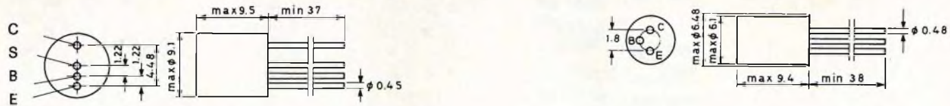
Fig. 2 - A sinistra: rappresentazione schematica del transistor AF115; S rappresenta il terminale dello schermo collegato all'involucro metallico. A destra: rappresentazione schematica del transistor AC126; il punto rosso indica il terminale del collettore.
