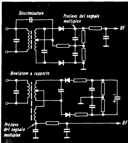
Fig. 2 - Esempi di circuiti di rivelazione equipaggiati con diodi semiconduttori.
