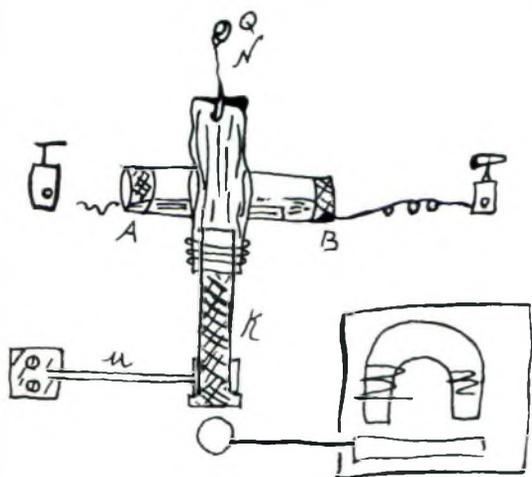
Fig. 6 - Schizzo del primo radiorecettore del mondo inventato da A.S. POPOV nel 1895. Lo schizzo è stato eseguito di propria mano dall'inventore in una lettera inviata a F.J. Kapustin. La versione stampata sulla rivista dell'Associazione Fisico-Chimica russa è visibile in fig. 7.
