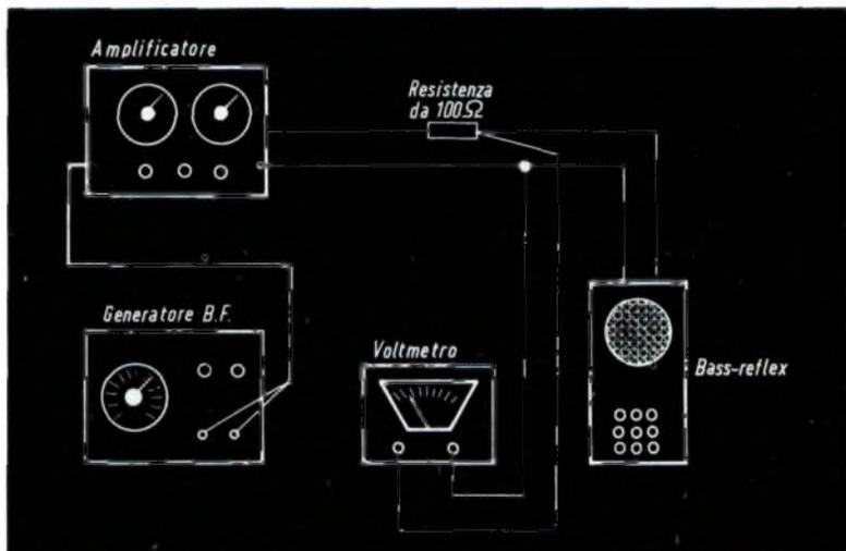
za, saranno a loro volta, trasformate sotto forma di variazioni di tensione del segnale di uscita del generatore, indicate dall'indice del voltmetro. Per quanto riguarda il montaggio rappresentato in fig. 2 non richiede alcuna caratteristica speciale del generatore, è solamente necessario che esso copra la gamma da 20 a 200 Hz. Lo strumento di misura utilizzato nei due montaggi è un voltmetro elettronico o un analizzatore universale adatto però a coprire la gamma di frequenze necessarie.
