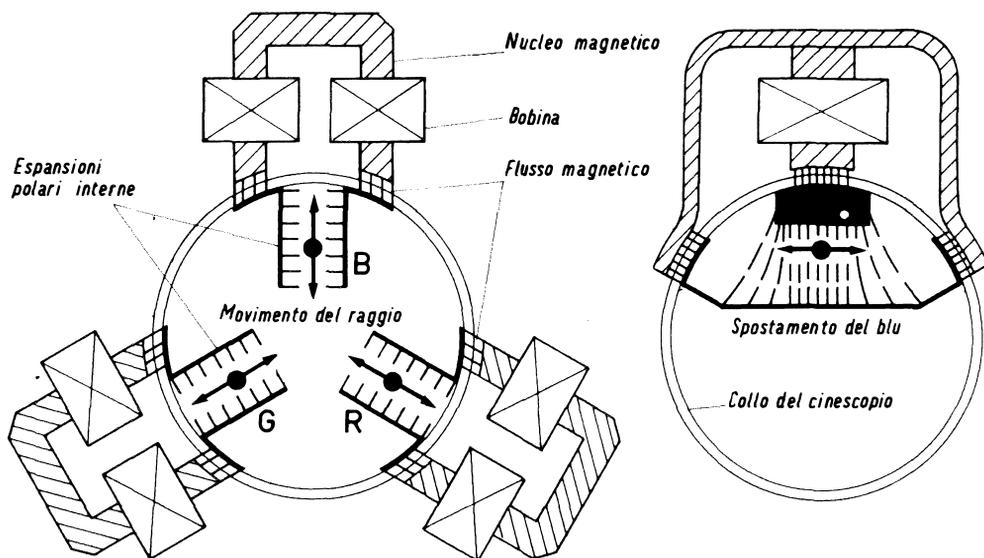
Fig. 11 - Possibilità di movimento dei tre pennelli elettronici sotto l'influenza del campo magnetico creato tra le espansioni polari montate internamente al tubo.
