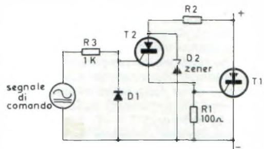
Fig. 2 - Come si può fissare la tensione ai morsetti del thyristor con un diodo Zener.
