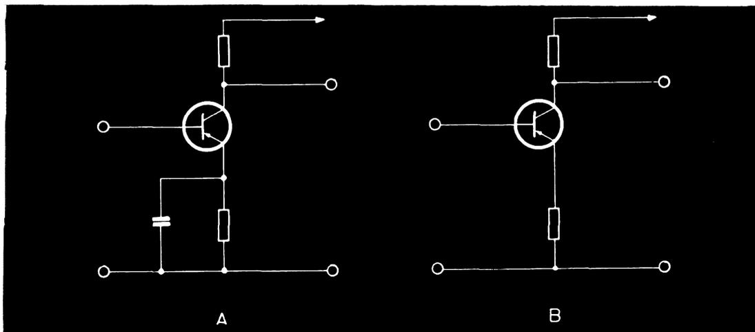
Fig. 10 - A rappresenta uno stadio di amplificazione convenzionale, provvisto di capacità di filtraggio in parallelo alla resistenza di emettitore. In B, tale capacità risulta soppressa, il che costituisce uno dei possibili metodi per ottenere in uno stadio singolo l'applicazione di una controeazione di corrente.
