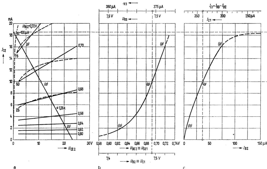
Fig. 3 - Caratteristica di lavoro dello stadio di ingresso di un regolatore per apparecchiature di riscaldamento di ambienti.
