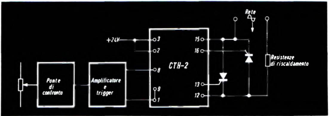
Fig. 5 - Schema a blocchi di un sistema di termoregolazione tutto-niente impiegante come organo termosensibile resistenze variabili con la temperatura.
