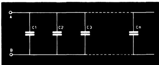
Fig. 2 - Quando due o più capacità vengono collegate in parallelo tra loro, il valore capacitivo risultante è dato dalla somma dei singoli valori delle capacità presenti nel circuito in parallelo.
