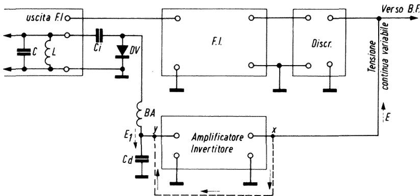
Fig. 2 - Esempio di circuito di un ricevitore munito di circuito CAF.
