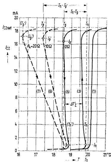
Fig. 6 - Correnti del relé del regolatore in dipendenza dalla temperatura ambiente a diverse condizioni di esercizio.
