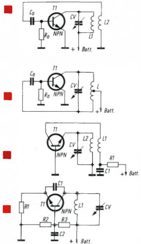
Fig. 3 - Alcuni circuiti oscillatori a transistor, corrispondenti ai rispettivi circuiti a valvole.
