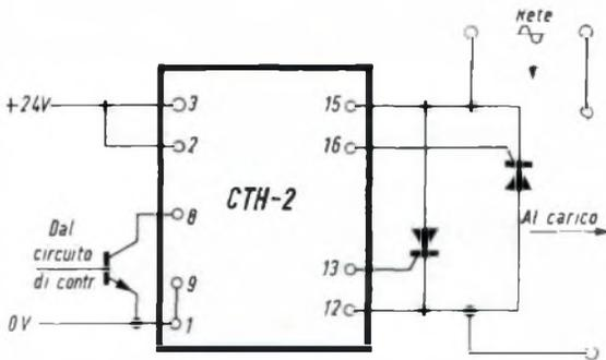
Fig. 3 - Schema tipico di impiego di un modulo CTH-2, per un comando on-off in corrente alternata.
