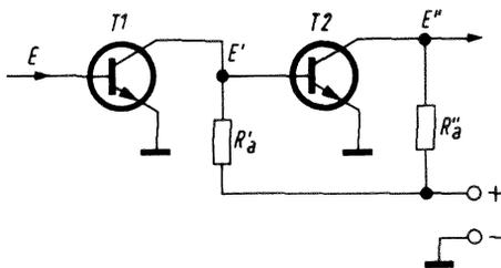
Fig. 4 - Esempio di circuito amplificatore di tensione continua a due transistor NPN.
