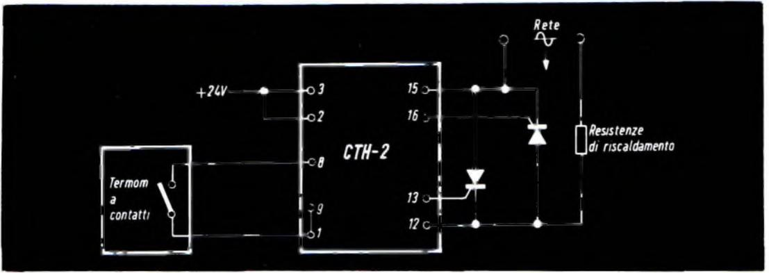
Fig. 4 - Schema a blocchi di un sistema di termoregolazione tutto-niente impiegante come organo termosensibile un termometro a contatto.
