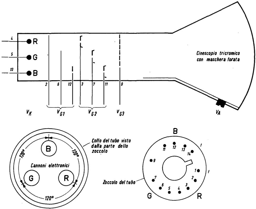
Fig. 1 - Struttura elettrodica del cinescopio a maschera.
