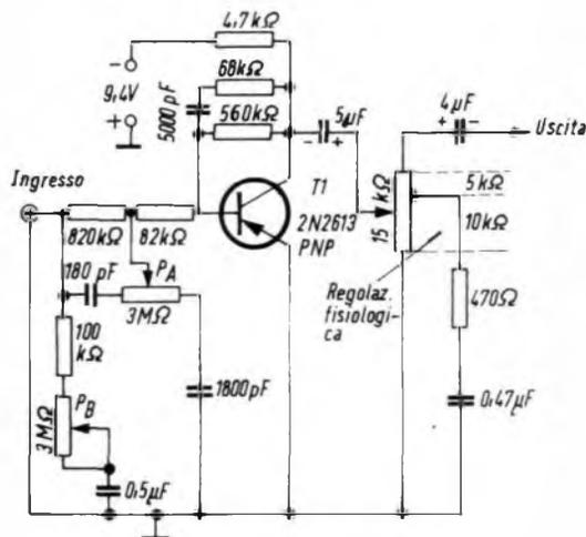
Fig. 4 - Esempio di circuito di tono a due regolazioni.
