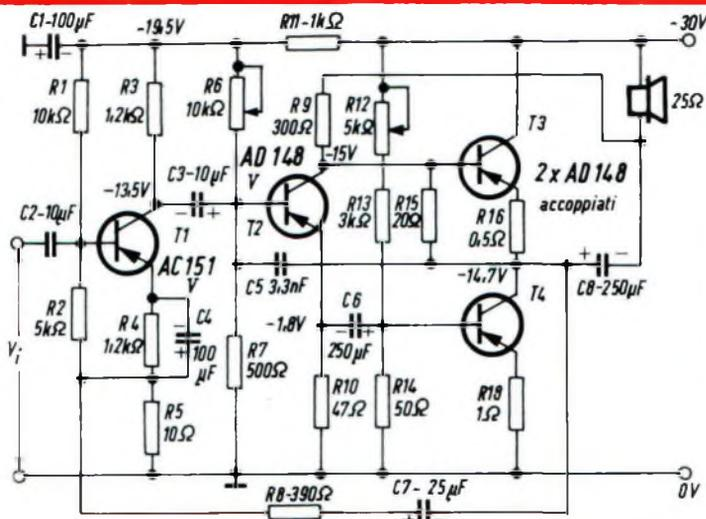
Fig. 4 - Schema elettrico di un amplificatore BF avente una potenza d'uscita di 4 W.
