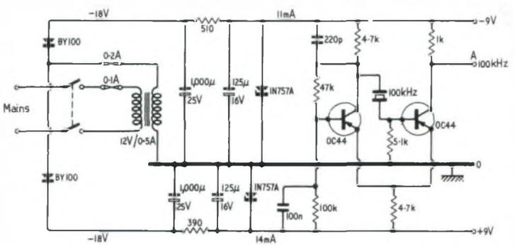
sione secondaria viene rettificata ad opera di due diodi, e filtrata opportunamente mediante una cellula di filtraggio che contiene anche un diodo zener che stabilizza il valore della tensione ottenuta. Il circuito oscillatore propriamente detto consta invece di due
