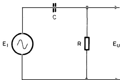
Fig. 2 - Circuito equivalente di una testina ceramica, rappresentata dalla capacità C.  $E_i$  rappresenta la tensione di ingresso fornita dalla testina, che funge da generatore di tensione alternata, R rappresenta la resistenza di carico, ed  $E_u$  la tensione di uscita disponibile ai capi del carico stesso.
