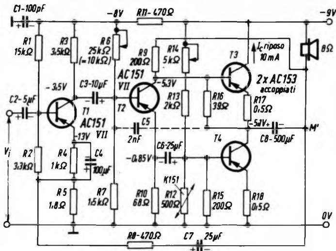
punto di funzionamento dei transistor finali è un po' più complicata che negli stadi finali abituali, in quanto il punto di funzionamento del transistor  $T_3$  viene regolato per mezzo di  $T_2$  mentre quello del transistor  $T_4$  viene regolato per mezzo del partitore di tensione posto sulla base.
