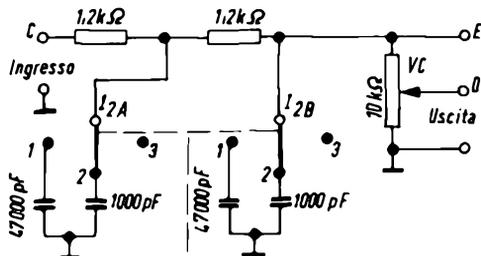
Fig. 6 - Circuito di filtro fisso.
