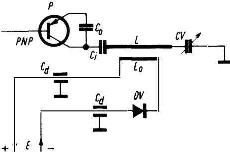
Fig. 6 - Circuito oscillatore UHF equipaggiato di un diodo a capacità variabile.
