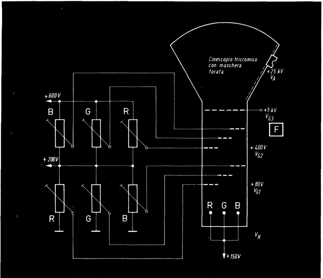
Fig. 5 - Regolazione delle tensioni dei vari elettrodi del cinescopio a maschera.
