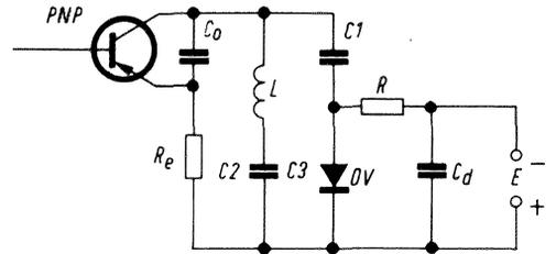
Fig. 8 - Circuito oscillatore UHF.
