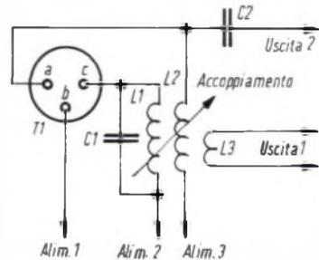
Fig. 2 - Circuito base illustrante il principio di funzionamento di un oscillatore.
