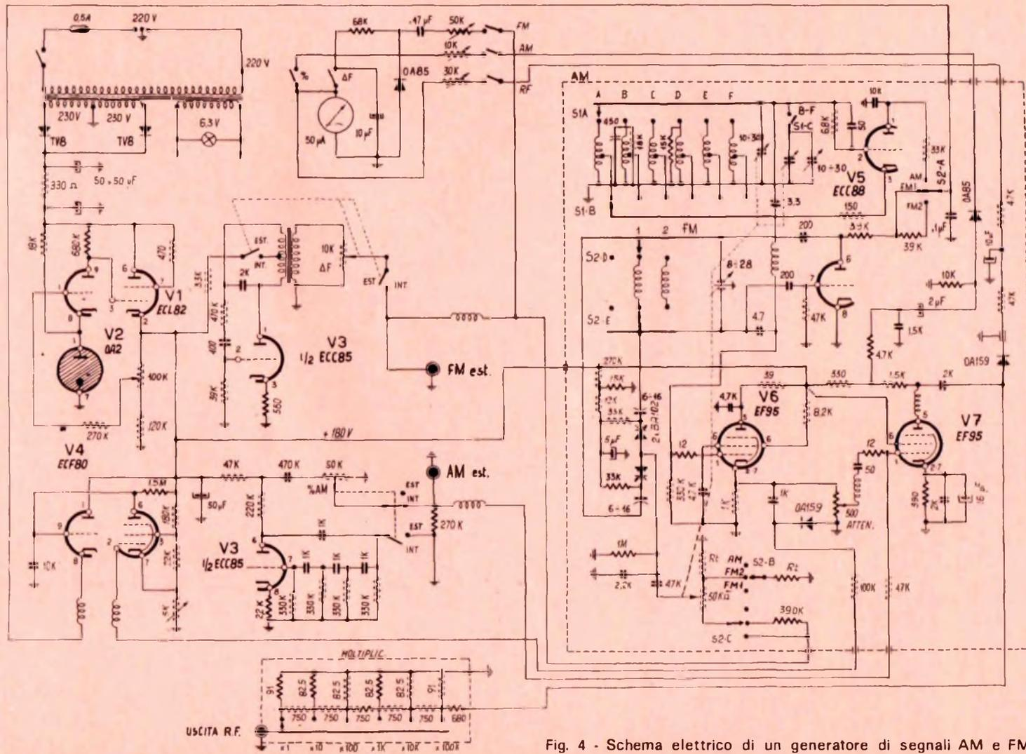
Fig. 4 - Schema elettrico di un generatore di segnali AM e FM.
