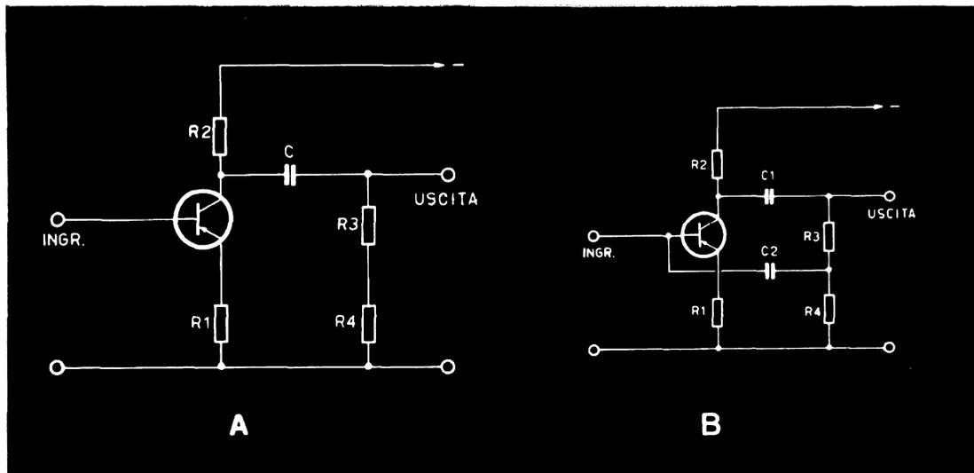
Fig. 7 - A rappresenta uno stadio di amplificazione convenzionale, nel quale il segnale di uscita si sviluppa ai capi di R2, e — quindi — anche ai capi di R3 - R4. In B, il segnale presente ai capi di R4, che presenta un determinato valore proporzionale rispetto ad R3, viene applicato all'ingresso dello stadio, tramite C2, per costituire il segnale di controreazione.
