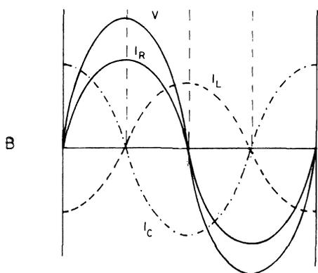
Fig. 5 - La tensione presente ai capi di un circuito in parallelo del tipo RLC è la medesima che viene fornita dalla sorgente. Per quanto riguarda invece la corrente totale che scorre, essa dipende dal valore resistivo di  $R$ , nonché dai valori intrinseci di  $L$  e di  $C$ , nonché dalle relazioni di fase che intercorrono tra le rispettive correnti, i cui valori debbono essere sommati algebricamente, prima di poter effettuare il calcolo in base alla legge di Ohm.
