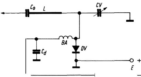
Fig. 7 - Circuito oscillatore con diodo a capacità variabile.
