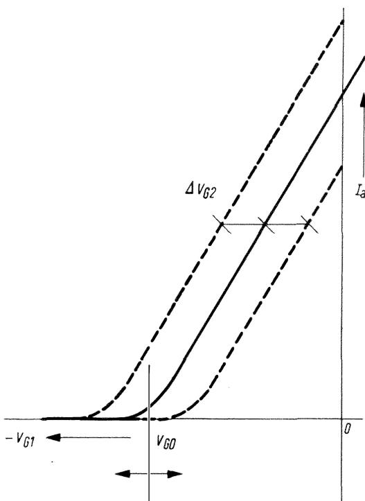
Fig. 6 - SCELTA DELLE CONDIZIONI DI FUNZIONAMENTO MEDIANTE REGOLAZIONE DEI POTENZIALI DI GRIGLIA  $V_{G1}$  E  $V_{G2}$ .
