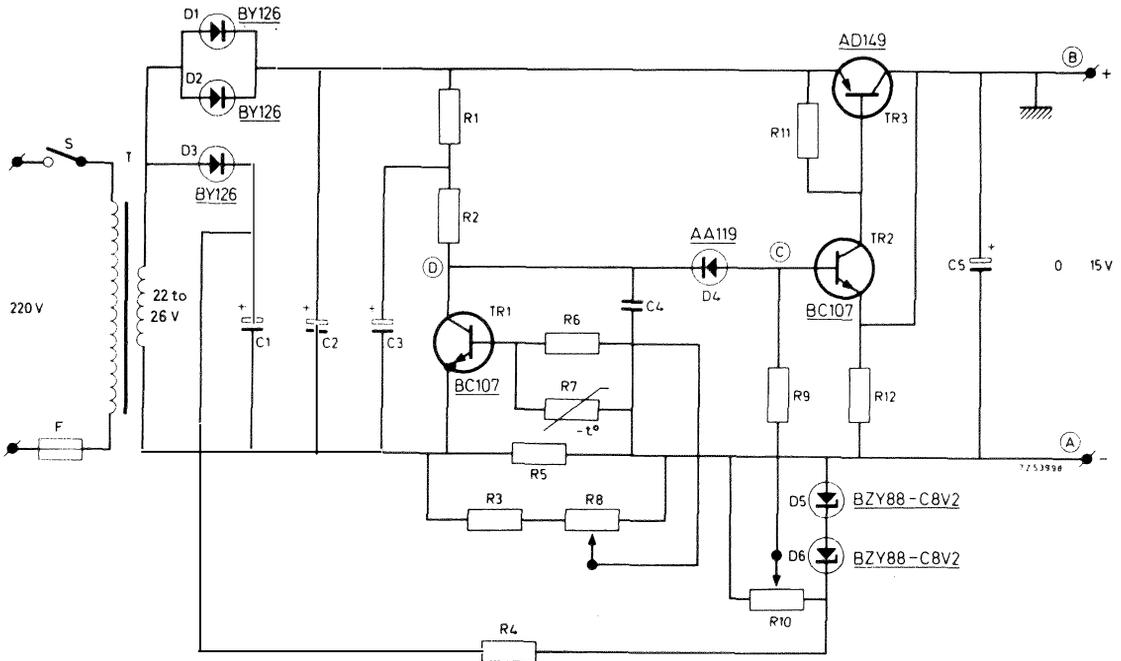
Fig. 1 - Schema elettrico dell'alimentatore stabilizzato.
