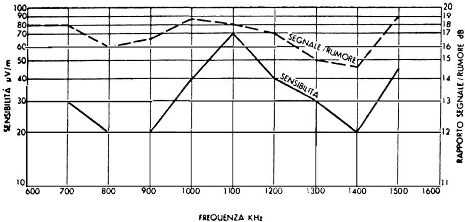
Fig. 2 - Andamento della sensibilità e del rapporto segnale/rumore in funzione della frequenza.
