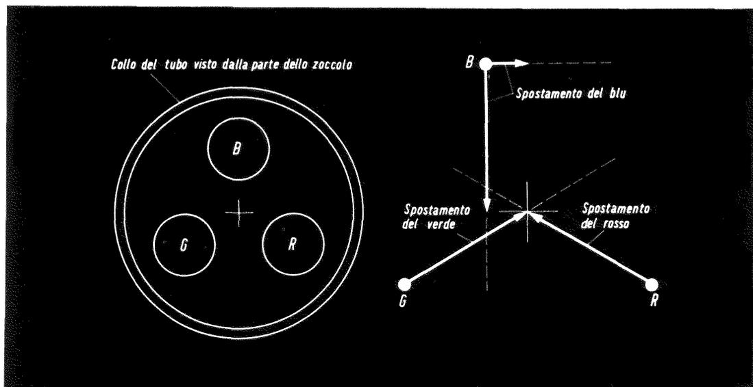
Fig. 9 - Direzione del movimento impresso ai tre pennelli elettronici per ottenerne la convergenza statica.
