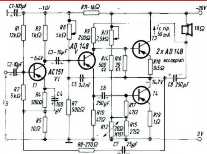
Fig. 5 - Schema elettrico di un amplificatore BF avente una potenza d'uscita di 6 W.
