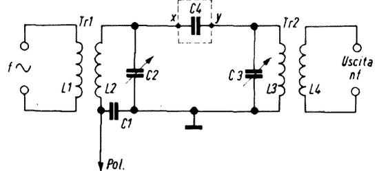
Fig. 11 - Circuito generatore di armoniche.
