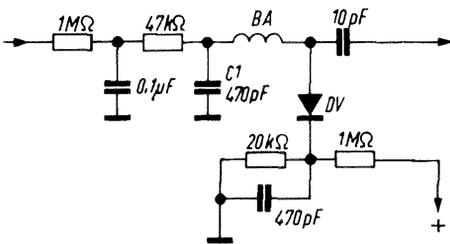
Fig. 10 - Esempio di impiego di un diodo a capacità variabile in un ricevitore FM.
