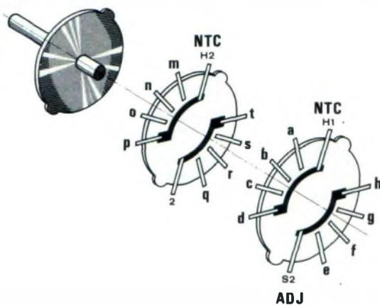
Fig. 4 - Vista in sezione del commutatore rotativo S1.
