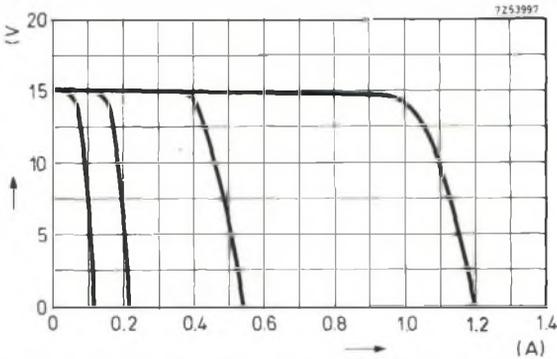
Fig. 2 - Curve caratteristiche tensione/corrente dell'alimentatore.
