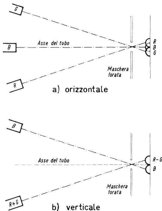
Fig. 8 - Inclinazione dei cannoni elettronici rispetto all'asse del tubo.
