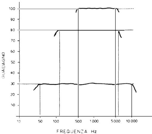
Fig. 9 - Grafico illustrante la variazione del guadagno e della larghezza di banda di un amplificatore, col variare del rapporto di controreazione adottato.
