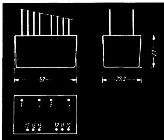
Fig. 2 - Dimensioni d'ingombro del modulo VCR-1.
