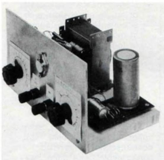
Fig. 6 - Realizzazione pratica dell'alimentatore.
