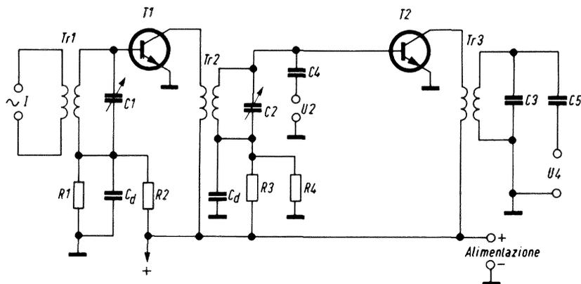
Fig. 12 - Circuito separatore-amplificatore che dà la possibilità di ottenere delle armoniche pari: 2° e 4°.
