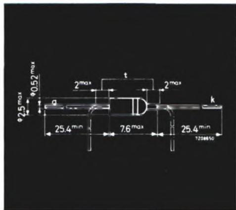
Fig. 4 - Dimensioni d'ingombro in mm del diodo Zener tipo BZY88.  $t =$  non stagnato.
