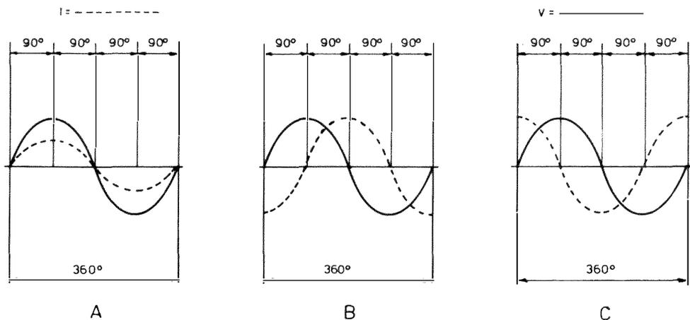
Fig. 1 - Rappresentazione grafica delle relazioni di fase che intercorrono tra tensione (in tratto continuo) e corrente (tratteggiata) in un circuito resistivo (A), in un circuito capacitivo (B), ed in un circuito induttivo (C). Nel primo caso, la corrente è in fase con la tensione: nel secondo essa è in ritardo di  $90^\circ$ , e nel terzo è infine in anticipo di  $90^\circ$ .
