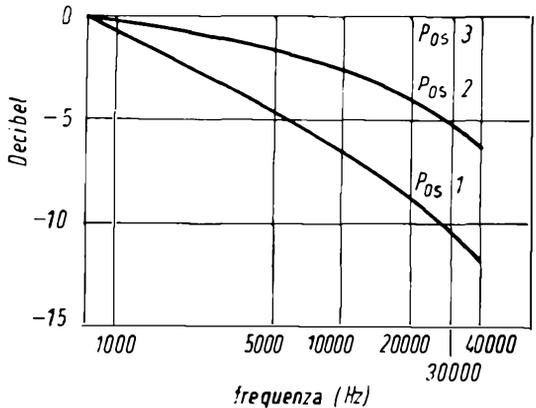
Fig. 7 - Curve illustranti l'effetto prodotto nelle tre posizioni del commutatore I<sub>2</sub>.
