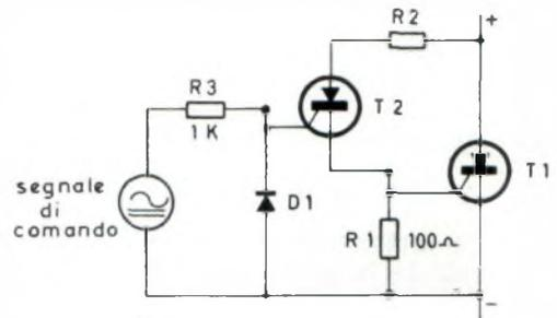
Fig. 1 - Comando di potenza di un motore universale.
