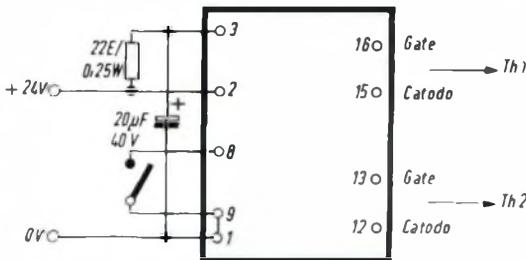
Fig. 2 - Schema di collegamento.
