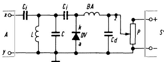
Fig. 1 - Esempio di circuito accordato, equipaggiato di un diodo a capacità variabile.
