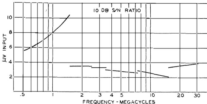
Fig. 1 - Curva di sensibilità del ricevitore professionale Collins 51-J-4.
