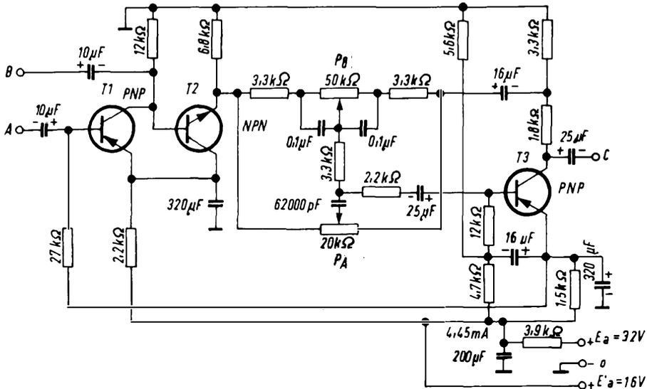
Fig. 3 - Esempio di circuito di tono provvisto di due regolazioni.
