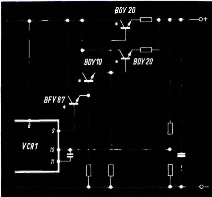
Fig. 4 - Modifiche dello schema precedente per correnti fino a 6 A.
