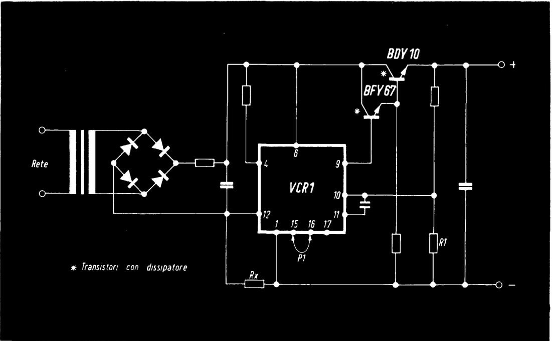
Fig. 3 - Esempio d'applicazione del modulo VCR-1. Alimentatore da rete 10  $\div$  30 V, 1 A con alimentazione elettronica della corrente erogata.
