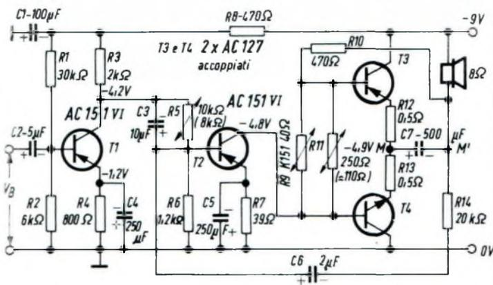
Fig. 6 - Schema elettrico di un amplificatore a tre stadi avente una potenza d'uscita di 1 W.
