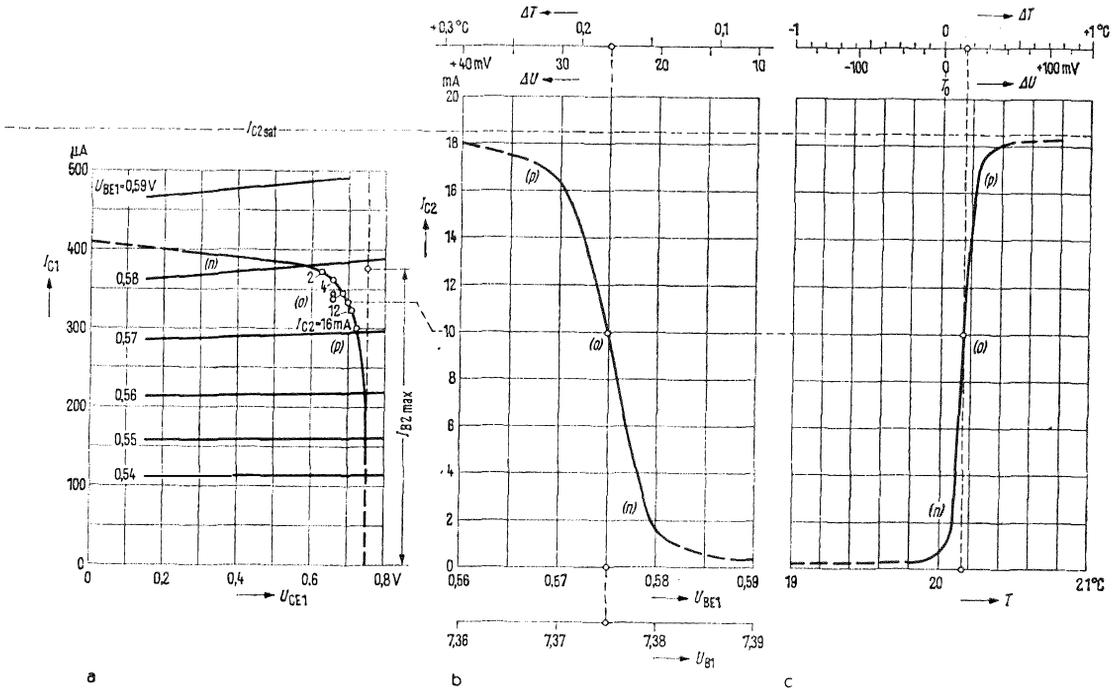
Fig. 4 - Caratteristiche di lavoro dello stadio a relé e sua rappresentazione.
