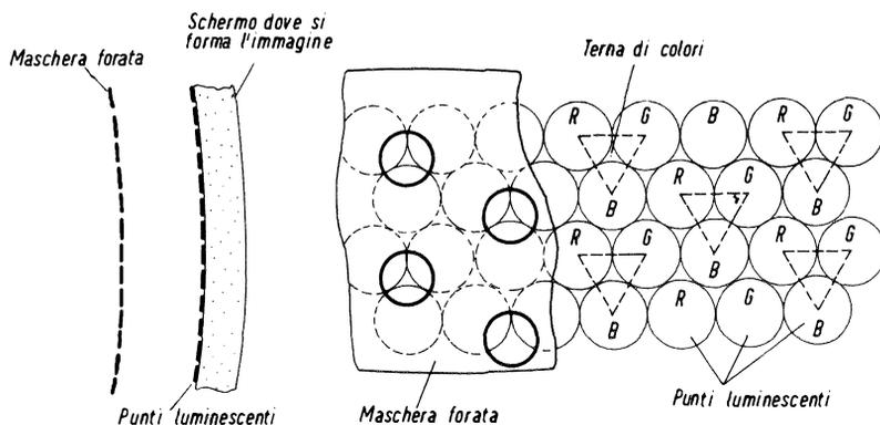
Fig. 2 - Posizione della maschera rispetto alle triadi. - Le triadi sono piccole aree circolari di fosforo rosso, verde e blu, disposte ai vertici di un triangolo equilatero.
