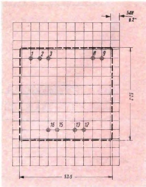
Fig. 1 - Disposizione delle uscite viste dal lato saldature.
