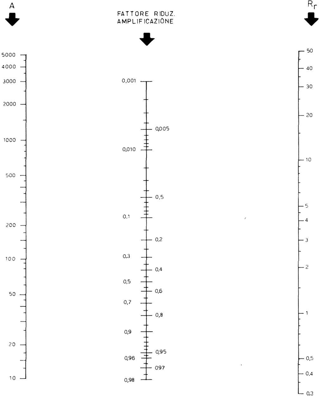
Fig. 11 - Abaco per il calcolo rapido della riduzione del guadagno di un amplificatore, in funzione del rapporto di controeazione. La retta che unisce il guadagno unitario senza controeazione (colonna A) ed il valore del rapporto di controeazione (colonna  $R_r$ ), individua sull'asse centrale il fattore di riduzione del guadagno risultante.
