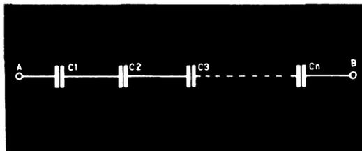
Fig. 3 - Quando due o più capacità vengono collegate in serie tra loro, il valore capacitivo risultante è sempre inferiore a quello della capacità di minor valore presente nel circuito in serie.
