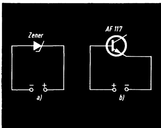
Fig. 2 - Protezione shunt di uno strumento con un diodo a polarizzazione inversa: a) diodo Zener a bassa tensione; b) diodo emettitore-base di un transistor a diffusione.
