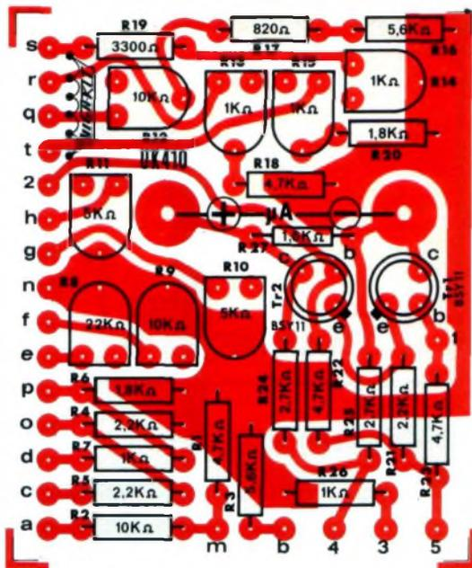
Fig. 3 - Disposizione dei componenti sulla piastra a circuito stampato.
