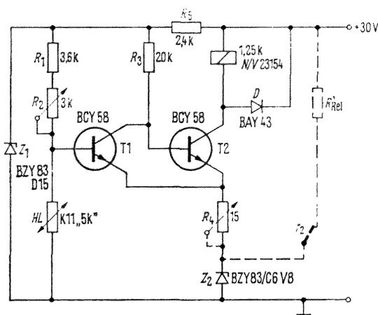
Fig. 2 - Schema del regolatore per apparecchiature di riscaldamento di ambienti.
