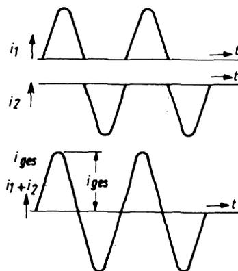
Fig. 2 - Curve che rappresentano la corrente alternata misurata all'uscita di un amplificatore classe B senza trasformatore.
