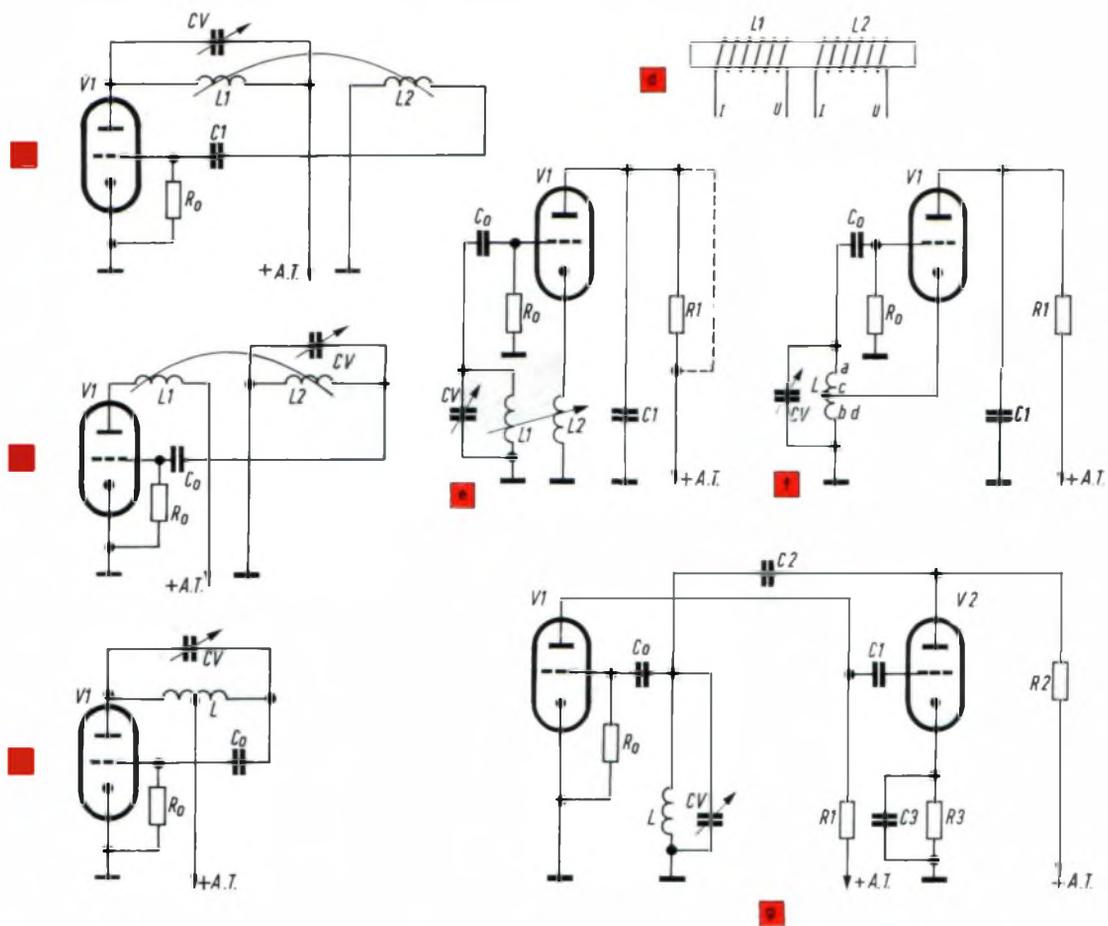
Fig. 1 - Alcuni circuiti di principio di oscillatori equipaggiati a valvole.
