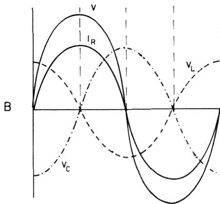
Fig. 4 - L'intensità della corrente che scorre in un circuito in serie del tipo RLC è di un unico valore, mentre la caduta di tensione presenti ai capi dei tre componenti dipendono dai relativi valori di resistenza e di reattanza. In particolare, la differenza di potenziale presente ai capi dei componenti  $L$  e  $C$  dipende dalla relazione di fase tra le rispettive correnti. A rappresenta il circuito tipo, e B illustra appunto le relazioni di fase di un caso ipotetico.
