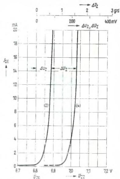
Fig. 5 - Caratteristiche per la tensione di Zener del diodo Zener BZY 83 D 15.
