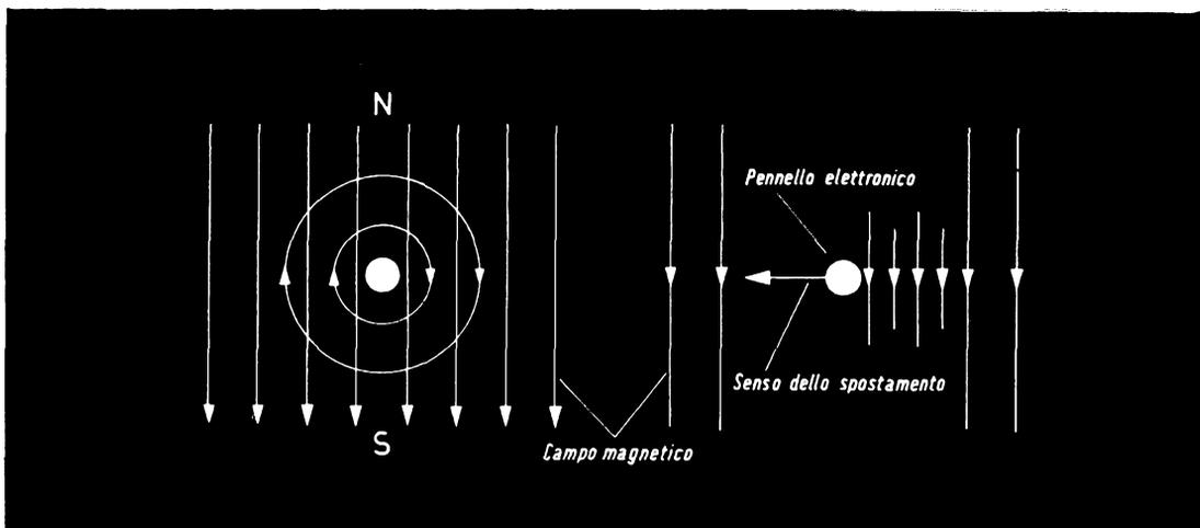
Fig. 10 - Deflessione di un pennello elettronico da parte di un campo magnetico.
