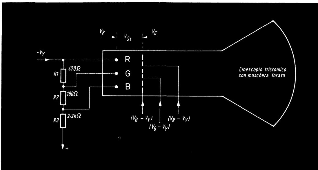
Fig. 7 - Tensioni di controllo per i tre cannoni dei colori primari di un cinescopio tricolore a maschera.
