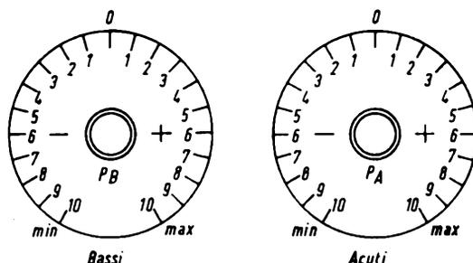
Fig. 2 - Esempio di disposizione dei due potenziometri dei bassi e degli acuti.
