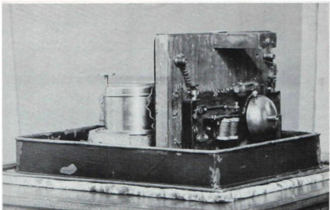
**Fig. 8 - Sopra:** Apparecchio ricevente di A.S. POPOV, anno 1895 (l'esemplare autentico è conservato presso il Museo Centrale del collegamento dedicato allo scienziato russo). **Fig. 9 - Sotto:** Apparecchio per la rivelazione e la registrazione delle oscillazioni elettriche atmosferiche del POPOV (estate 1896).
