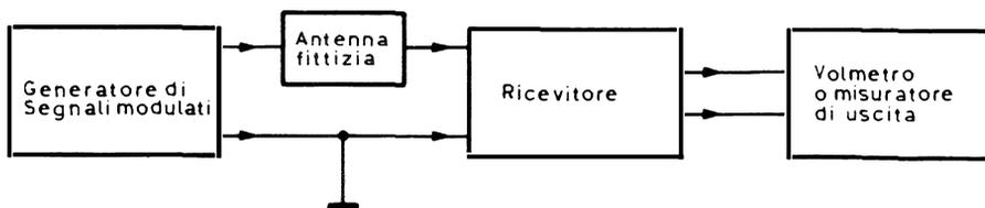
Fig. 3 - Disposizione degli strumenti per la misura della sensibilità.
