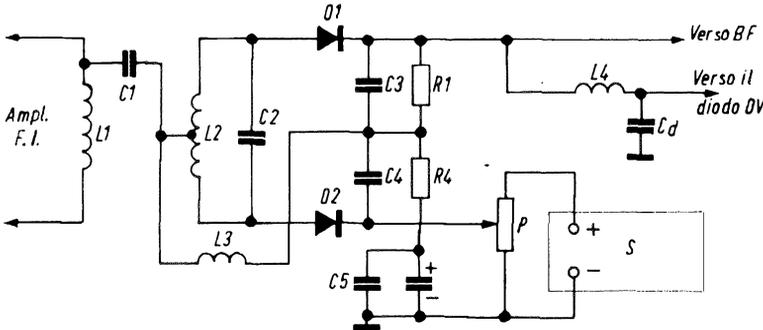
Fig. 9 - Composizione di un circuito discriminatore equipaggiato di due diodi
