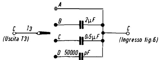
Fig. 8 - Esempio di circuito di filtro a tre ingressi diversi.
