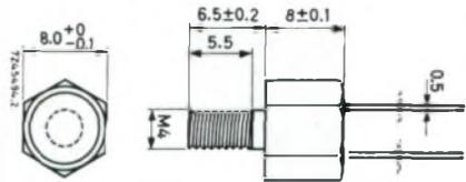
Fig. 3 - Tipo speciale di termistore NTC per montaggio su un dissipatore, con relative dimensioni d'ingombro.
