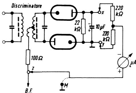
Fig. 1 - Esempio di circuito di rivelazione equipaggiato con due diodi a vuoto.
