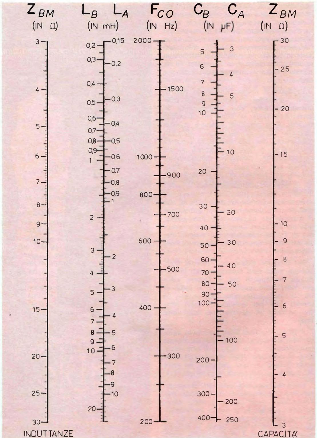
Fig. 5 - Grafico per il calcolo rapido dei valori di  $C_A$ ,  $C_B$ ,  $L_A$  ed  $L_B$ , per realizzare filtri « crossover » del tipo di cui alla figura 4.
