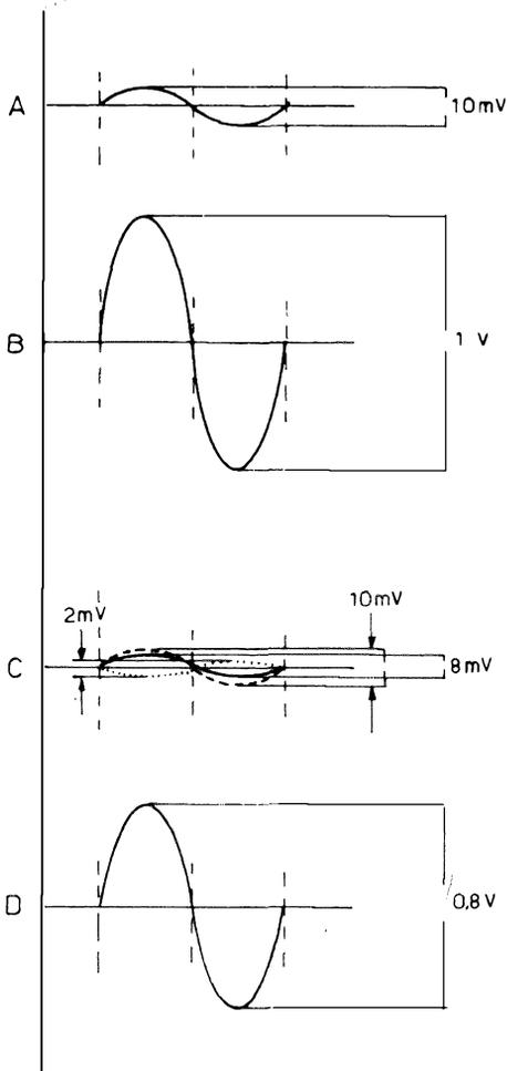
Fig. 8 - Rappresentazione grafica di ciò che accade con e senza controreazione, nel circuito di cui alla figura 7. A e B rappresentano rispettivamente i segnali di ingresso e di uscita senza controreazione, mentre C rappresenta la variazione del segnale di ingresso dovuta all'applicazione del segnale di controreazione, e D il segnale di uscita risultante, che presenta un'ampiezza ridotta rispetto a B, proprio a causa della controreazione.
