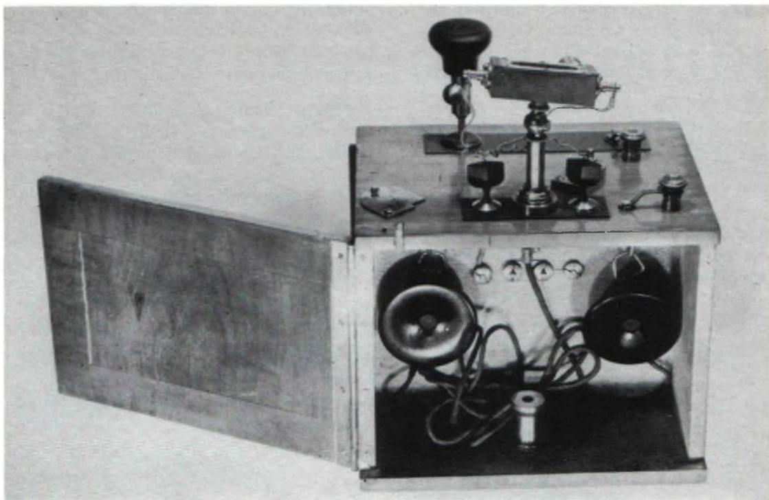
Fig. 11 - Apparecchio ricevente radiotelegrafico realizzato nell'anno 1899 da POPOV e dal Dukrete (brevetto russo 6066 del 14 Giugno 1899, brevetto francese 296354 del 22 Gennaio 1900, brevetto inglese 2797 del 12 Febbraio 1900).
