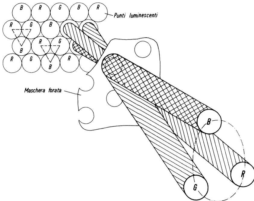
Fig. 3 - Orientamento dei tre fascetti elettronici verso le rispettive aree elementari dei fosfori ottenuto mediante la maschera forata.
