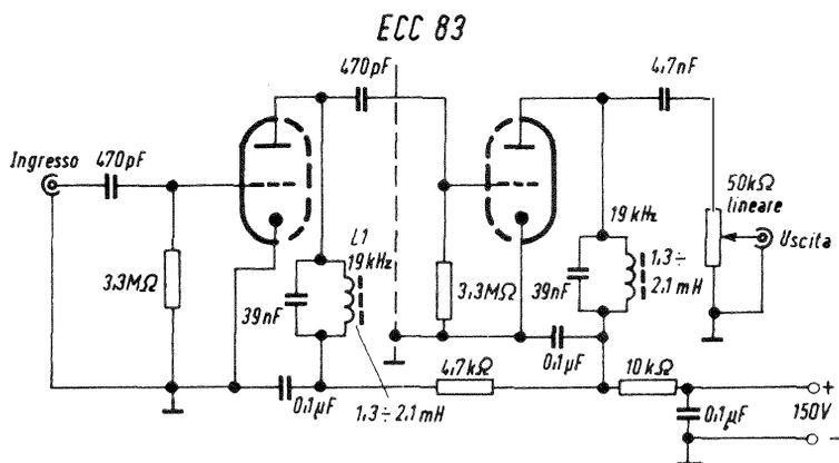
Fig. 3 - Circuito amplificatore a 19 kHz equipaggiato con un doppio triodo.
