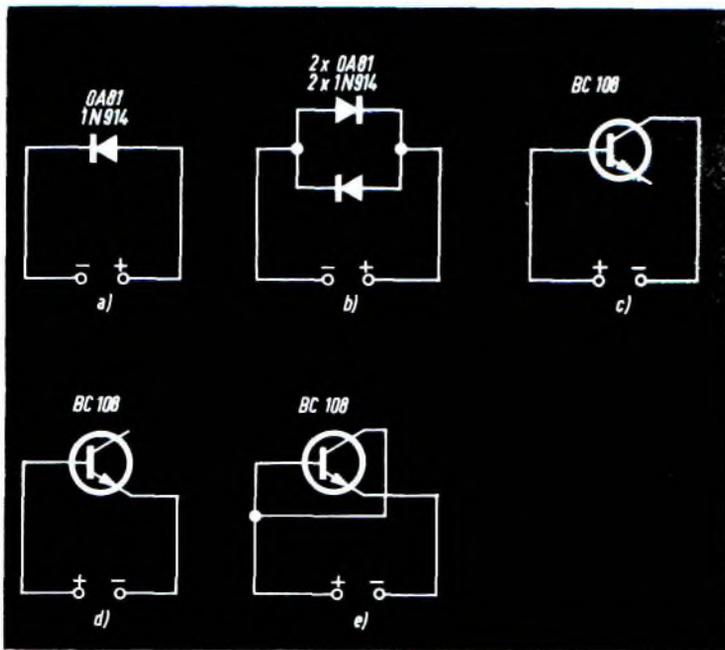
Fig. 1 - Protezione shunt con un diodo a polarizzazione diretta di strumenti a bobina mobile: a) diodo singolo per sovraccarico diretto; b) doppio-diodo (per sovraccarichi diretti o inversi); c) transistor con la giunzione collettore-base usata come diodo; d) transistor con la giunzione emettitore-base usata come diodo; e) transistor con il collettore e la base collegati insieme.
