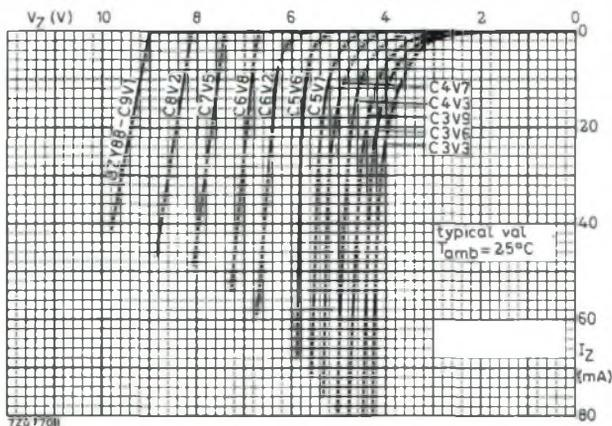
Fig. 5 - Caratteristiche statiche dei diodi Zener BZY88.
