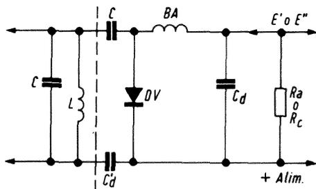
Fig. 5 - Circuito a diodo a capacità variabile pilotato con una tensione positiva.
