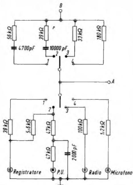
Fig. 5 - Circuito d'ingresso che permette il collegamento simultaneo di diverse sorgenti.
