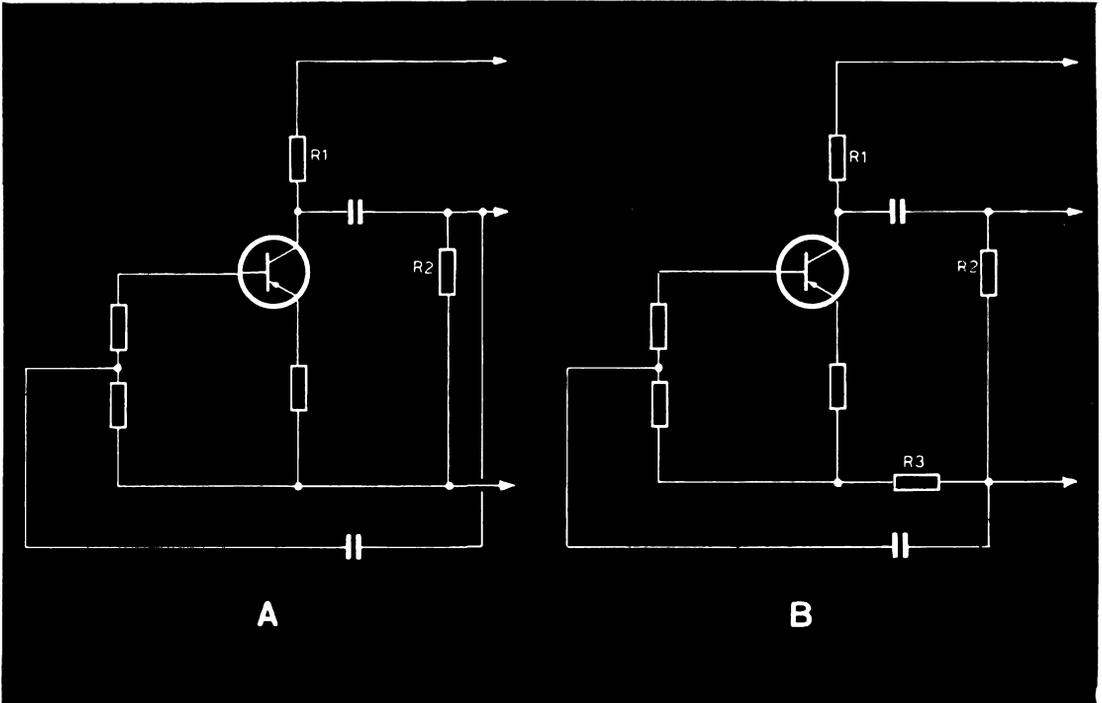
Fig. 6 - A rappresenta un caso tipico di reazione negativa di tensione, applicata tra l'uscita e l'ingresso di uno stadio a transistore, tramite un accoppiamento capacitivo. In B, le variazioni del segnale di reazione sono proporzionali alla variazione dell'intensità della corrente che scorre attraverso  $R_2$  ed  $R_3$ , per cui la reazione applicata è del tipo di corrente anziché di tensione.
