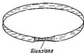
Fig. 3 - Metodo di giunzione di un nastro per ottenere un anello senza fine.
