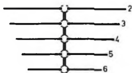
Fig. 8 - Antenna con elementi progressivamente crescenti.
