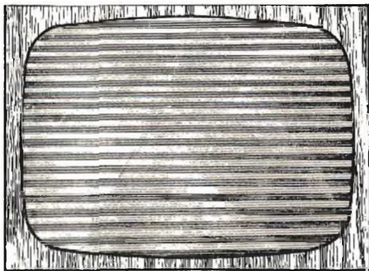
Fig. 3 - Esempio di barre orizzontali ottenibili sullo schermo del cinescopio quando alla base dello stadio di amplificazione video viene applicato un segnale rivelato di Bassa Frequenza. Tali barre orizzontali possono essere ottenute se la frequenza del segnale di modulazione è un multiplo di 50 Hz.
