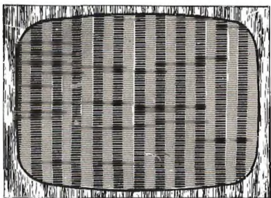
Fig. 4 - Aspetto delle tipiche barre verticali che è possibile ottenere sullo schermo del cinescopio quando all'amplificatore video vengono applicati dei segnali di Bassa Frequenza aventi una frequenza multipla del valore di 15.625 Hz.
