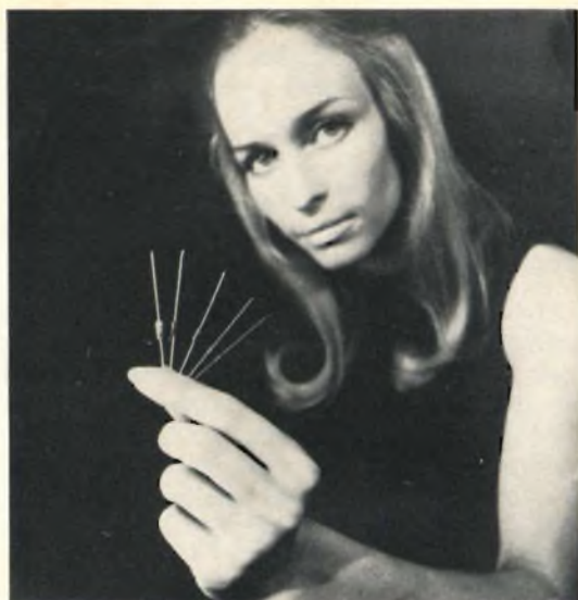
Fig. 15 - Fra i nuovi diodi al silicio presentati dalla « ITT » vi erano i tipi BA 243 e BA 244 destinati a sostituire i commutatori meccanici nei tuners TV.
