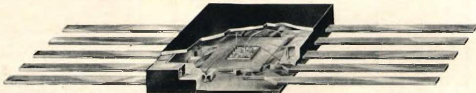
Fig. 11 - Spaccato di un flat package.
