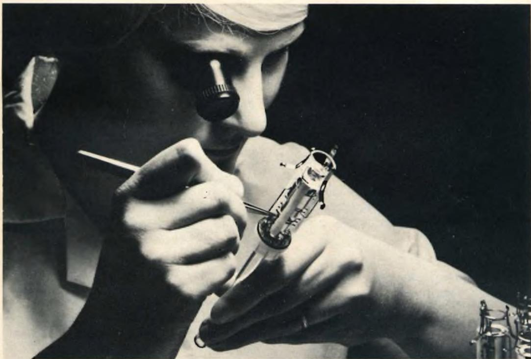
Questo è uno dei 500 controlli di qualità che assicurano la perfetta affidabilità dei 625 cannoni elettronici BRIMAR. Ciascuno di questi cannoni, impiegati nei tubi a raggi catodici BRIMAR, presenta 15 saldature attentamente controllate. Le saldature dubbie vengono sottoposte ad ulteriore prova individuale con pinzette a molla.
