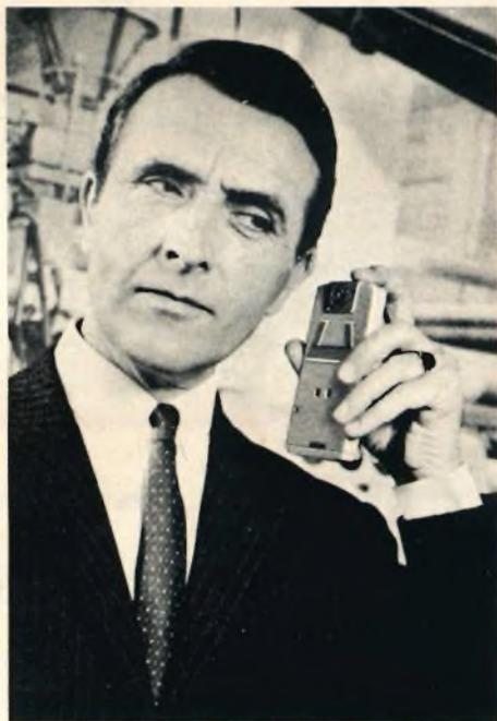
La trasmissione immediata dell'ordine o del messaggio in fonia raggiunge l'interessato attraverso un ricevitore tascabile transistorizzato.
