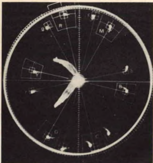
Fig. 7 - Come appare il rilievo oscillografico ricavato dal generatore tes. G.B. 668.
