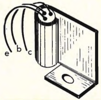
Fig. 5 - Come si devono piegare i terminali del transistor TR3 per il fissaggio sul diapason.
