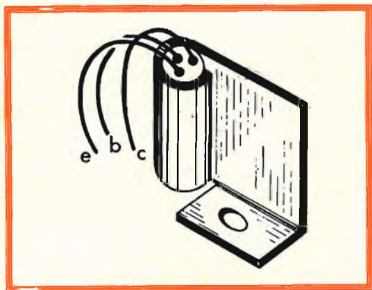
Fig. 3 - Disposizione del transistor TR 3 nel dissipatore.
