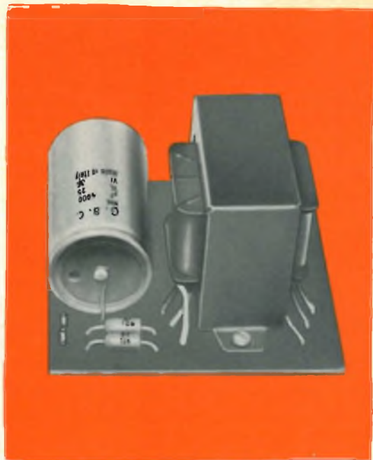
Fig. 3 - Aspetto dell'alimentatore UK 610 a montaggio ultimato.
