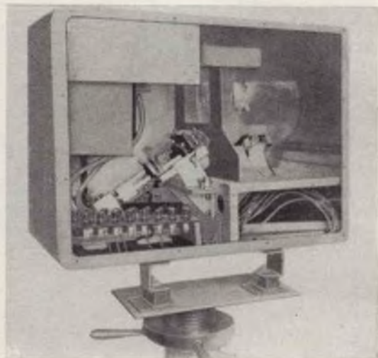
Fig. 7 - Una telecamera con l'iconoscopio realizzata nel 1936 dal russo V.K. Zworykin (Philips).
