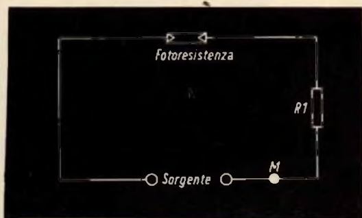
Fig. 3 - Circuito di base di una fotoresistenza.
