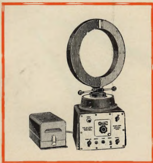
Fig. 7 - Radiogoniometro a valvole del surplus americano VS-NAV-M.
