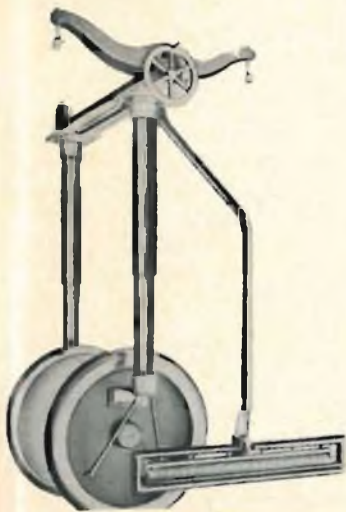
Fig. 1 - Voltmetro elettrostatico SCHROEDER per misure in c.c. e c.a. fino a 500 kV 10 MHz adatto anche per misure di radiologia elettroterapia.
