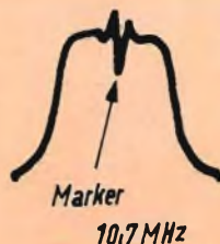
Fig. 7 - Marcatura della curva di selettività con l'aiuto di un generatore R.F.
