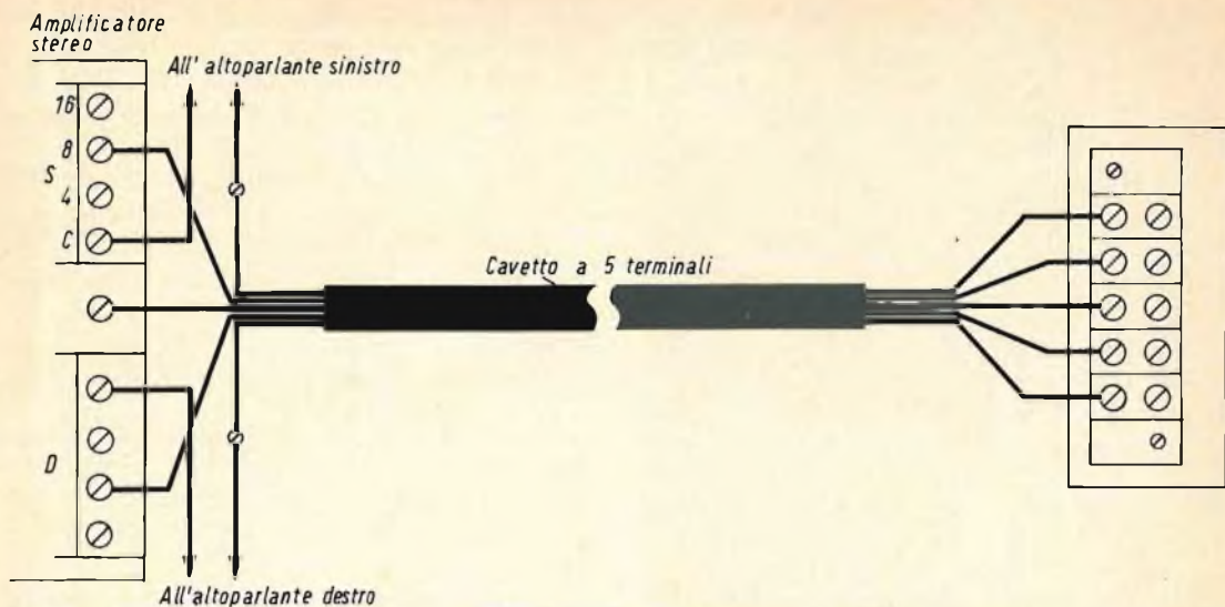
Fig. 2 - Per evitare perdite di potenza indesiderabili nei collegamenti degli altoparlanti, si deve evitare di usare un cavo di lunghezza maggiore di 70-80 cm.
