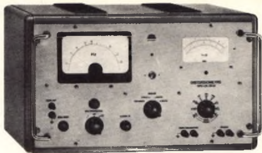
Fig. 8 - Distorsiometro UNAOHM - CS 24 A per la misura della distorsione fino a 0,1% - Campo di frequenza 20 - 20.000 Hz.
