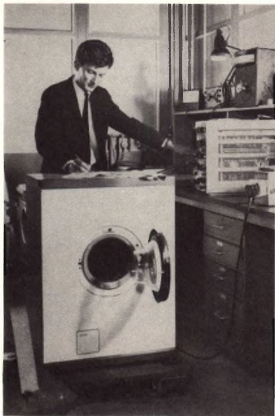
Fig. 1 - Si sta controllando un sistema a tiristore per controllare la velocità di un motore di una lavatrice.
