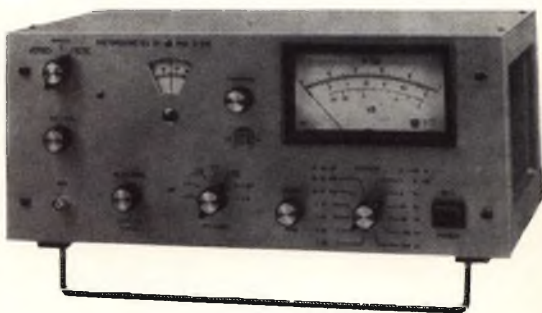
Fig. 9 - Distorsiometro-Voltmetro elettronico TES, a transistor. Distorsione da 0,05 a 100%, frequenze da 16 Hz a 55 \mu\text{Hz} .
