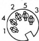
Fig. 6 - Prese per alimentazione esterna. Vista lato pannello.
