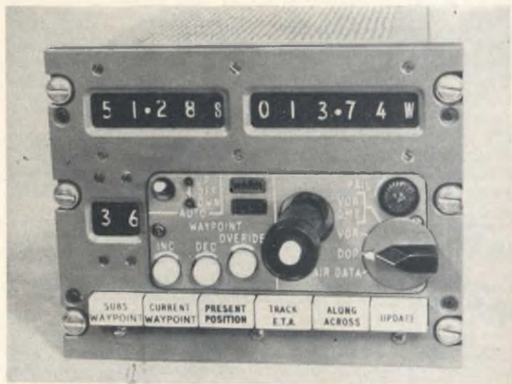
Fig. 7 - Controllore-calcolatore elettronico per la navigazione aerea Marconi AD 670.
