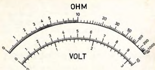
Fig. 5 - Aspecto della scala graduata che occorre tracciare in base alla tabella 2, per ottenere la lettura diretta su tutte le portate consentite dallo strumento.
