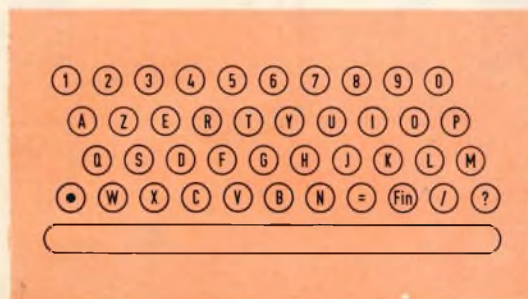
Fig. 6 - Tastiera tipo francese per il perforatore di nastri HELL-TL1.
