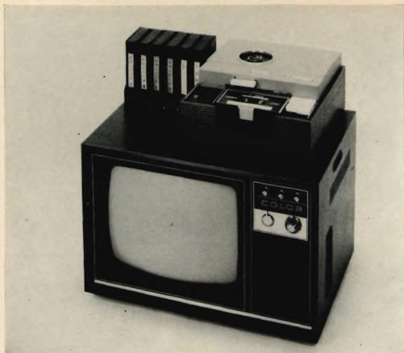
Fig. 4 - Una disposizione lineare della nastroteca e del riproduttore video a colori SONY sul mobile di un televisore a colori da 19".
