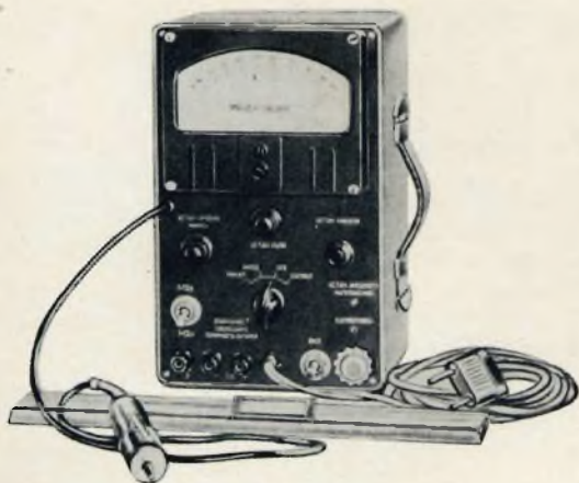
Fig. 8 - Modulometro sovietico tipo IM-21 da 0,15 a 2000 KHz. Errore massimo di calibrazione \pm 2\% .
