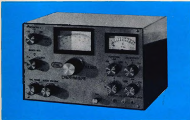
Fig. 7 - Ricevitore per gamme radiantistiche RX - 682 - Everywhere, completamente transistorizzato.
