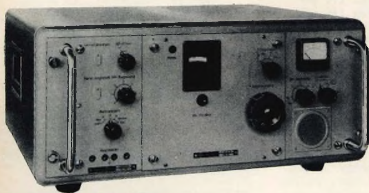
Fig. 4 - Vista frontale del ricevitore VHF Telefunken E 149 UK/1 per la gamma 65-175 MHz.
