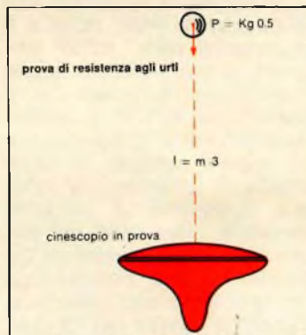
Fig. 13 - Prova di resistenza agli urti di un cinescopio.
