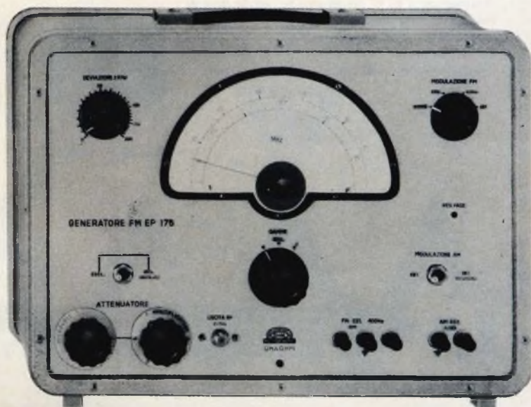
Fig. 9 - Generatore di segnali UNAOHM FM - EP175 da 86 a 108 MHz (e da 9,5 a 12 MHz per controllo delle medie frequenze), con deviazione regolabile da 0 a \pm 200 kHz e modulazione di ampiezza con profondità del 30%. Precisione dell'indicazione di frequenza \pm 1\% .
