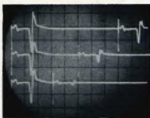
Fig. 15 - Oscillogramma relativo alla determinazione della risposta del riflesso H, ottenuto con l'elettromiografo HP-1510 A.
