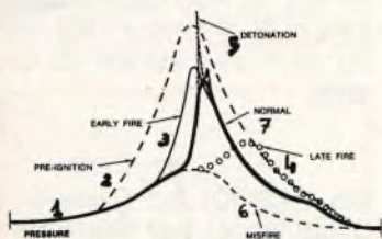
Fig. 13 - Diagramma di accensione di un motore a scoppio ricavato con il sistema Tektronix. Curve: 1 pressione, 2 pre-ignizione, 3 accensione anticipata, 4 accensione ritardata, 5 detonazione, 6 accensione errata, 7 accensione normale.
