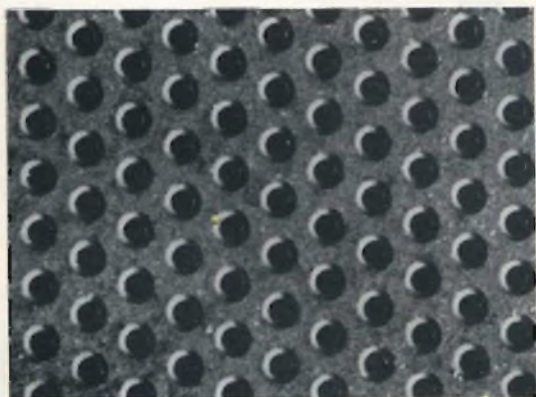
Fig. 3 - Come appare la maschera forata vista dalla parte dello schermo luminescente. L'ingrandimento è notevole.
