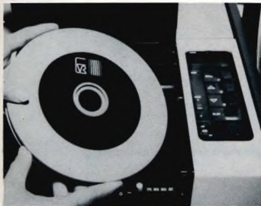
Fig. 4 - Cartuccia dell'EVR, diametro 17,78 cm, racchiude 52 min di registrazione video ed audio.
