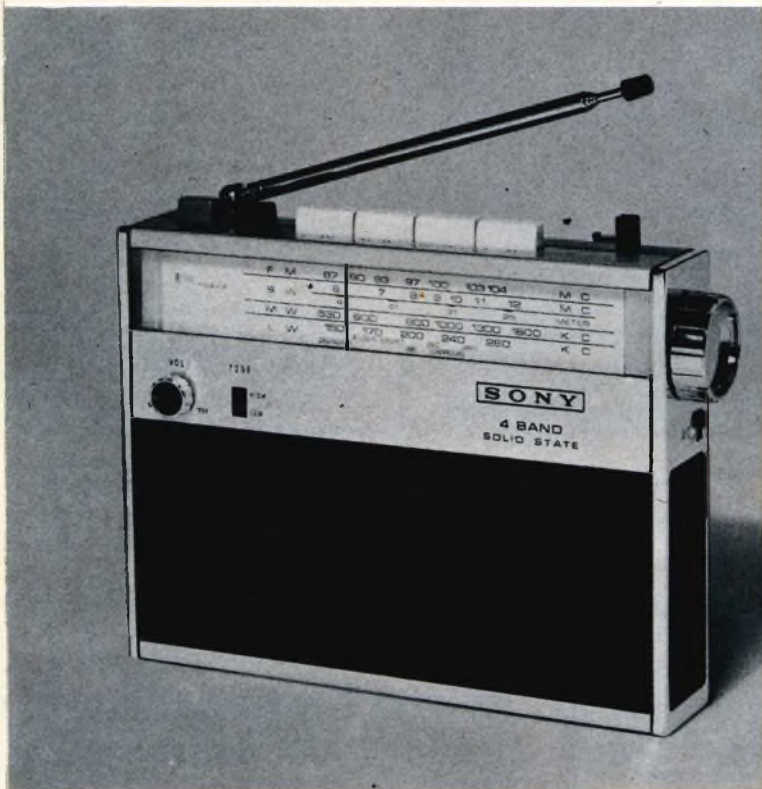
Fig. 1 - Ricevitore a transistor 5F-94L Sony (G.B.C.) di notevole sensibilità per onde lunghe, medie, corte (5,9-12 MHz) e FM 10 transistori più 5 diodi.
