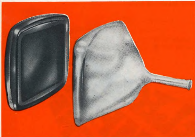
Fig. 2 - Parti componenti dell'ampolla. A sinistra, si vede lo schermo con inserita la maschera forata, a destra si vede la parte conica con il collo.
