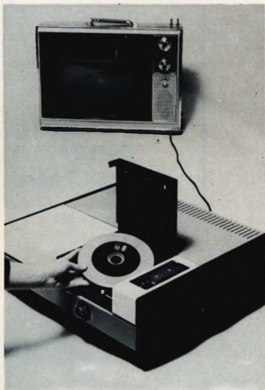
Fig. 2 - Un convenzionale circuito EVR, l'apparecchio è connesso al televisore con un semplice conduttore.
