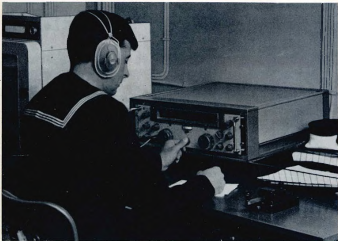
Fig. 6 - Ricevitore per bordo RACAL - RA1218 con indicatore di frequenza elettronica e copertura di gamma da 1 a 30 MHz.
