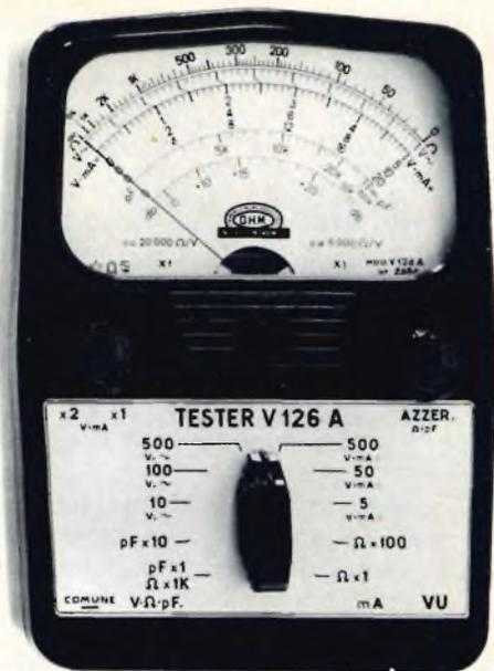
Sensibili, robusti e di facile impiego, i tester V 115AS e V 126AS consentono di effettuare qualsiasi misura di tensioni continue, alternate, di correnti continue, di resistenza, di capacità e di livelli di uscita. Le loro ridotte dimensioni di ingombro li rendono utili non solo in laboratorio, ma anche fuori sede per interventi e riparazioni sui più diversi apparati.
