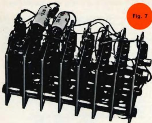
quando l'ingresso a « NOR 1 » è collegato sarà nello stato ON. Ma se aggiungiamo i nuovi collegamenti, un momentaneo ingresso in « NOR 1 » provocherà l'uscita da « NOR 2 » e parte di questa alimenterà nuovamente « NOR 1 » conservando indefinitamente l'uscita.
