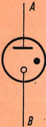
Fig. 1 - Simbolo del tubo al neon.
