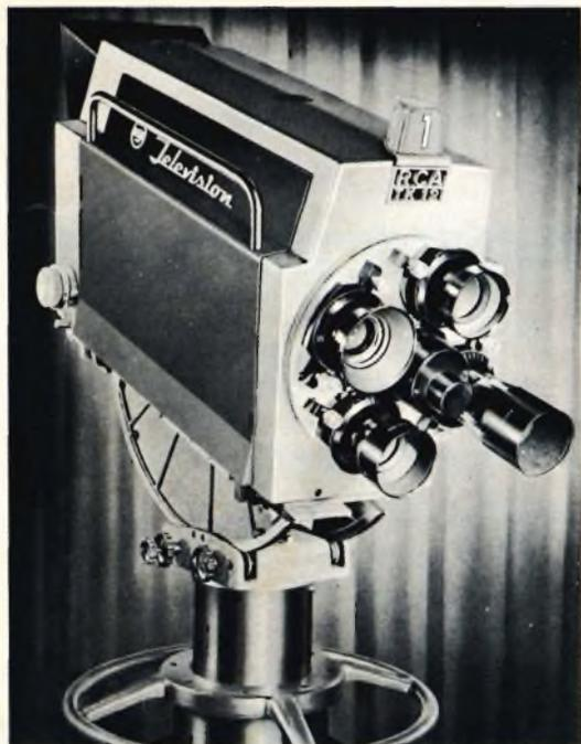
Fig. 3 - lens turret; torretta porta obbiettivi; tourrelle à lentilles, torre de lentes; Objektivrevolver.
