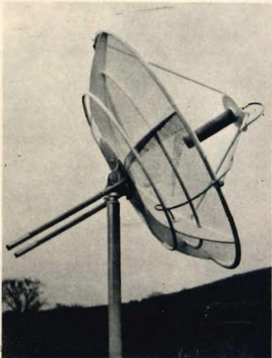
Fig. 8 - Antenna elicoidale TACO per microonde.
