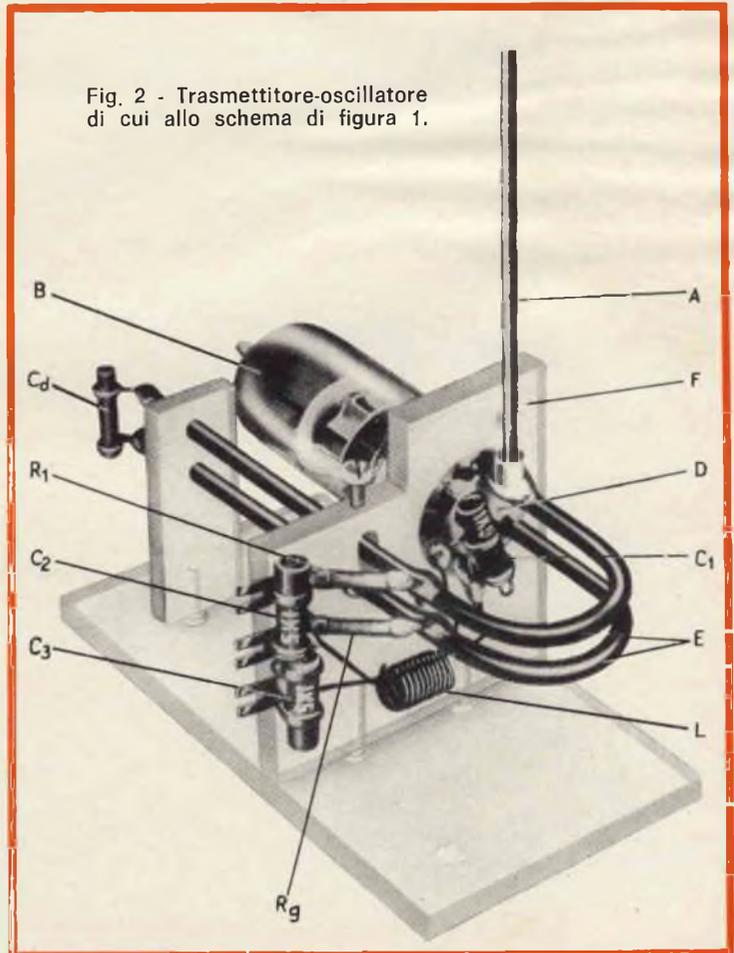
Antenna A: un'asta di rame della lunghezza di circa 300 mm e del diametro di due o tre millimetri.
