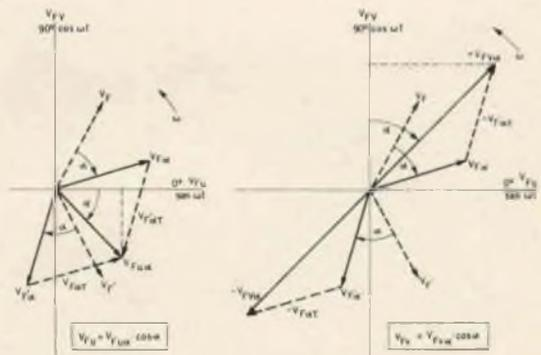
Fig. 12 - Dimostrazione vettoriale di ciò che avviene nei due stadi sommatore nel caso in cui il segnale di crominanza sia affetto da un errore di fase  $\alpha$ .
