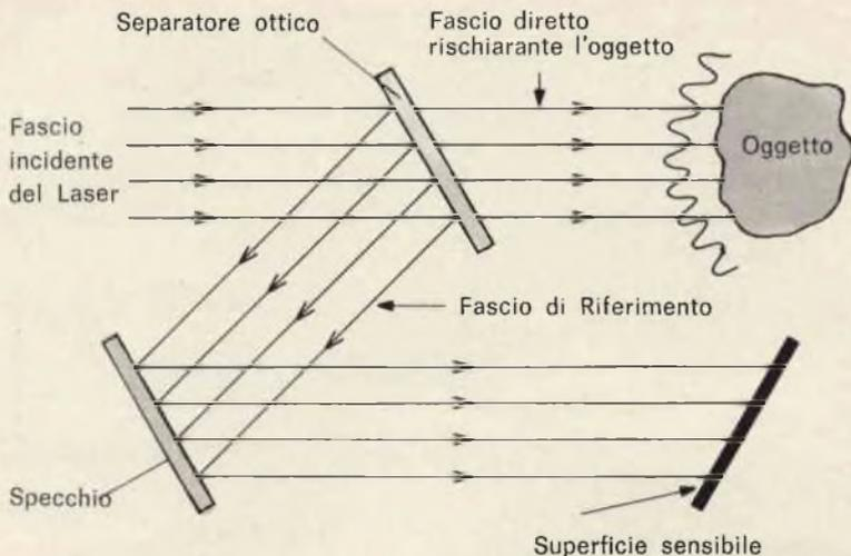
Fig. 1 - Un ologramma viene ottenuto mediante la registrazione di un'onda di riferimento e dell'onda riflessa dall'oggetto da fotografare.
