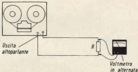
Fig. 4 - Circuito per la regolazione del livello. La resistenza R ha lo stesso valore dell'impedenza dell'altoparlante. Se l'impedenza dell'altoparlante è di 8 Ω, R sarà una resistenza di 8 Ω o due resistenze da 16 Ω in parallelo, ecc. Il livello sonoro regolato fra i 100 e i 200 mW sarà più che sufficiente.
