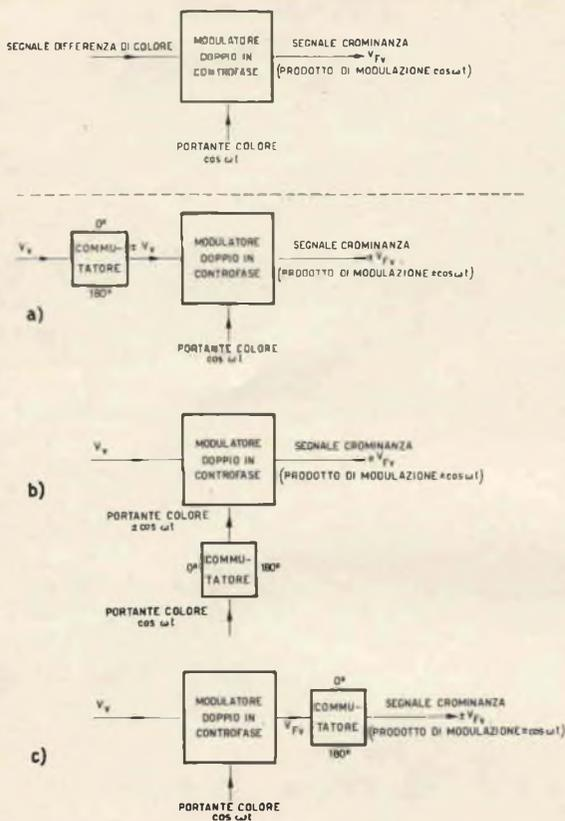
Fig. 9 - I tre possibili sistemi che possono essere impiegati al trasmettitore per invertire la polarità della componente di modulazione  $V_v$ .
