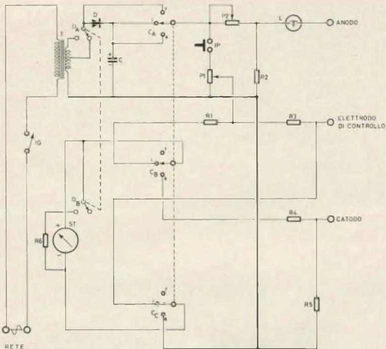
Fig. 1 - Circuito elettrico del dispositivo per la prova dei rettificatori controllati al silicio. Il circuito è quello fondamentale, ma potrà essere modificato ed adattato alle esigenze del costruttore.
