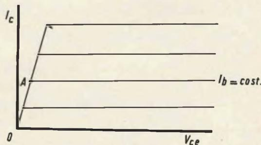
Fig. 5 - Caratteristiche  $I_c/V_{ce}$  di un transistor.
