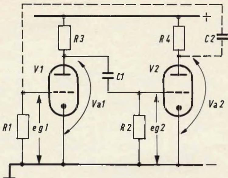
Fig. 7 - Schema elettrico di un amplificatore in cui le valvole sono accoppiate con circuiti RC.
