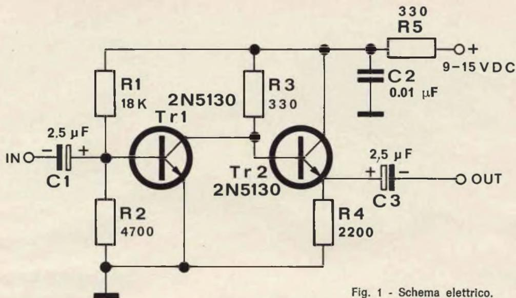
Fig. 1 - Schema elettrico.
