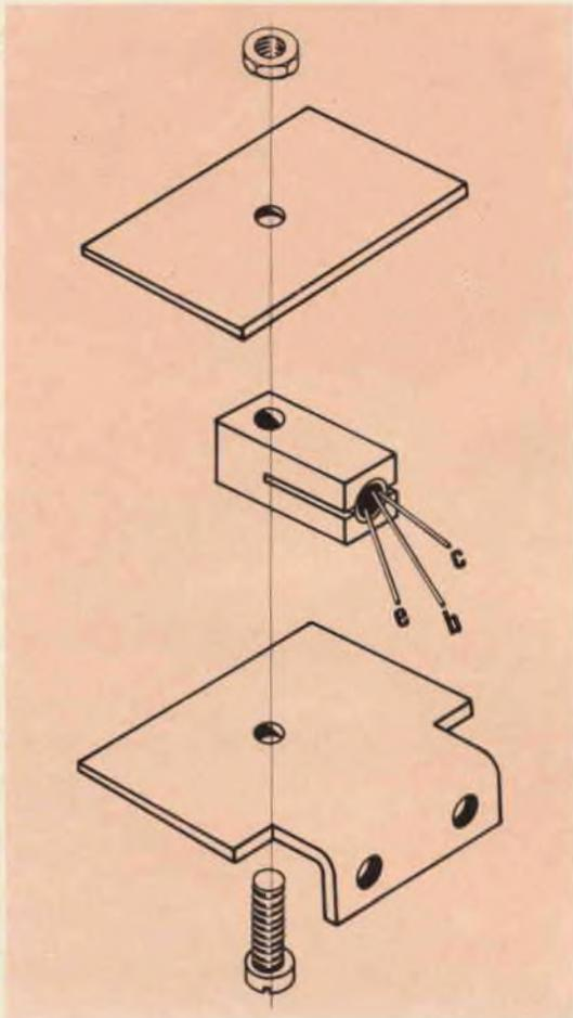
Durante la saldatura dei diodi è indispensabile evitare un eccessivo riscaldamento che potrebbe danneggiarli irrimediabilmente.
