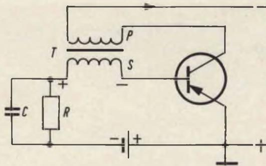
Fig. 1 - Esempio di circuito oscillatore bloccato a transistor.
