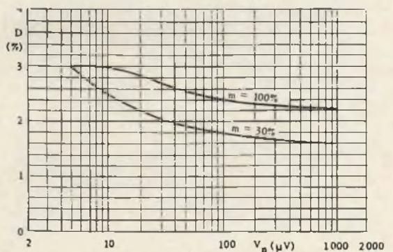
Fig. 9 - Curva della distorsione non lineare elettrica complessiva alle rivelazioni.
