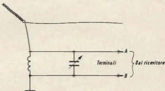
Fig. 4 - Antenna accordata per ricevitori AM.
