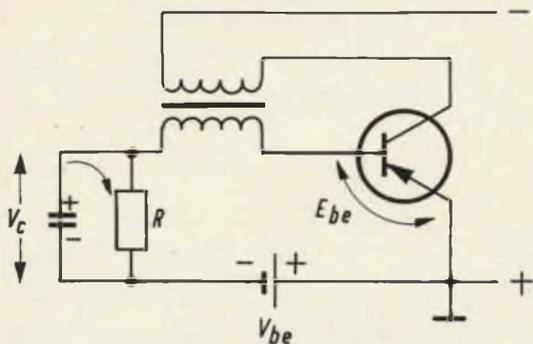
Fig. 2 - Andamento delle correnti nell'oscillatore bloccato.
