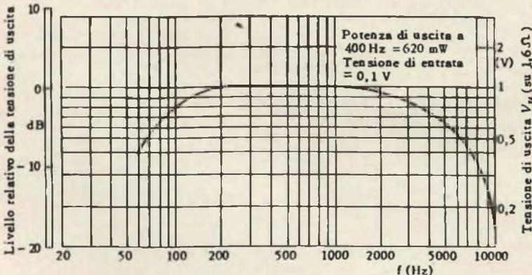
Fig. 3 - Curva di risposta elettrica di bassa frequenza di un ricevitore FM.
