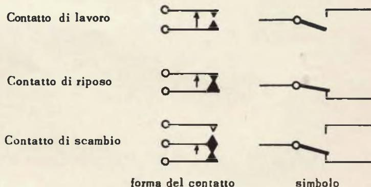
Fig. 8 - Contatti tipici di lavoro, di riposo e di scambio di un relé e relativi simboli.
