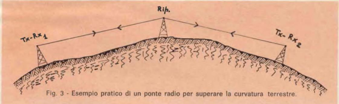
Fig. 3 - Esempio pratico di un ponte radio per superare la curvatura terrestre.
