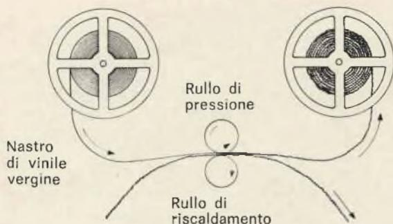
Fig. 5 - Realizzazione (molto schematizzata) del nastro-copia in vinile.
