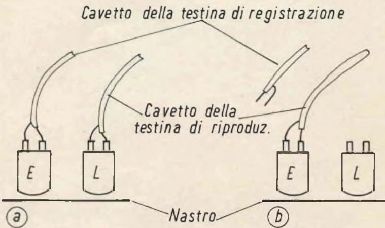
Fig. 5 - a) circuito originale; b) testina di registrazione usata come testina di riproduzione.
