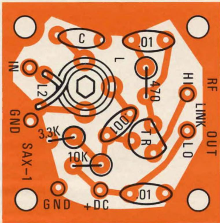
Fig. 3 - Serigrafia del circuito stampato. Nel caso si voglia realizzare un convertitore i punti indicati con HI e LO vanno collegati con i punti \* IN e \* GND del miscelatore.
