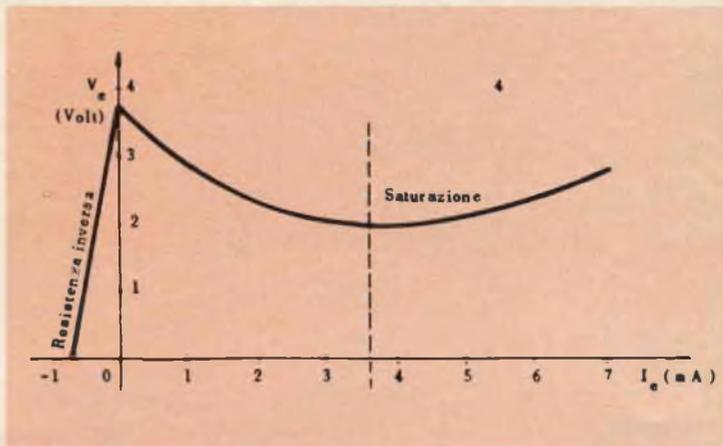
Fig. 13 - Curva caratteristica tensione-corrente di un transistor unigiunzione.
