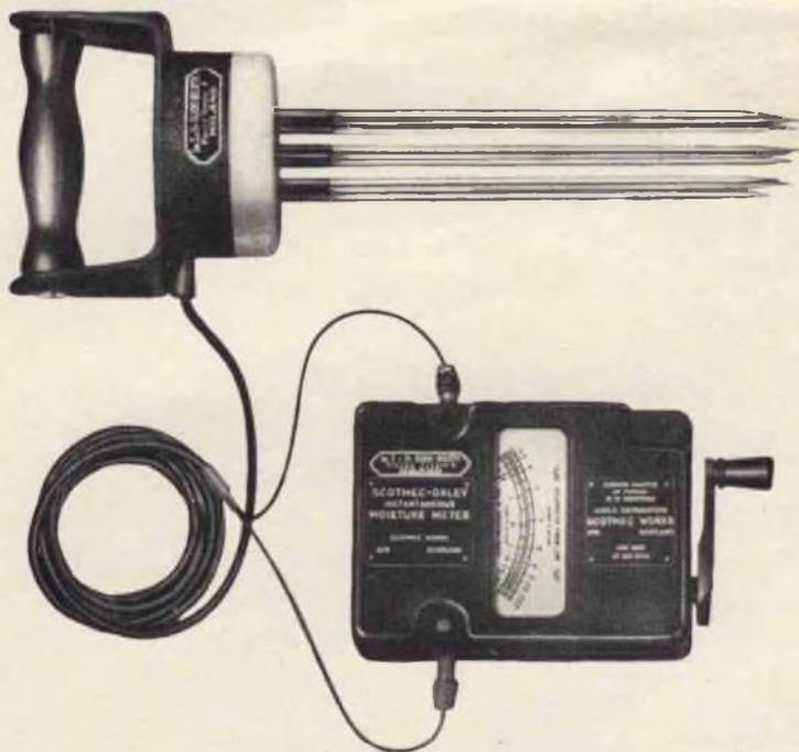
Fig. 10 - Misuratore portatile di umidità per cereali Scotmec-Oxley.
