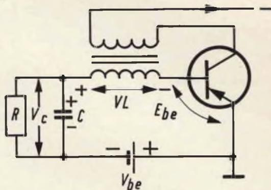
Fig. 4 - Polarità delle tensioni nell'oscillatore bloccato.
