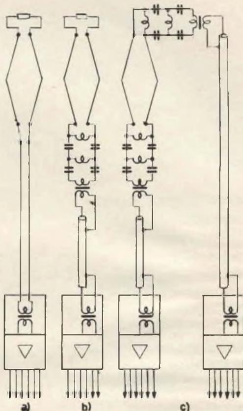
Fig. 10 - Schemi di collegamento ad un'antenna rombica del multiaccoppiatore di figura 7.
