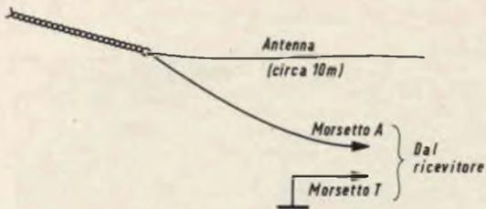
Fig. 2 - Esempio di antenna a una armatura.
