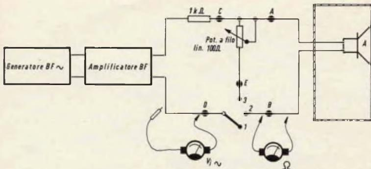
Fig. 3 - Circuito per la determinazione del fattore di qualità.
