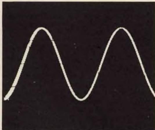
Fig. 2 - Oscillazione sinusoidale fornita dal generatore.
