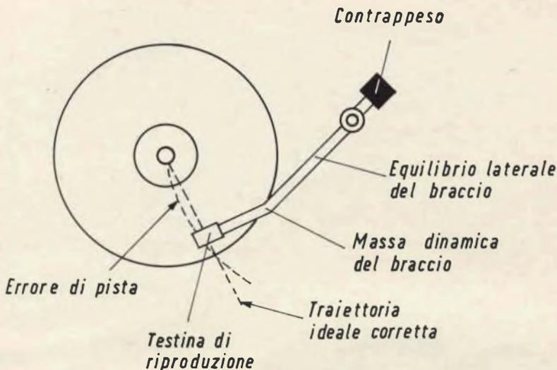
Fig. 1 - Esempio di giradischi con braccio curvo.
