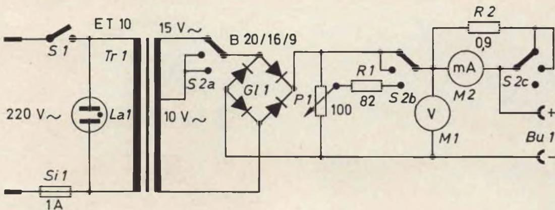
Fig. 2 - Schema elettrico del carica-accumulatori di impiego generale.
