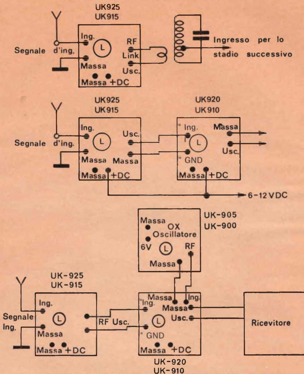
Fig. 4 - Possibilità di impiego dell'amplificatore a RF.
