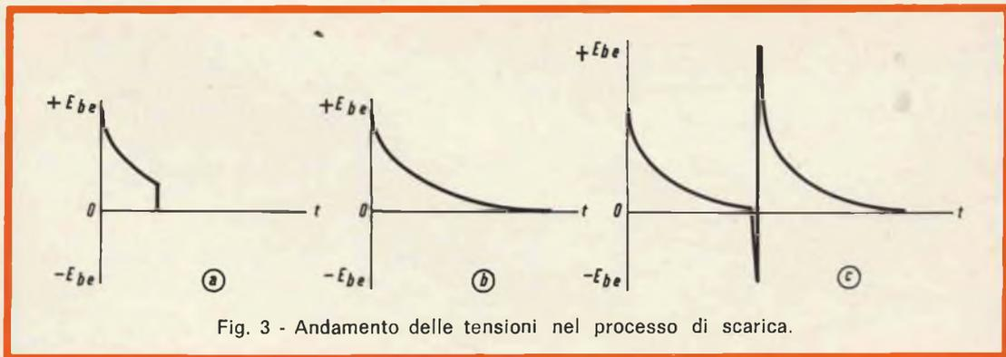
Fig. 3 - Andamento delle tensioni nel processo di scarica.
