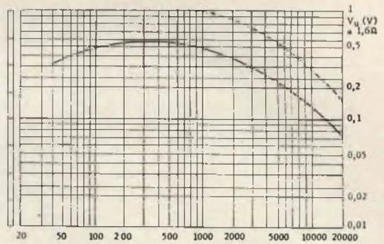
Fig. 8 - Curve di risposta globale di un ricevitore FM.  $P_o = 0,19 \text{ W}$  - 400 Hz. Deenfasi (curva tratteggiata) a  $50 \mu\text{s}$ .
