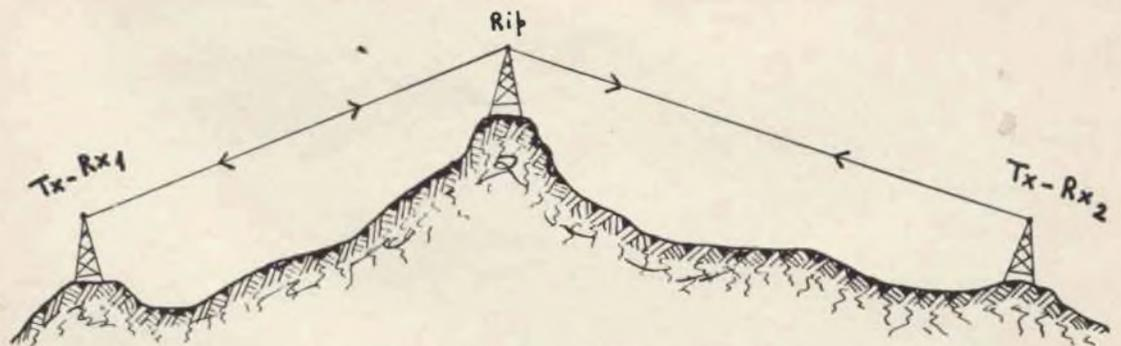
Fig. 4 - Schema pratico di un ponte radio per consentire il superamento degli ostacoli naturali.
