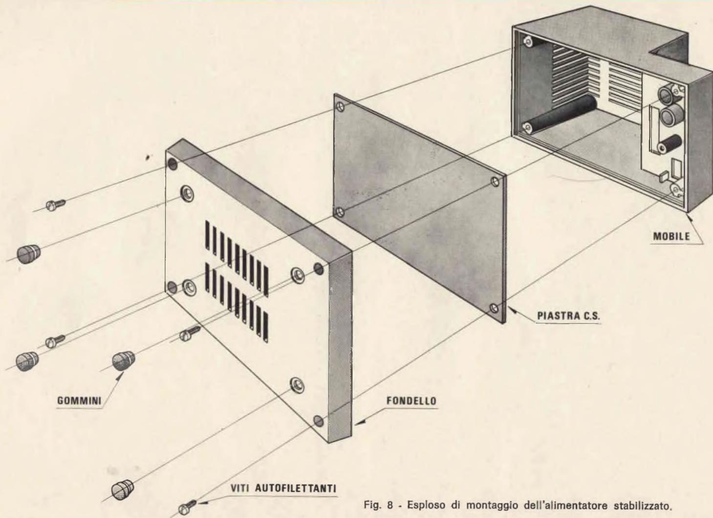
Fig. 8 - Esploso di montaggio dell'alimentatore stabilizzato.
