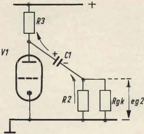
Fig. 10 - Circuito di carica del condensatore  $C_1$ .
