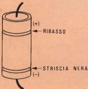
POLARITÀ DEL CONDENSATORE
