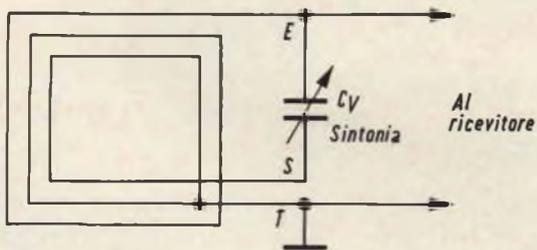
Fig. 3 a - Antenna a quadro con circuito antiparassita.
