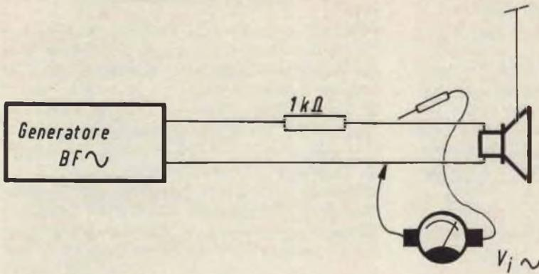
Fig. 1 - Metodo per la determinazione della frequenza di risonanza dell'altoparlante.
