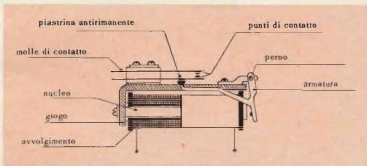
Fig. 7 - Rappresentazione schematica di un relé elettromagnetico.
