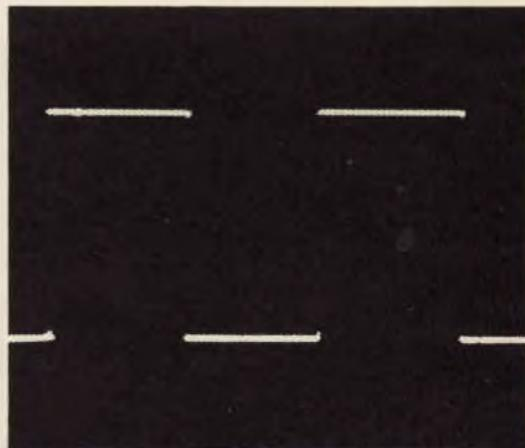
Fig. 3 - Oscillazione rettangolare fornita dal generatore.
