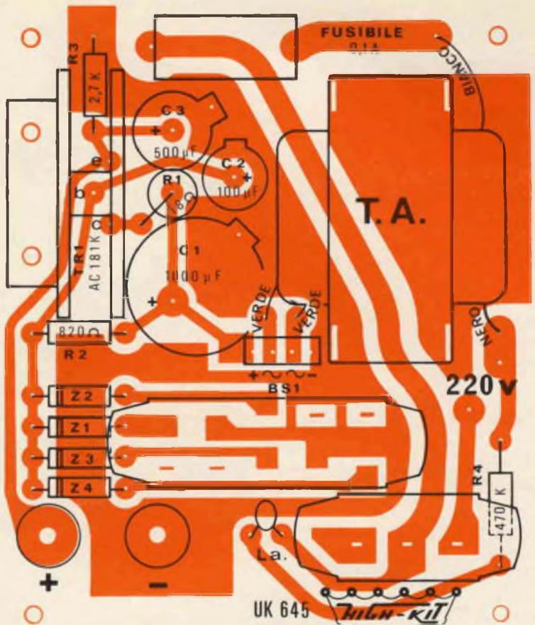
Le correnti limite di 250 mA, per la tensione di 6 V, di 200 mA, per la tensione di 7,5 V, di 170 mA, per la tensione di 9 V, e di 100 mA, per la tensione 12 V, sono più che sufficienti per le normali applicazioni dell'alimentatore.
