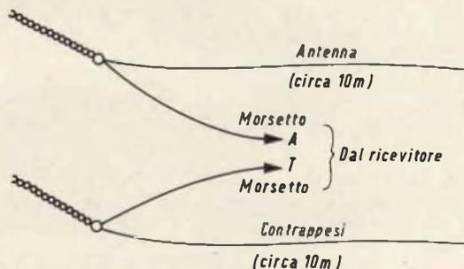
Fig. 1 - Esempio di antenna a due armature.
