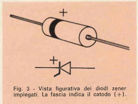
Fig. 3 - Vista figurativa dei diodi zener impiegati. La fascetta indica il catodo (+).
