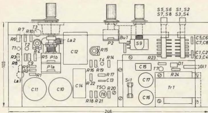
Fig. 5 - Disposizione dei componenti sulla parte frontale e sullo chassis del generatore.
