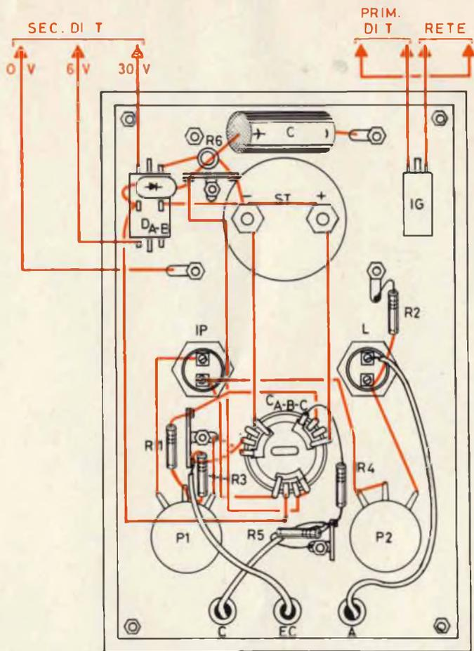
Fig. 2 - Disegno illustrante l'aspetto del pannello di comando, e la disposizione dei componenti e delle relative connessioni dal lato opposto. Il pannello deve essere di alluminio, in quanto ad esso fanno capo varie connessioni di massa.
