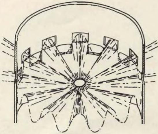
Fig. 14 - Deformazione del disco elettronico con aspetto ondulato.
