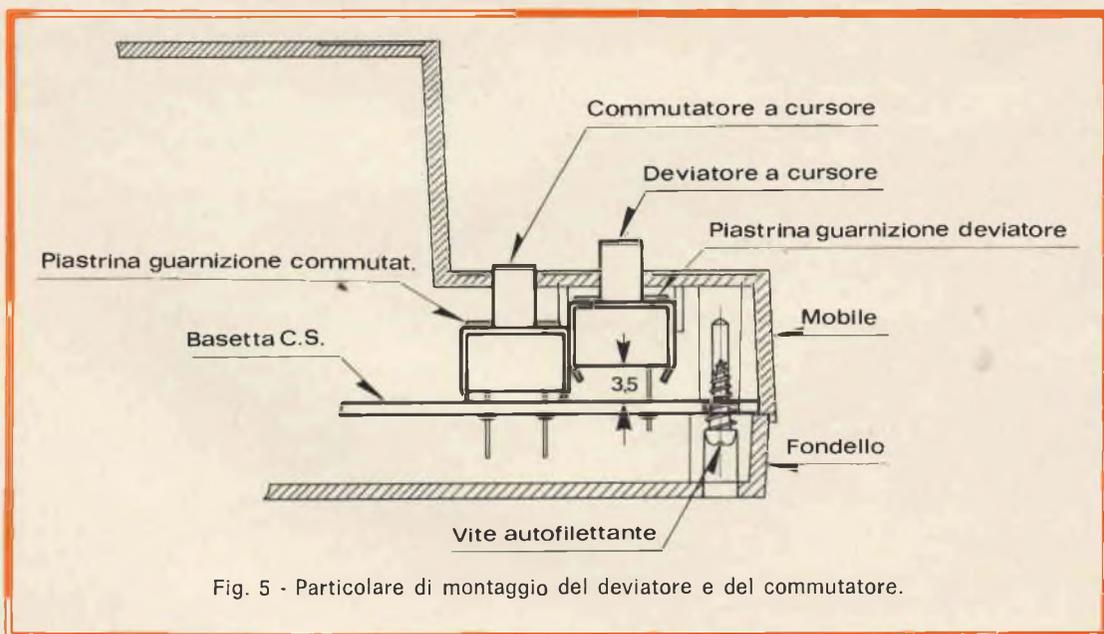
Fig. 5 - Particolare di montaggio del deviatore e del commutatore.
