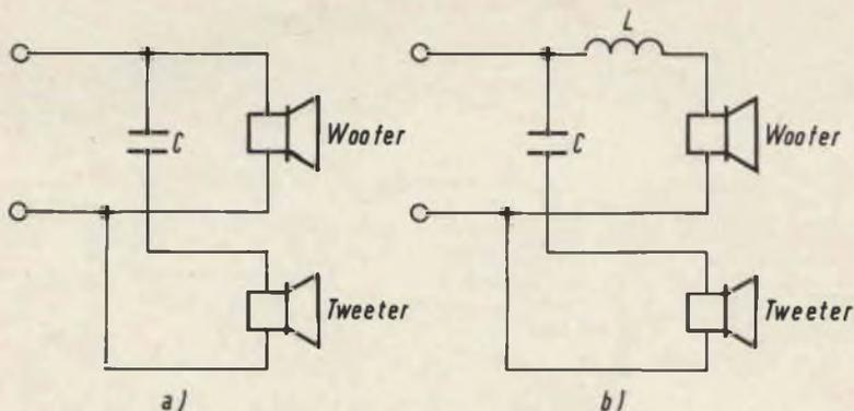
Fig. 4 - Esempi di collegamento di altoparlanti per i toni bassi e i toni alti.
