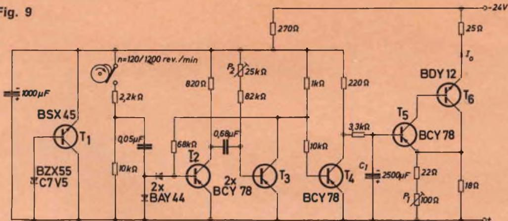
Mediante il transistor T1 viene mantenuta costante l'ampiezza dell'impulso e la tensione di alimentazione del multivibratore, con il potenziometro P2 si regola il tempo della pulsazione del multivibratore sul valore di 48 ms.
