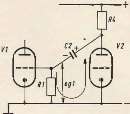
Fig. 11 - Circuito di scarica del condensatore  $C_2$ .
