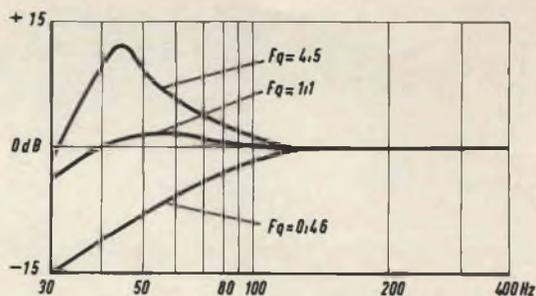
Fig. 2 - Curve del fattore di qualità.
