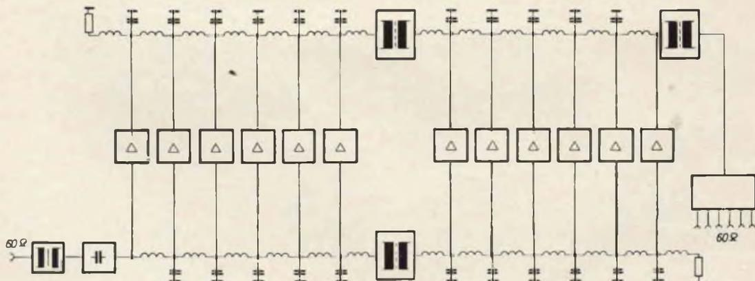
Fig. 2 - Schema di principio del multi-accoppiatore elettrico della Telefunken - V119/LW 1.
