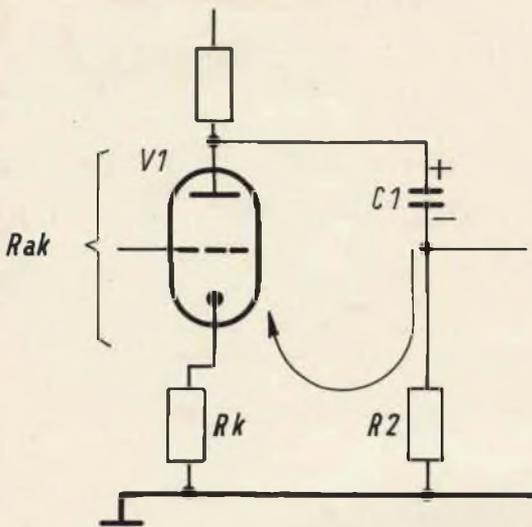
Fig. 14 - Circuito di scarica del condensatore  $C_1$ .
