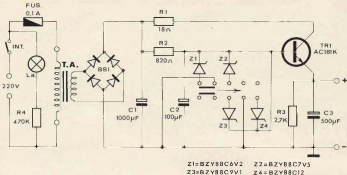
Fig. 1 - Schema elettrico.
