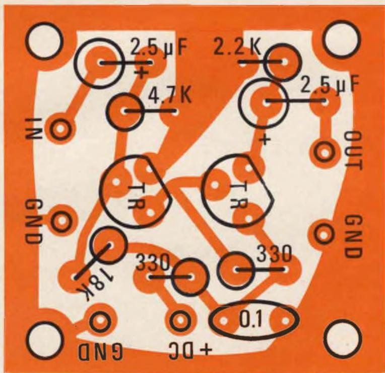
tipo 50/50 o 60/40 (G.B.C. LC/0010-00 oppure LC/0020-00), ed un saldatore la cui potenza non superi i 30 W. Quest'ultima precauzione è indispensabile allo scopo di evitare il surriscaldamento dei componenti e di conseguenza del circuito stampato.
