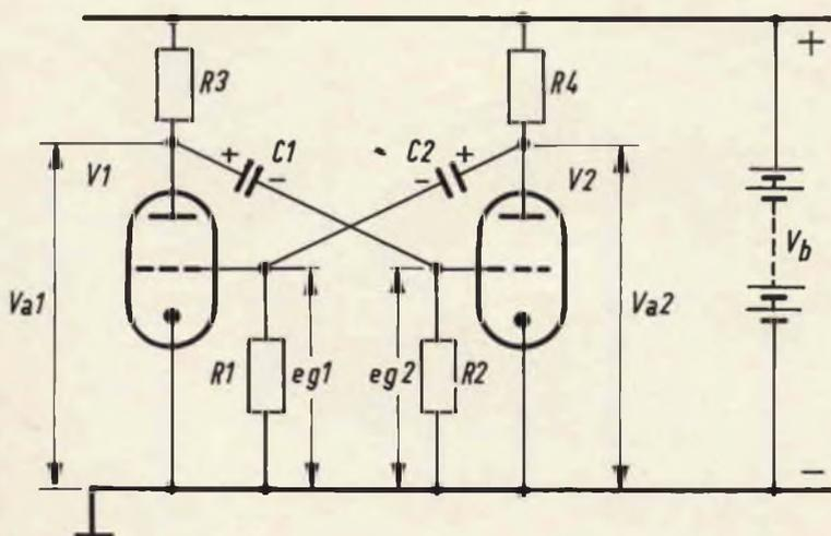
Fig. 8 - Schema elettrico di un multivibratore.
