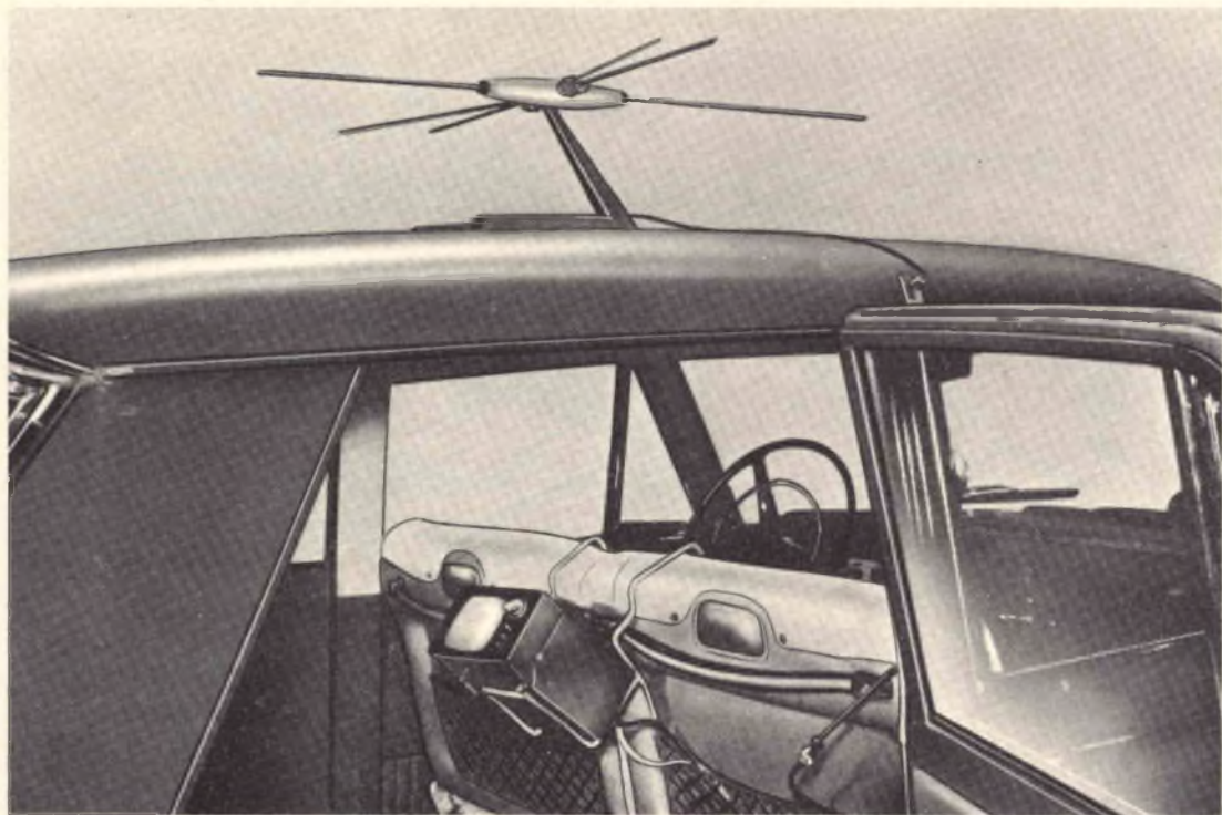
Fig. 7 - Fotografia illustrante l'antenna modello VCA-2 correttamente installata sul tetto di un'autovettura.
