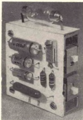
Fig. 3 - Fotografia del lampeggiatore dalla parte dove si trovano i componenti.
