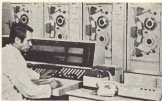
Fig. 2 - Il più potente calcolatore prodotto nella Germania Orientale è il Robotron R300, qui collegato ad un terminale di trasmissione dati.
