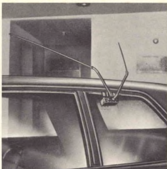
Fig. 3 - A illustra la manovra di applicazione dell'antenna a finestrino di una vettura, e B mette in evidenza la posizione che l'antenna deve avere col finestrino chiuso.
