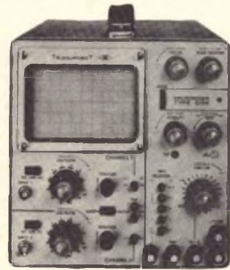
Fig. 4 - Oscilloscopio Telequipment (Silverstar) a doppia traccia completamente transistorizzato.
