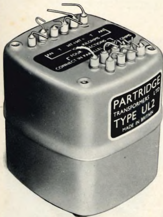
Fig. 9 - Trasformatore HI-FI Partridge per circuiti ultralinearari; potenza 50. W, risposta 30 \div 30.000 Hz \pm 0,5 dB.
