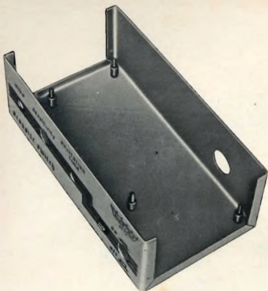
Fig. 7 - Vista del contenitore sistemato in modo da poter ricevere adeguatamente la basetta C.S.
